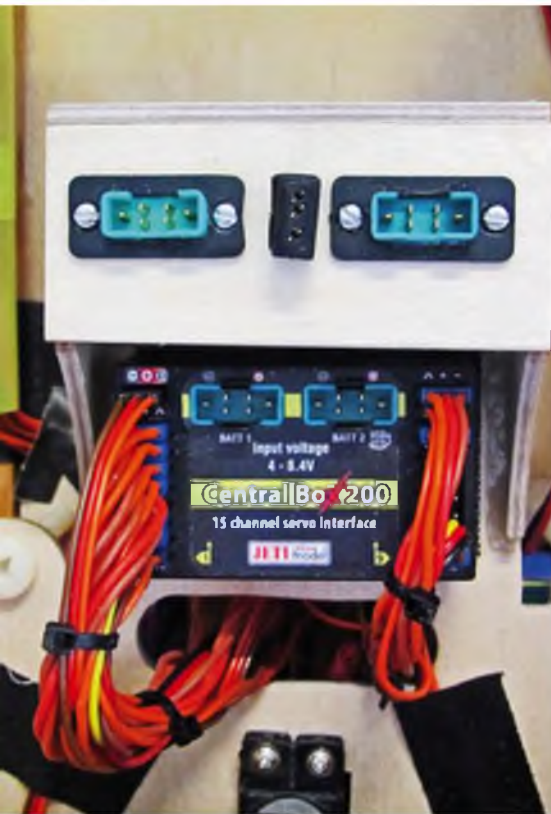
Die Central Box 200 sitzt mittig im Rumpf, alle Kabel sind sauber zusammengefasst.
