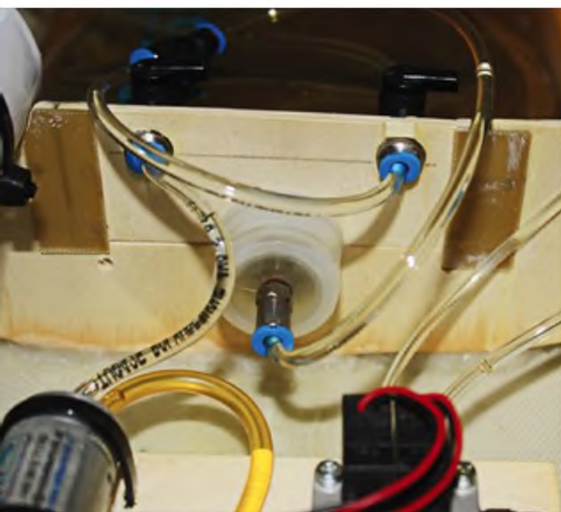
Die vordere Befestigung des Ein-Schlauch-Systems mit der originalen Verschlusskappe in einem Spannt aus 3-mm-Sperrholz.
