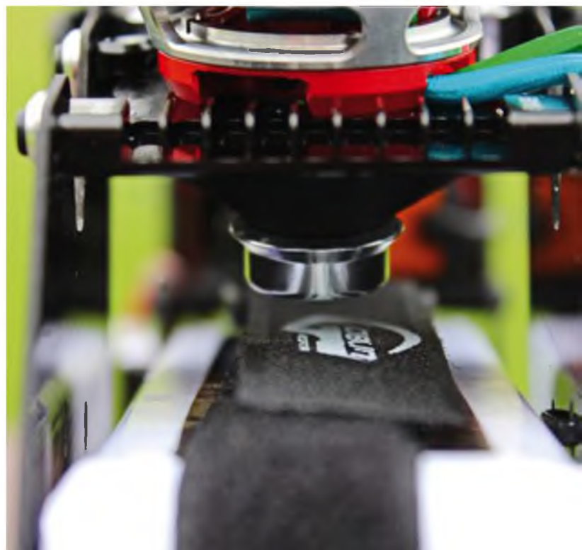
Der Regler wird unterhalb der Akkurutsche mit Kabelbindern verzurrt. Spezielle Öffnungen im Kunststoffkanal sind zur Durchführung der Kabelbinder gedacht und erleichtern die Montage.
