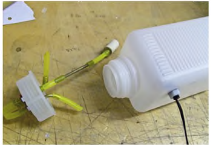
Erste Versuche mit einem handelsüblichen Schwimmerschalter brachten keinen Erfolg. Das Material war auf Dauer nicht benzinfest.
