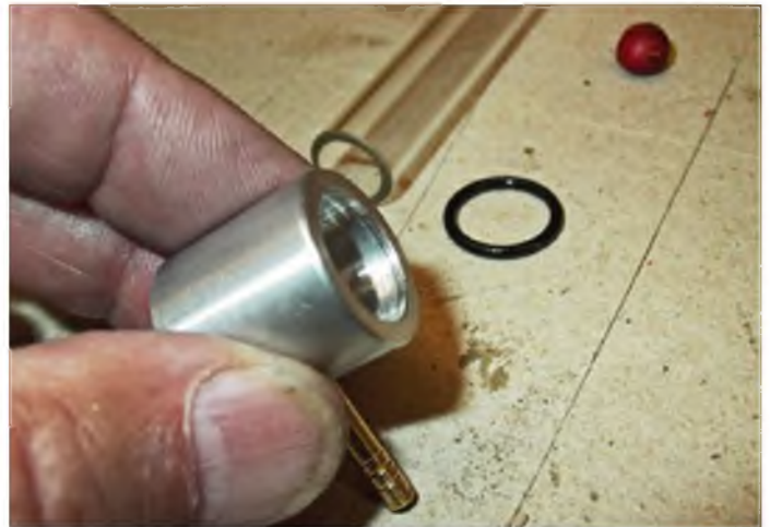
Die endgültige Lösung: Das Glasrohr wird in die Aludrehteile eingesteckt. Der als Dichtung eingesetzte O-Ring liegt in einer Nut im Drehteil.
