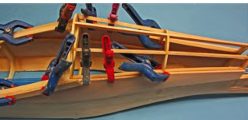
▲ Der Übergang zum Seitenleitwerk wird mit einem mehrschichtigen ausgesparten Formteil gestaltet.
