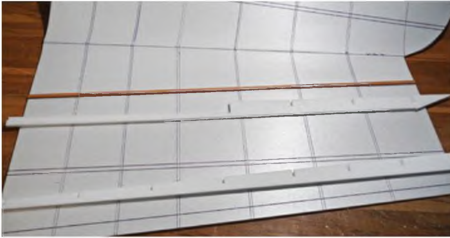
Vorbereitet zur Verklebung sind hier die Bepflankung aus 3-mm-Depron, der Holm aus 5x2-mm-Kiefer, Zwischenlage und Hilfsholm aus 6-mm-Depron.
