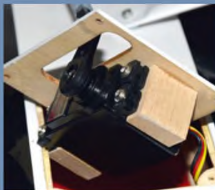
Der Servoeinbau in den Flächen ist klassisch und sehr robust.
