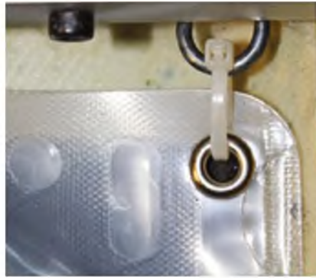
Die hintere Befestigung beim Tank von Richter: die Bohrungen in der Folie sind mit Ösen versehen.
