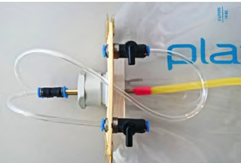
Der fertig verschlachte Richter-Tank mit Befestigungsspannt und manuellen Absperrventilen.
