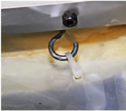
Die hintere Befestigung bei der Eigenbauvariante. Die Löcher in der Folie sind mit einem heißen Schraubendreher eingeschmolzen, Kabelbinder und Schraubhaken dienen zur Befestigung am Spant des Hauptholms.
