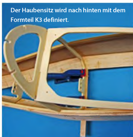
Die Spanten werden positioniert – gut zu erkennen ist die Profil-Form des HLW.
