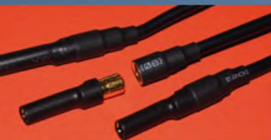
Wer nicht löten will: Es gibt passende Adapter für die Verbindung zum Motor.
