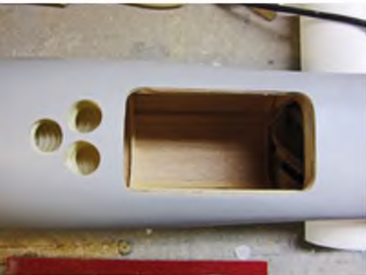
Die Lufteintrittsflächen der drei Motorbelüftungsrohre und für die Regler wird später mit je einer Hutze verkleidet.
