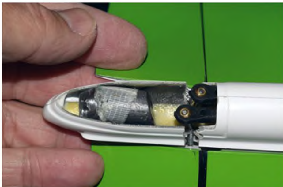
In den hinteren Rumpfbereich passen gut 40 g Blei rein.
