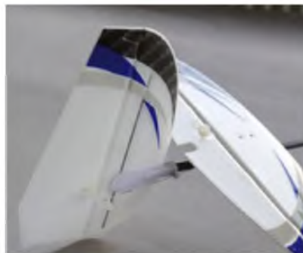
Fit für den Schleuderstart. Wie das Höhenleitwerk ist auch die Seitenruderflosse CFK-verstärkt.
