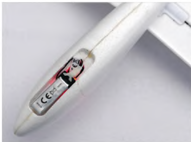
Auf der Unterseite der Rumpfspitze hat der Akku seinen Platz. Er muss ganz nach vorne, damit der Schwerpunkt stimmt.
