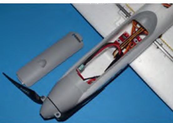
Die Rumpfföffnung ist nicht wie üblich oben, sondern unten. Die Klappe wird einfach angesetzt und rastet dann durch einen kurzen Druck ein.
