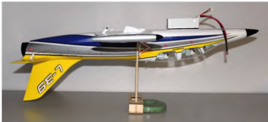
Der Schwerpunkt wird mit der Position des Antriebsakkus eingestellt. Dabei empfiehlt sich das Auswiegen auf dem Rücken.
