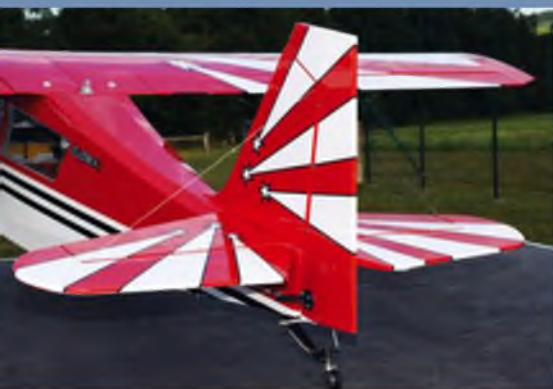
Die Verspannung der Leitwerke ist vorbildähnlich aber nicht tragend.
