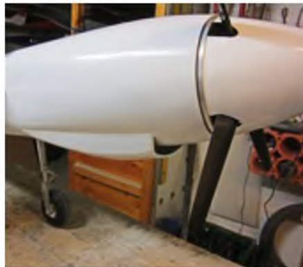
Die Lufteintrittsflächen der drei Motorbelüftungsrohre und für die Regler wird später mit je einer Hutze verkleidet.
