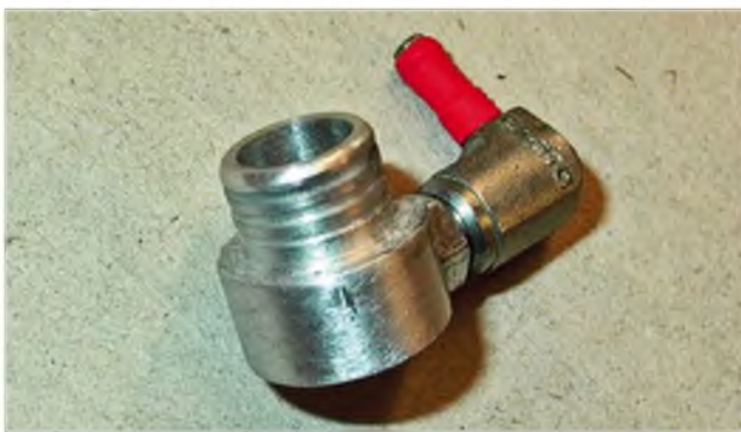
Erste Versuche mit einem handelsüblichen Schwimmerschalter brachten keinen Erfolg. Das Material war auf Dauer nicht benzinfest.
