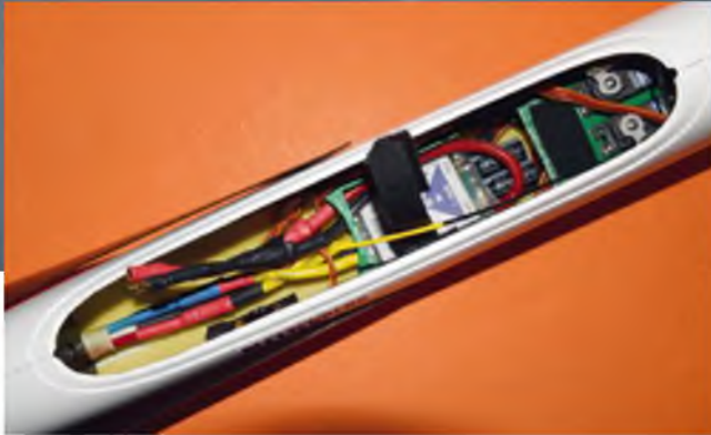
So sieht mein Rumpfausbau ohne Akku aus. Der Regler liegt flach am Boden des Rumpfes.
