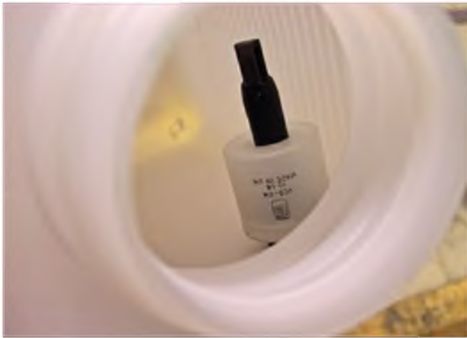
Erste Versuche mit einem handelsüblichen Schwimmerschalter brachten keinen Erfolg. Das Material war auf Dauer nicht benzinfest.
