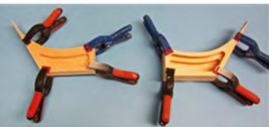
▲ Der Übergang zum Seitenleitwerk wird mit einem mehrschichtigen ausgesparten Formteil gestaltet.
