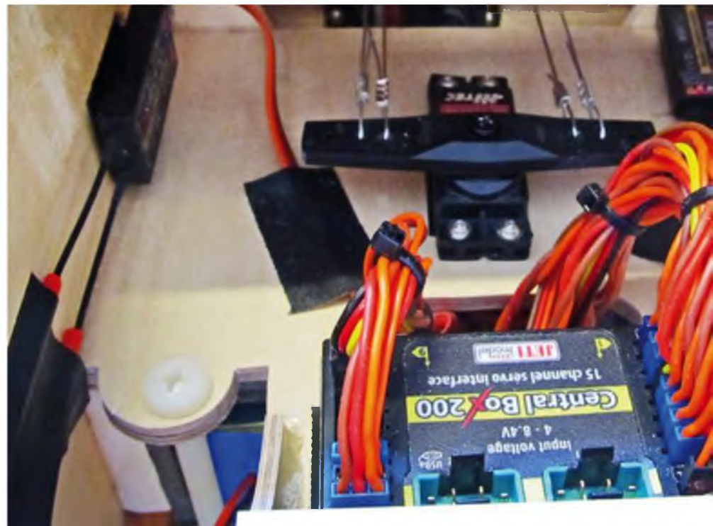
Die Central Box 200 sitzt mittig im Rumpf, alle Kabel sind sauber zusammengefasst.
