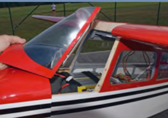
Ein Segen – die abnehmbare Frontscheibe gewährt einen komfortablen Zugang zum Akku.
