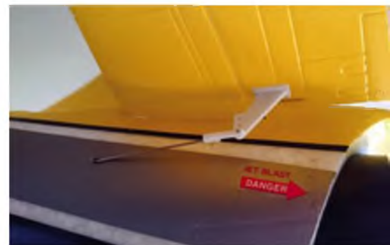
Die Ruderausschläge sind durch mehrere Bohrungen mechanisch anpassbar. Hier: die Anlenkung des Höhenruders.
