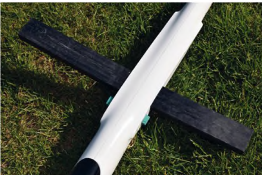
Ziemlich massiv ist der CFK-Flächenverbinder. Der hält was aus.
