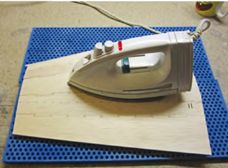
Die Matten bieten nicht nur Oberflächen-Schutz, sie geben den Bauteilen auch Halt auf der Arbeitsfläche.
