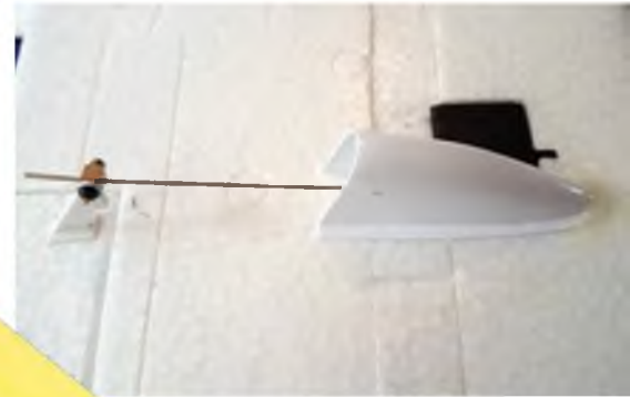
Die untenliegenden Anlenkungen der Querruder werden bei der Landung von Kunststoffkappen geschützt.
