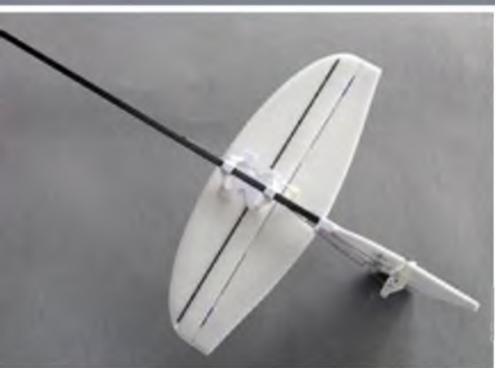
Die feinen Drähtchen zur Ruderanlenkung sind gut geschützt innerhalb des hohlen CFK-Vierkant-Heckauslegers verlegt.
