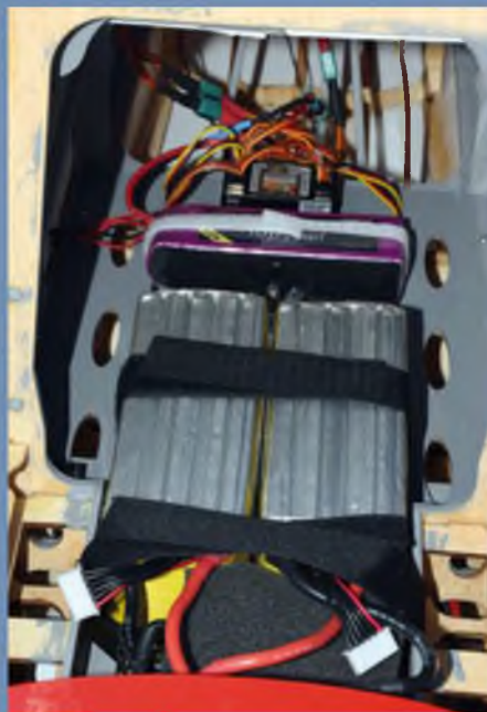
Der Akkupack muss etwas weiter nach hinten als gedacht. Dafür hat Great Planes aber schon ein zusätzliches Akkubrett beigelegt.
