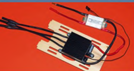
Der Regler hat ein eigenes Befestigungsbrettchen. Ein Sicherheits-Magnetschalter von Emcotec ist bei solch großen Modellen immer empfehlenswert.
