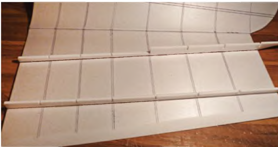
Das 10-mm-CFK-Rohr wird durch die Rippen gefädelt und mit 5-Minuten-Epoxid eingeklebt.
