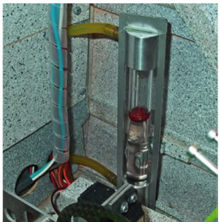
Die endgültige Lösung: Das Glasrohr wird in die Aludrehteile eingesteckt. Der als Dichtung eingesetzte O-Ring liegt in einer Nut im Drehteil.
