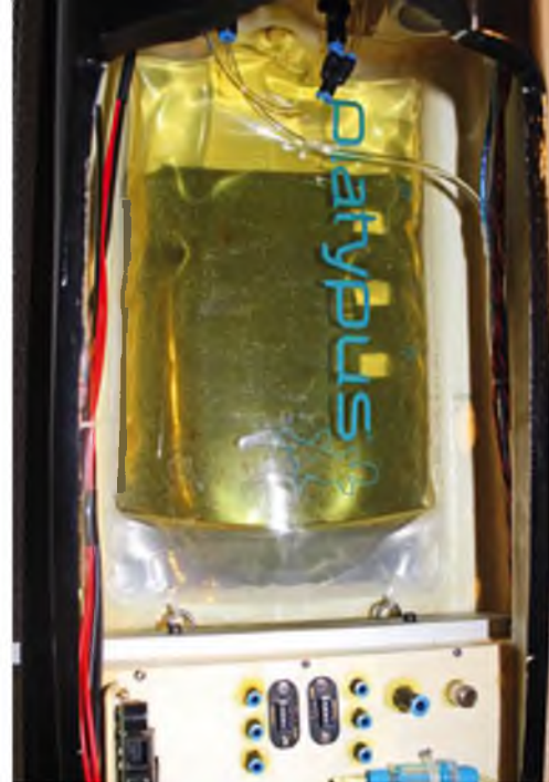
Der fertig eingebaute und betankte Platypus-Beutel in der Einschlauch-Variante. Wie man sieht sind keine Luftblasen im System.
