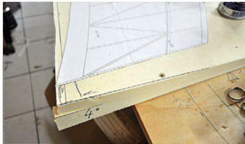
Die Schränkungs-Helling für das Mittelteil: eine 20-mm-Hartschaumplatte wird an einer Seite mit einem 4°-Keil versehen.
