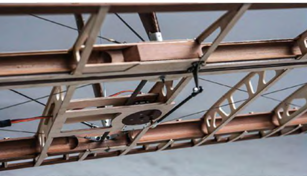
Die Querruderanlenkung im Detail
