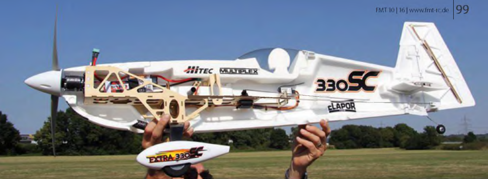
Das Schnittmodell zeigt die den Rumpf versteifende M-Frame-Konstruktion aus Sperrholz, die die Kräfte aufnimmt und ebenso Akku und Servos beherbergt.
