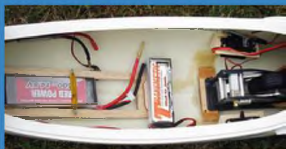
Der große Antriebsakku verbleibt auch in der Seglerversion aus Gewichtsgründen im Rumpf. Der Empfängerstrom kommt aus einem 3s-LiPo mit 2.200 mAh.
