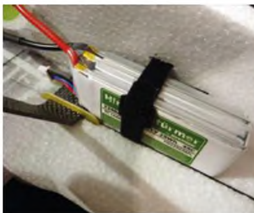
Den Flugakku habe ich zusätzlich mit einer Klett-Sicherungsglasche gesichert, die auf der Rückseite einen kleinen Streifen CFK bekommen hat.
