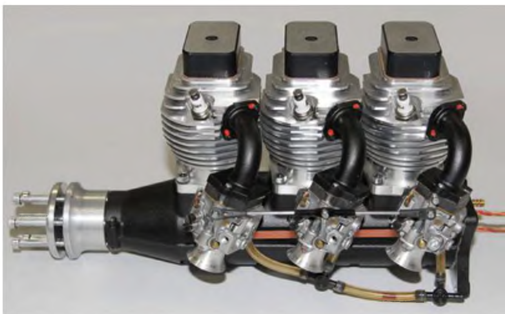
Der RM 130 verfügt über drei einzelne Walbro-Vergaser vom Typ WT 962, die Drossel-Klappen sind bereits miteinander verbunden.
