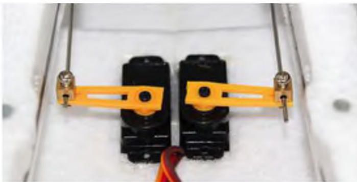
Die Servos für Höhe und Seite sind im Rumpf verbaut und über Bowdenzüge mit den Rudern verbunden.
