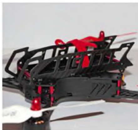
Auf dem Oberdeck des Copters findet der Akku durch ein Schlaufenband gesichert seinen Platz. Geschützt ist er durch die zwei Seitenplatten.
