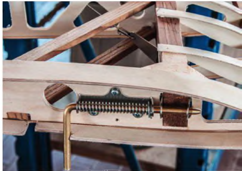
Detail der oberen Flächenbefestigung: Mittels Beschlägen an den Holmen der Fläche und federbelasteten Stiften werden die Holme verbunden – die Spanndrähte sind tragend ausgeführt.
