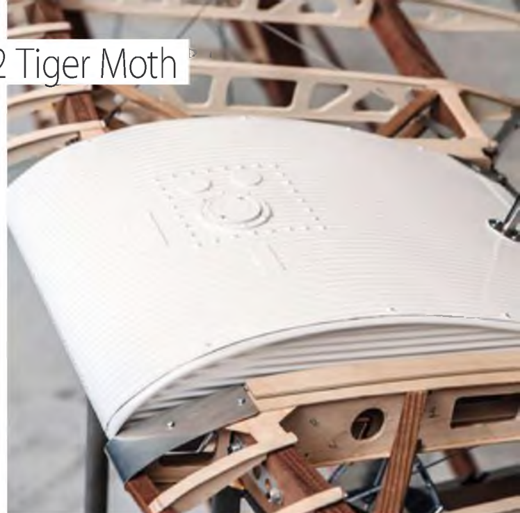
Der markante Tank des Originals ist am Modell aus GFK gefertigt.
