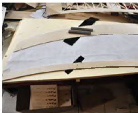
Beginn des Flügelbaus: Beplankung und Endleiste werden schräg geschäftet.
