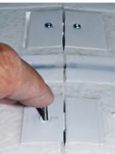
Je drei Schrauben sichern jedes Ohr am Tragflächen-Mittelstück.
