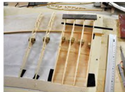
Aufbau Mittelstück: Der Holm wird gewässert und unter Heißluft vorgebogen.
