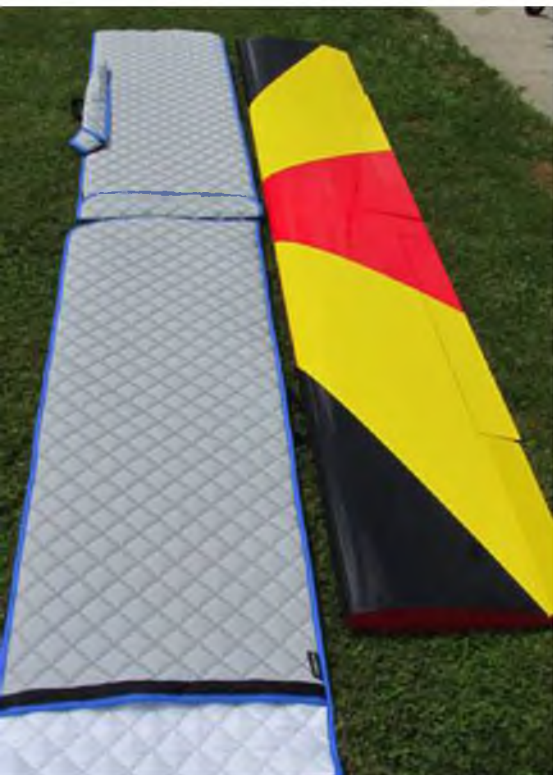
Das Oberflächenmaterial der Schutztaschen greift sich wie Nylon und ist wasserabweisend.
