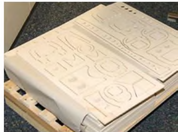
Markus zeichnete per CAD die Spanten für das Holzgerüst, die Peter anschließend auf einer CNC-Fräse erstellte.
