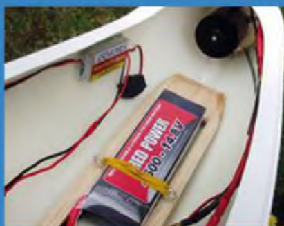
Statt einer Bleizugabe habe ich einen Nasenantrieb von Hacker (A 40 L Glider) eingebaut.
