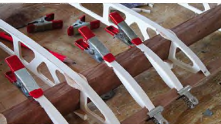
Flächenaufbau: Rippen und Aufleimer
