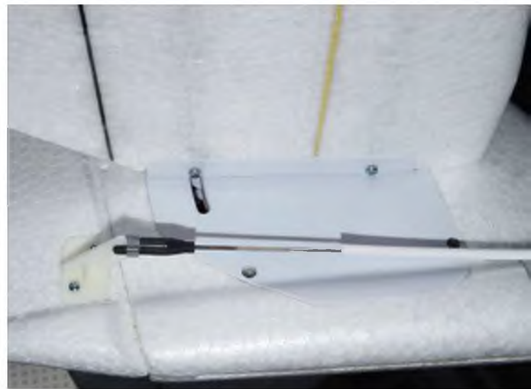
Die beiden Pendelhöhenleitwerkshälften sitzen richtig satt am Rumpf. Sie sind beidseitig mit je zwei Schrauben gesichert.
