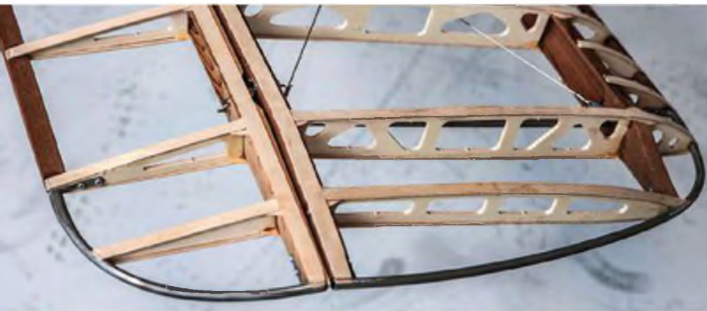
Die Tragflächen-Randbögen sind aus Edelstahlrohr gebogen.
