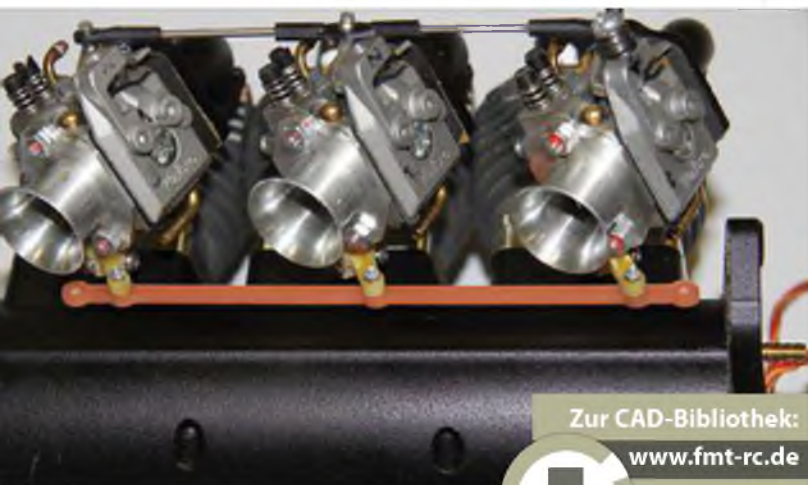
Die Choke-Klappen wurden mit einer GFK-Schubstange verbunden.
