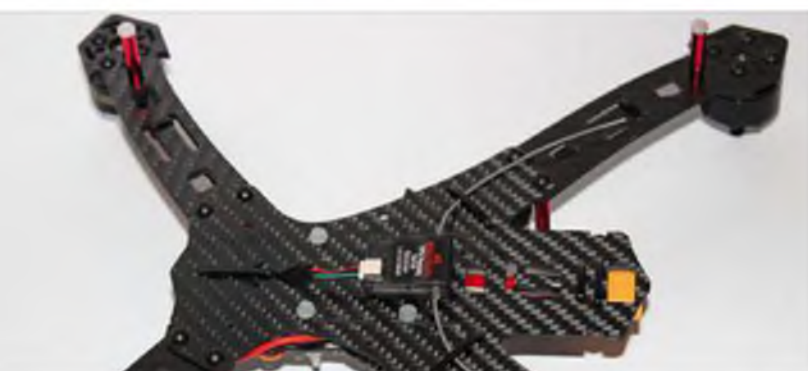
Der Satellitenempfänger wurde mit Spiegeltape auf der Unterseite des Copters befestigt. Dank seiner Aluminium-Standfüße ist der Alpha 300Q auch bei der Landung gut geschützt.
