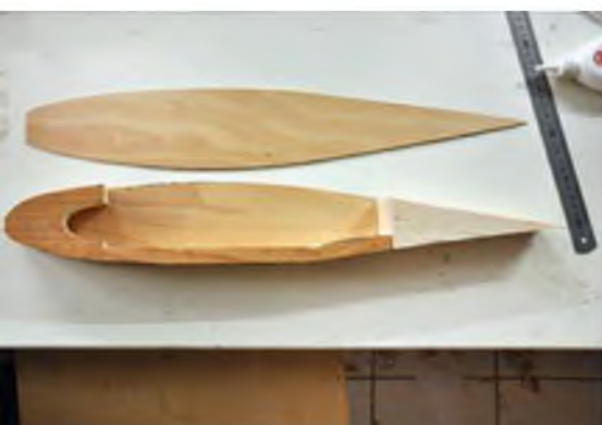
Der Rumpfboden und -kopf wird aus Fichte gefertigt, die Seitenteile aus Sperrholz.
