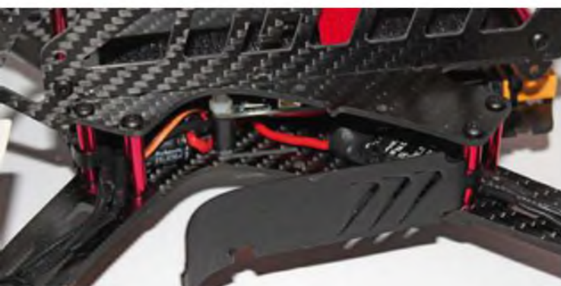
Auf dem Oberdeck des Copters findet der Akku durch ein Schlaufenband gesichert seinen Platz. Geschützt ist er durch die zwei Seitenplatten.
