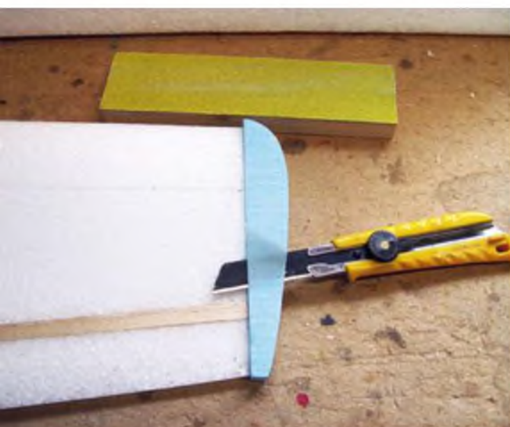
Die Randbogen entstehen aus Styrofoam und haben einen Überzug mit Laminierharz, angereichert mit Mikrobällons.
