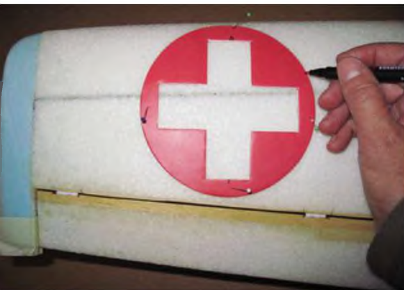
◀ Die Konturen der Farbflächen zeichnet man mittels Lehren aus Balsa- oder Depron-Streifen mit Hilfe eines wasserfesten Filzschreibers auf.
