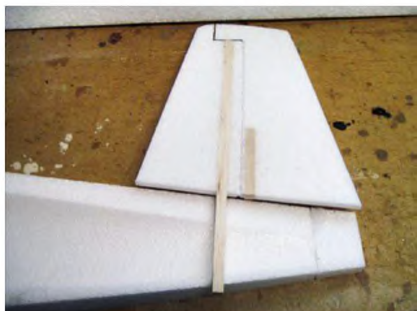
Die Leitwerke bestehen weitgehend aus 10 mm dicken EPP-Platten und sind mit eingepassten 10-mm-Balsaleisten verstärkt.
