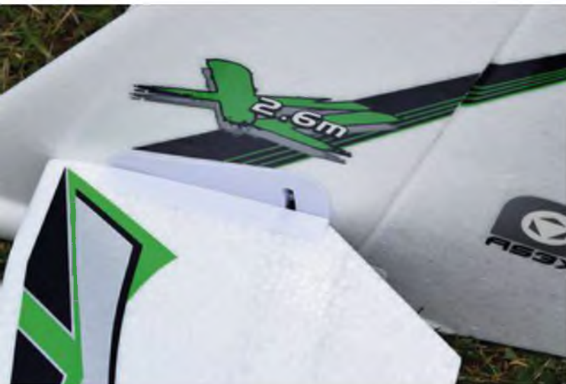
Die beiden Pendelhöhenleitwerkshälften sitzen richtig satt am Rumpf. Sie sind beidseitig mit je zwei Schrauben gesichert.
