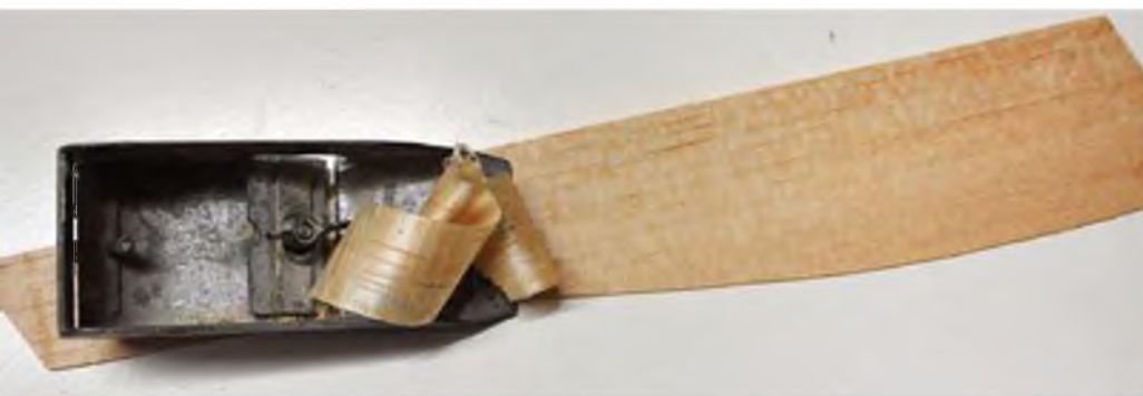
Die Querruder werden aus quarter-grain-Balsa gehobelt.
