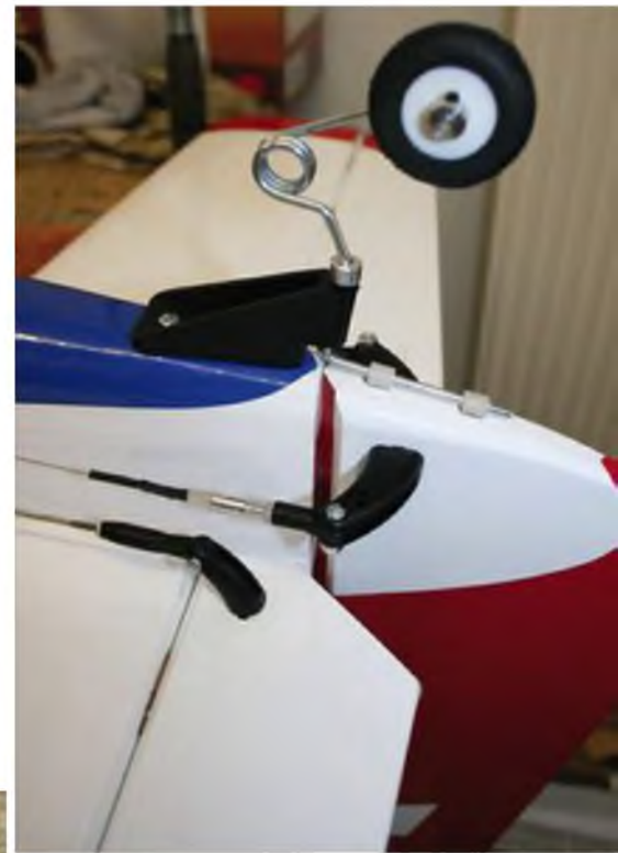
Der Sporn wirkt etwas grob, ist aber praxistauglich und stabil. Gleiches gilt für die Ruderhörner.
