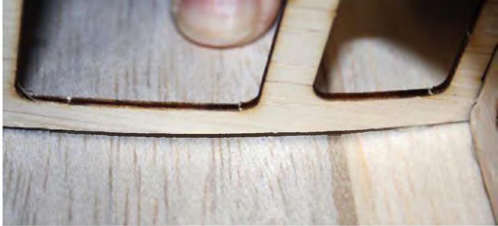
Die Rippen der Tragflächen waren im Fahrwerksbereich nicht ausreichend verklebt und mussten nachgeleimt werden.
