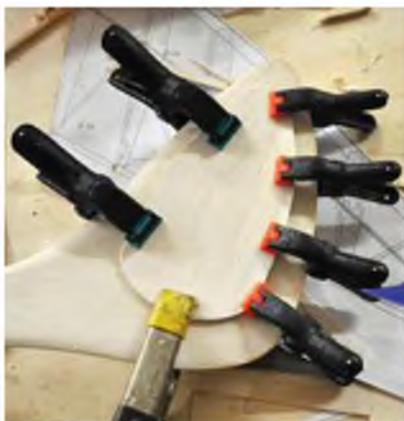
Verleimen der Seitenflossenteile – eine Aufdickung am Leitwerk bringt etwas mehr Profilierung.
