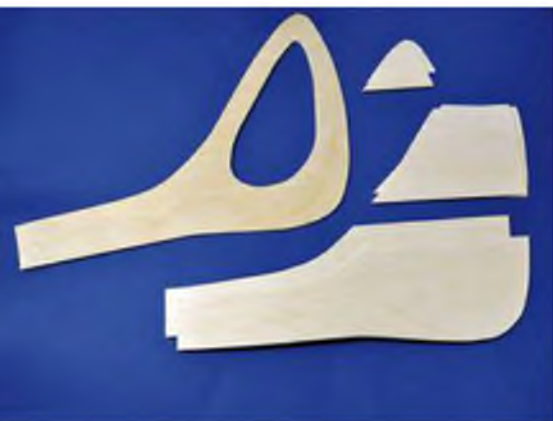
Die Teile für die Seitenflosse: Kern ist ein 3-mm-Sperrholzteil, das beidseitig mit 2-mm-Balsa beplankt wird.
