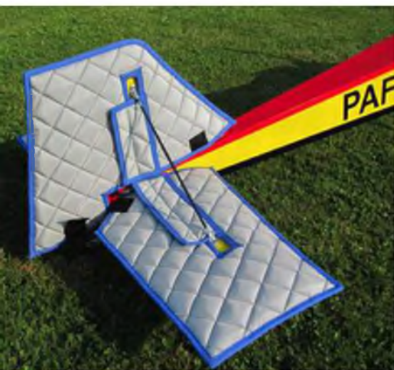
Bei den Leitwerksschutztaschen sieht man das ganze Knowhow: Durch die Streben müssen verschleißbare Schlitze eingearbeitet werden.
