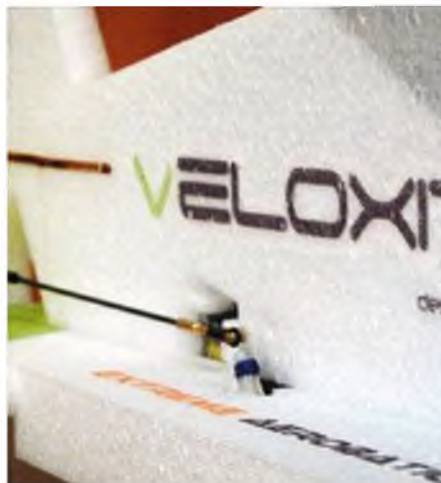
Dem Bausatz liegen sauber gefräste Anlenkungsteile sowie Servohorn-Verlängerungen bei. Damit sind 3D-taugliche 45 Grad Anstellwinkel möglich.
