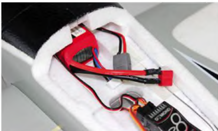
Mit einem 3s-LiPo-Flugakku mit 2.200 mAh sind Flugzeiten von bis zu acht Minuten möglich.
