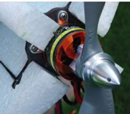
Heftig motorisiert ist der Velocity mit dem „XL“-Antriebsset, also einem Torcster 3536/8. Ideale Luftschraube dafür: aero-naut Cam Light 12x5“.
