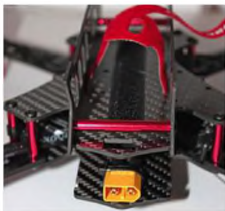
Die XT60-Buchse wird auf der Bodenplatte des Copters mit Kabelbinder festgezurt. Der Akkuwechsel ist dank der offenen Bauart sehr einfach.
