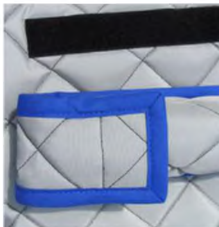
Die Verarbeitungsqualität der Flächenschutztaschen zeigt sich besonders in den kleinen Details: Die Schutztasche für das Steckungsrohr ist mit Klettband auf einer Tragflächentasche befestigt
