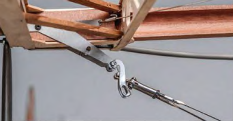
Um die tragenden Spanndrähte beim Auf- und Abbau schnell entlasten und spannen zu können, sind sie mit Schnellspannern ausgestattet.
