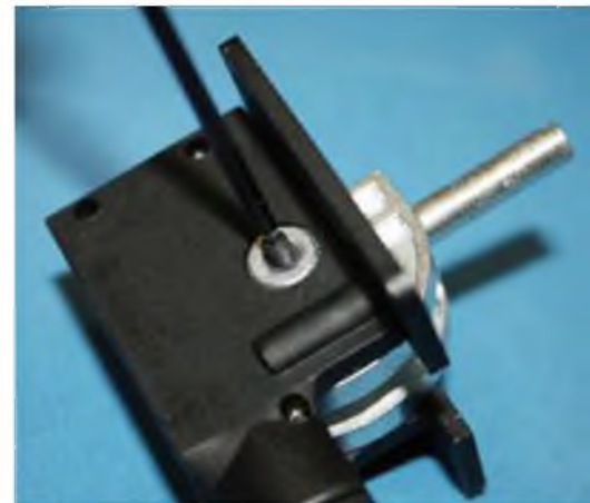
Clever gelöste Gewindebohrung in der Drehachse der Fahrwerksmechanik.
