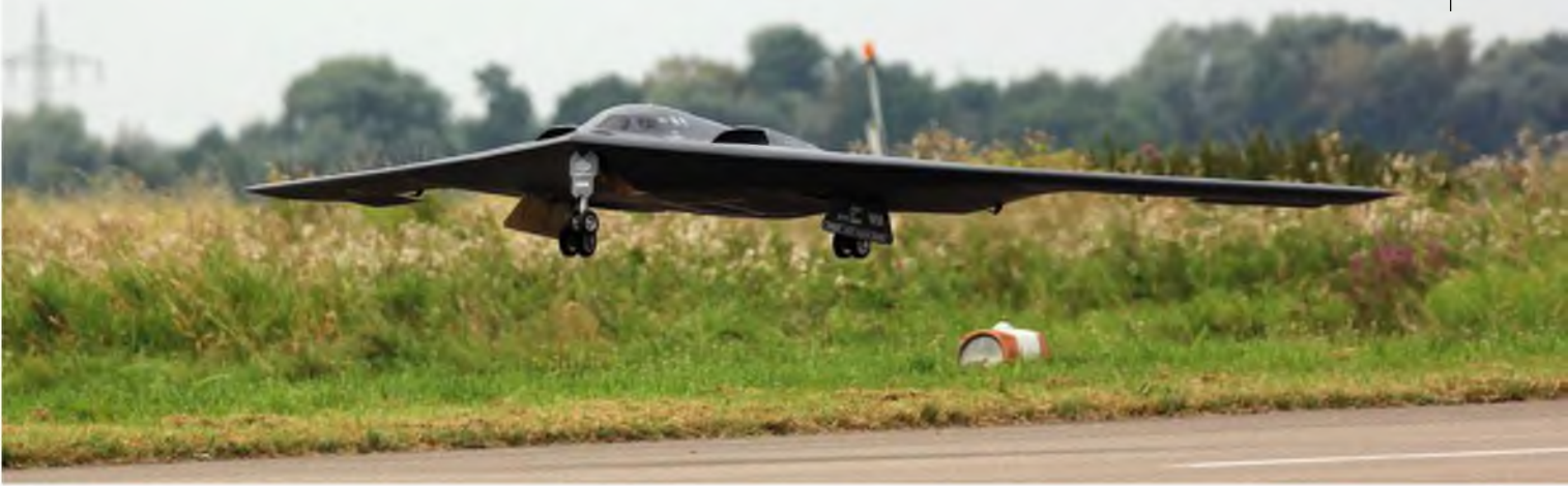
Andreas Gietz von CARF-Models brachte eine Neuheit an den Start: Die Northrop B-2 Spirit mit 4,35 m Spannweite und zwei Turbinen mit je 100 N Schub.
