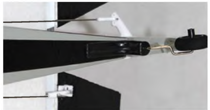
Die Servos für Höhe und Seite sind im Rumpf verbaut und über Bowdenzüge mit den Rudern verbunden.
