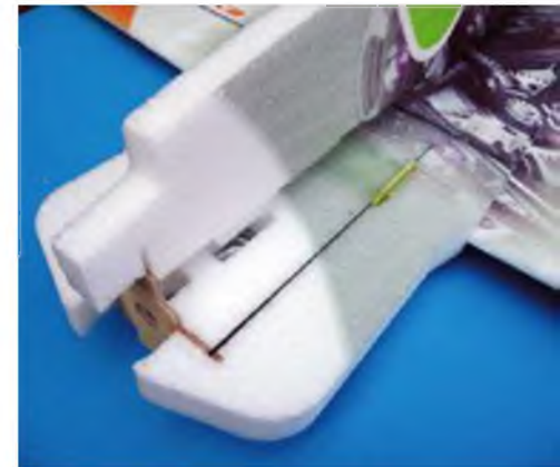
Shocky-like ist die Kreuzrumpfkonstruktion, die jedoch in diesem Fall aus robustem und outdoortauglichem 20-mm-EPP besteht.
