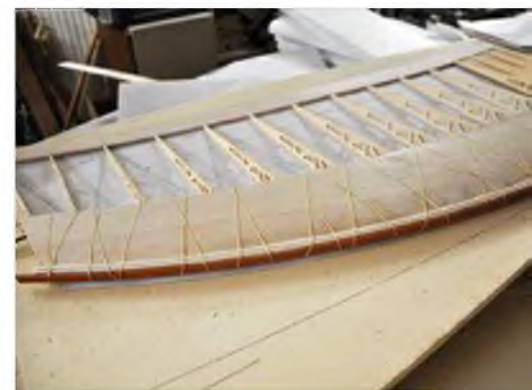
Die Oberseitenbeplankung und die Nasenleiste werden mit einem dünnen Gummiband fixiert.
