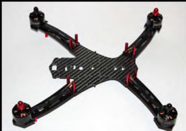
Der Aufbau geht dank wenigen Einzelteilen zügig vonstatten. Auf der Grundplatte kann die Fluglagensteuerung oder das PDB-Board verschraubt werden.
