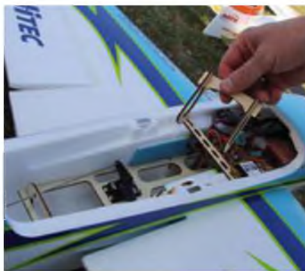
Das Schnittmodell zeigt die den Rumpf versteifende M-Frame-Konstruktion aus Sperrholz, die die Kräfte aufnimmt und ebenso Akku und Servos beherbergt.
