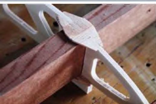
Flächenaufbau: Rippen und Aufleimer
