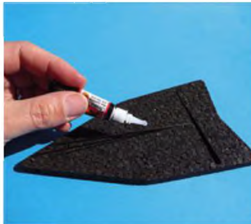
Selbst die Winglets haben bereits fertig abgelängte CFK-Verstärkungen.
