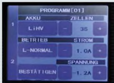
Im Lade-Menü haben sich in der deutschen Version Fehler eingeschlichen: Im unteren Feld wird nicht die Spannung eingestellt, sondern der Entladestrom.
