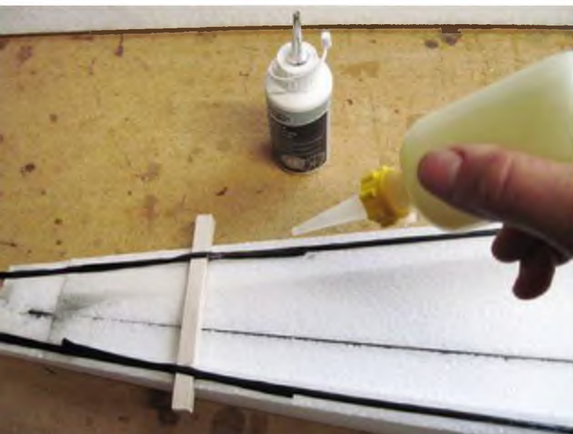
Der Rumpf hinter dem Holzgestell besteht aus zwei EPP-Halbschalen, die oben und unten mit CFK-Roving und seitwärts mit CFK-Flachprofilen verstärkt sind.
