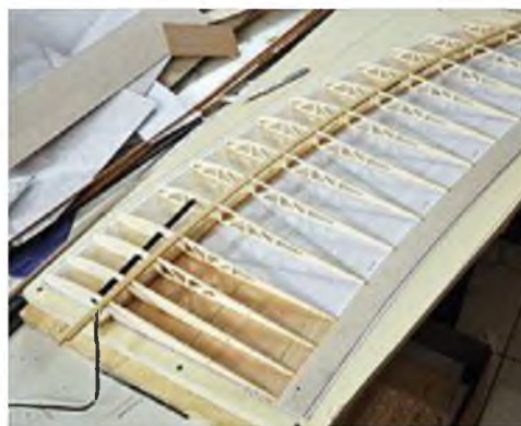
Das Mittelteil noch ohne Beplankung, die Servokabel sind bereits eingezogen.
