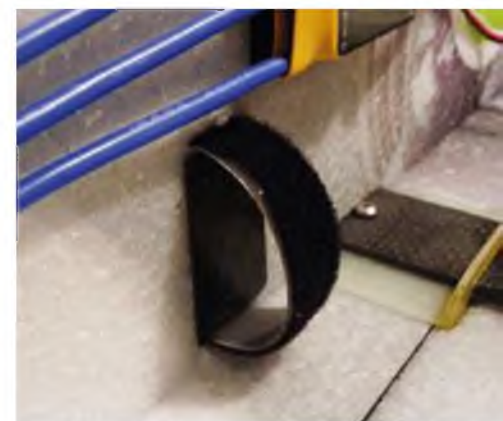
Den Flugakku habe ich zusätzlich mit einer Klett-Sicherungsglasche gesichert, die auf der Rückseite einen kleinen Streifen CFK bekommen hat.
