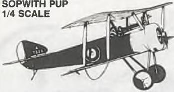
Spannweite 1 950 mm, Motor 20-40 ccm
