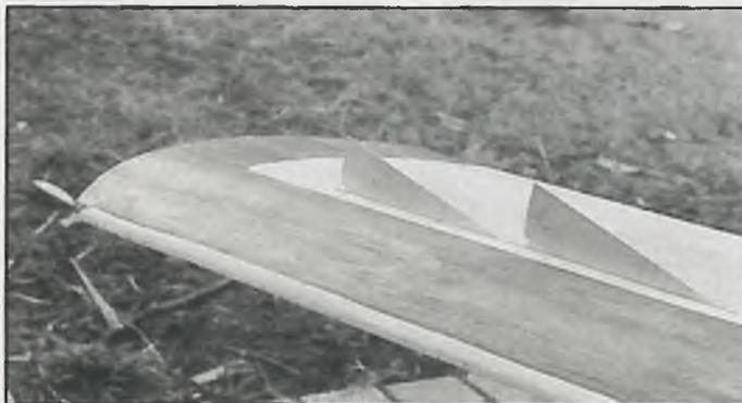
lere Bewegungen macht. Inzwischen hatte ich auch Solarzellen, um bei Sonnenschein ein Aufladen der Batterien zu gewährleisten. Ich hatte außerdem noch durch zusätzliche Flügellenden die Spannweite auf 4,40 m vergrößert. Bei doppelter V-Form blieb das Modell relativ stabil, reagierte aber ausreichend auf Ruderausschläge auch ohne Querruder. Die zusätzlichen Flügellenden paßten noch in die Transportkiste und 1986 war es endlich wieder soweit.
