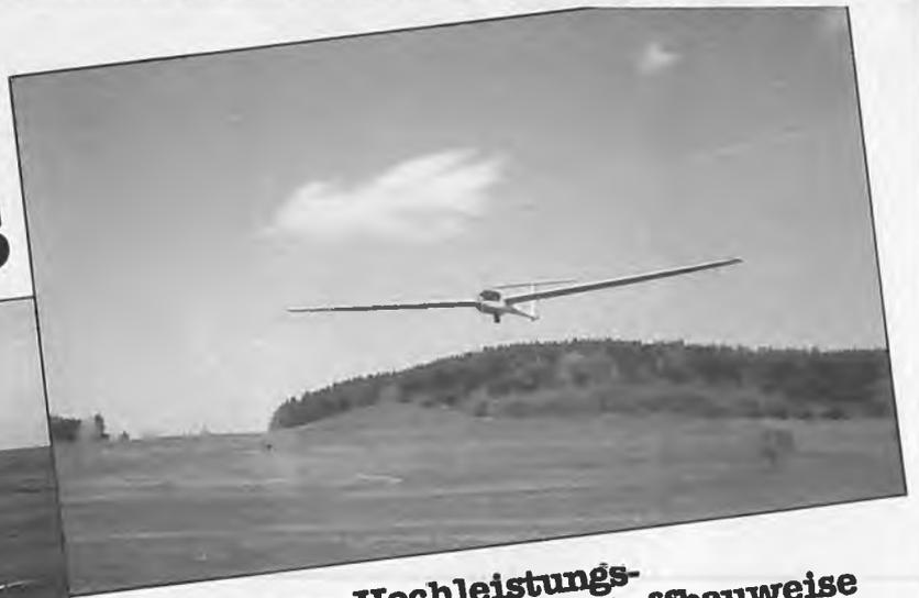
**Flugfertiges Hochleistungssegelflugmodell in Kunststoffbauweise**
