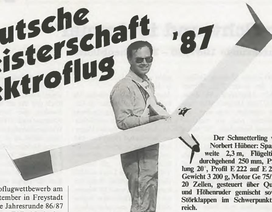
Der Schmetterling von Norbert Hübner: Spannweite 2,3 m, Flügeltiefe durchgehend 250 mm, Pfeilung 20°, Profil E 222 auf E 230, Gewicht 3 200 g, Motor Ge 75/28, 20 Zellen, gesteuert über Quer- und Höhenruder gemischt sowie Störklappen im Schwerpunktbereich.
