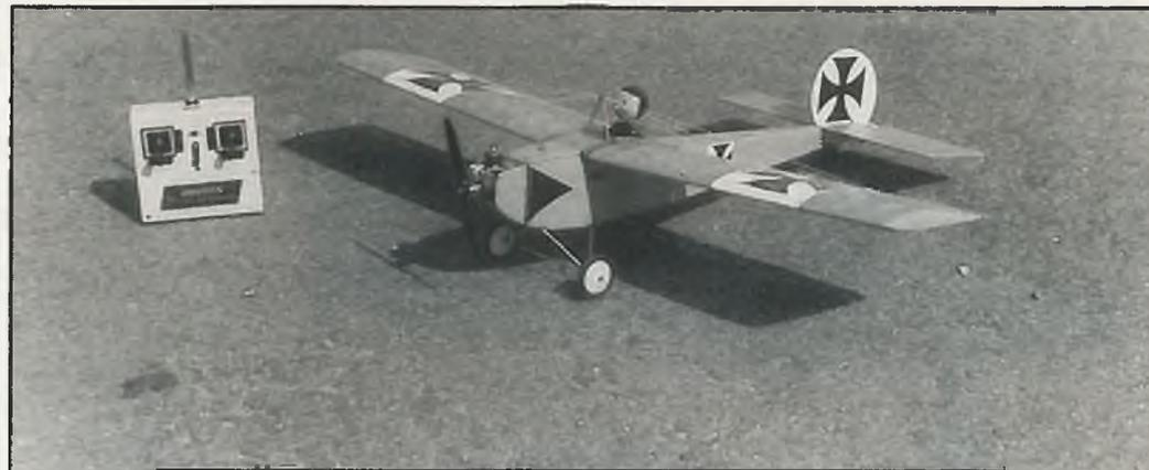
Der Miniflieger und die Minianlage. Die amerikanische „Cannon“ ist vermutlich die kleinste Fernsteuerung der Welt und wird daher auch in Modellraketen und speziellen Saalflugmodellen verwendet. (In der BRD wird diese Anlage von ESE/Carstens, 2359 Hasenmoor vertrieben.) Doch mittlerweile gibt es mehrere andere Kleinstempfänger auf dem Markt und das Angebot an Mikroservos ist auch relativ groß.
