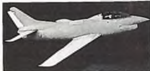
Das Modell passend zum Triebwerk: FIAT G-91 in Super-Scale-Ausführung. Spw. 165 cm, 5,3-5,7 kg Fluggew.
