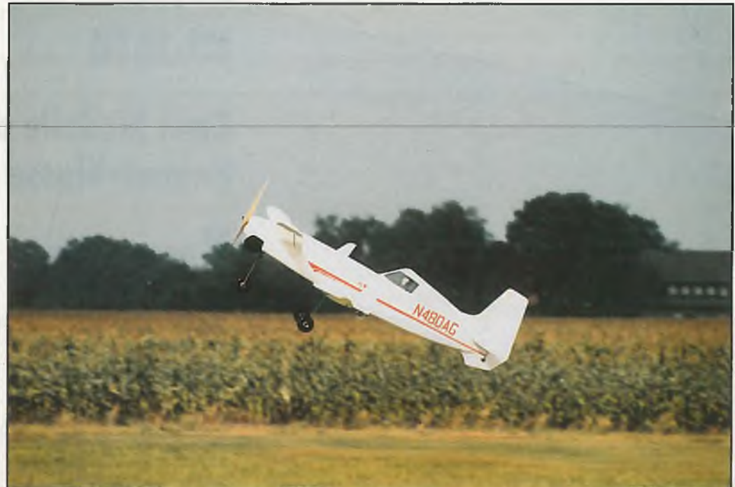
Ein echtes Canard mag es nicht, solche steilen Anstellwinkel, und taucht die Nase schnell nach unten. Anders ein Flugzeug wie der Predator, das genauso überziehsicher wie eine Ente ist, aber dank des Hybridleitwerks hinten viel wendiger
