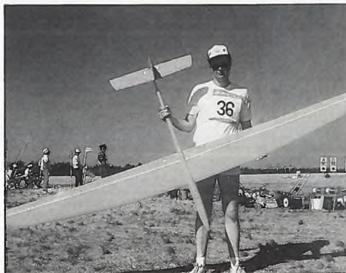
Stephen Haley, Großbritannien, Bronzegewinner. Haley, einer der Schnellsten im Speedflug auf der WM, verwendet ein sehr dünnes Flügelprofil mit Zackenband als Turbulator. Rechts im Bild, im Hintergrund, die großen Signaltafeln, auf denen die Speedzeiten angezeigt wurden
