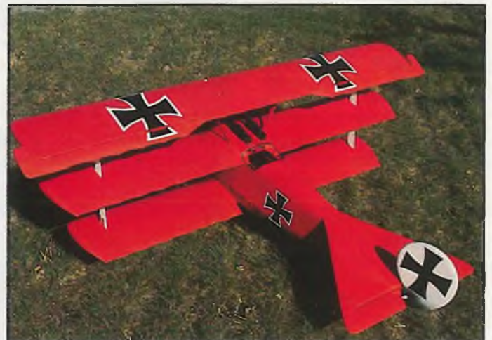
Der Dreidecker als Modell nach unserem Bauplan, mit 2060 mm Spannweite, 1370 mm Länge und 8–10 kg Fluggewicht
