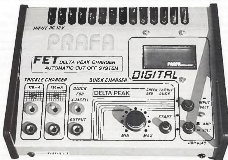
Akkus bis 12 Zellen schafft dieses handliche Gerät
