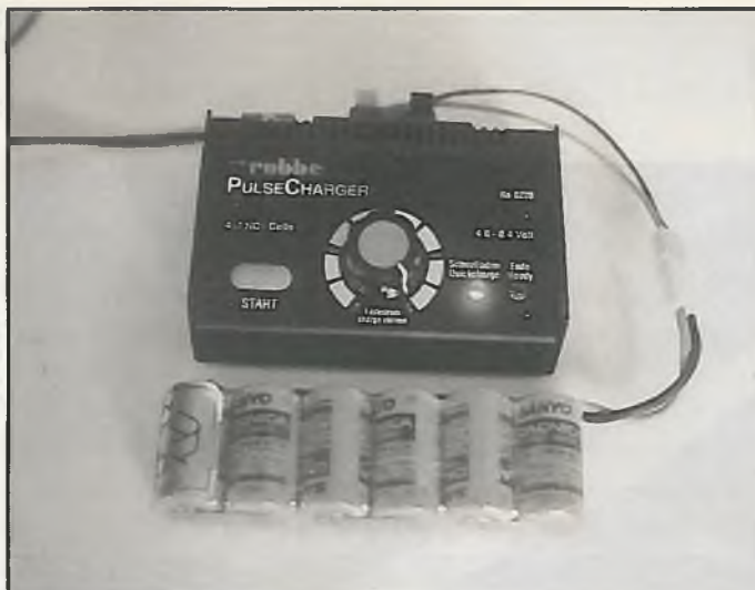
Der preiswerte Pulse Charger bringt echte 5 A mit Delta-Peak-Kontrolle, die sehr zuverlässig arbeitet
