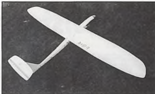
Wieder ein Versuch, sich an die ideale Flügelform zu nähern. Tinka (CS) hat dieses Modell mit elliptischer Tragfläche gebaut
