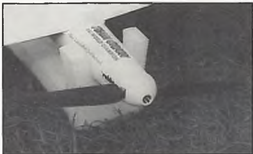
Der Turbospinner von Robbe soll Kühlluft zum Motor „hinschaufeln“. Die Geister scheiden sich noch über den Nutzen der Sache
