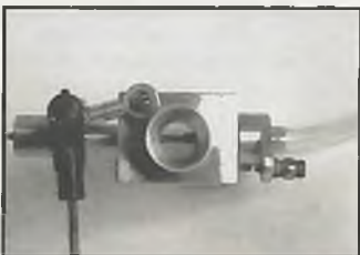
Der Gelenkhebel („Knochen“ aus zwei Kugelköpfen) verstellt axial die Düsennadel
