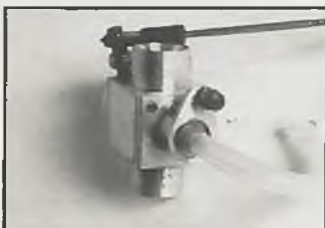
Die Spritzzufuhr erfolgt über das Drosselkükken, das hier nur die Luftmenge reguliert
