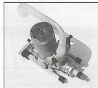
OS/P Hanno Spezial mit Vierpunkt-Motorauflösung und Vergaseransaugung: Heutiger Standard in der Leistungsklasse B
