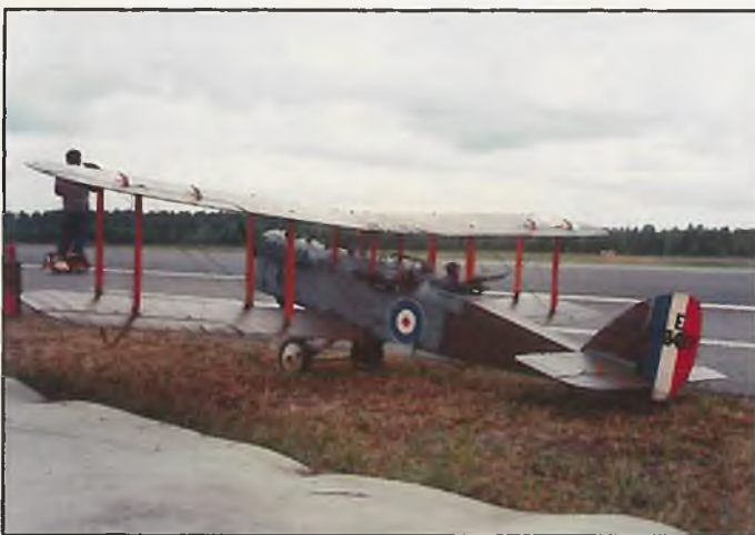
Das Modell des Europa- und Weltmeisters Pete Mc Dermott, eine „De Havilland Airco 9A“. 2,3 m Spannweite bei 6,4 kg Gewicht, Enya 120-Motor, RC Futaba 1024
