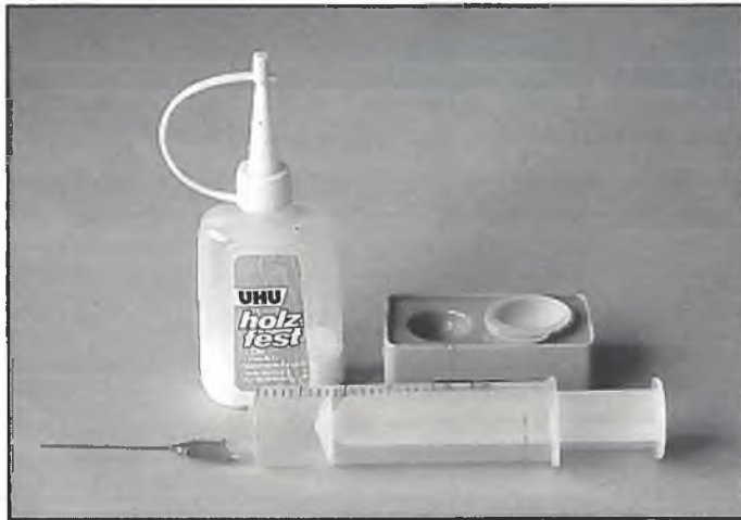
Das „Handwerkszeug“ zur Beseitigung des Schadens: UHU Holzfest, Spritze und ein kleines „Wännchen“ ...
