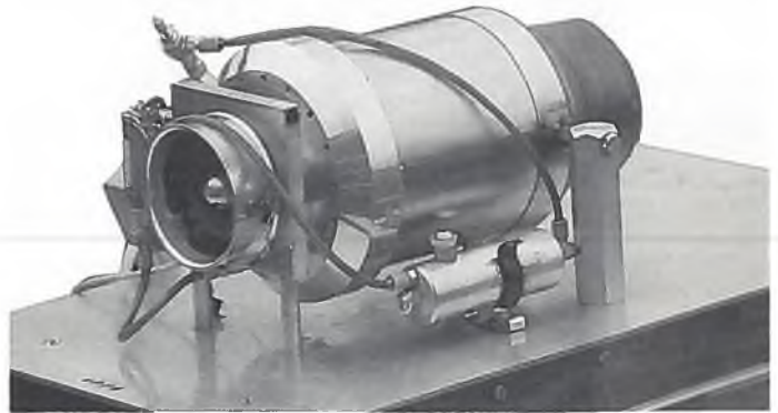
Die Experimental-Turbine des holländischen Teams bei Standläufen. Eindrucks-voll die Fertigungsqualität des Triebwerks, bei dem aber noch vor allem der zu hohe Verbrauch von ca. 0,5 l Petroleum pro Minute den Konstrukteuren Kopfzerbrechen bereitet. Sowohl rein technisch im Hinblick auf die Modelltransportkapazität, aber auch kostenmäßig und letztendlich ökologisch sind 30 Liter Stundenverbrauch einfach zu viel
