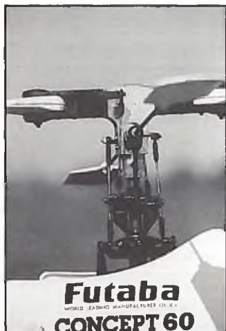
Der umgebaute Rotorkopf; deutlich ist die senkrecht hochgehende Steuerstange zum Blatthalter zu sehen.
