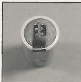
Hier handelt es sich um vier sauber durchkontaktierte Schweißpunkte; was bleibt, ist der noch immer ungenügende Querschnitt des Verbinders von, wie im Text angesprochen, nicht mehr als 1,05 qmm.
