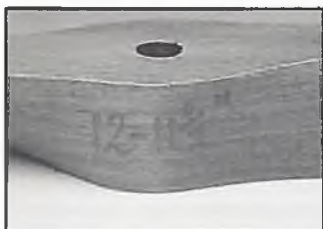
Gut zu erkennen: Das verwendete Holz besteht aus vielen, miteinander verleimten Schichten. Die Verteilung der Schichten erfolgt in einer Presse unter sehr hohem Druck
