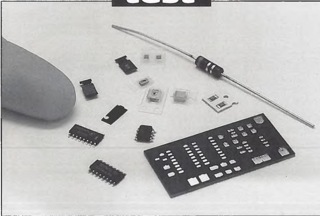
So winzig sind die SMD-Teile des Bausatzes (links eine Fingerkuppe zum Größenvergleich)
