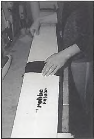
Der Beulbruch liegt unmittelbar vor den Fingern des Testers; typischerweise etwa im Bereich kurz nach der Rumpfauflage
