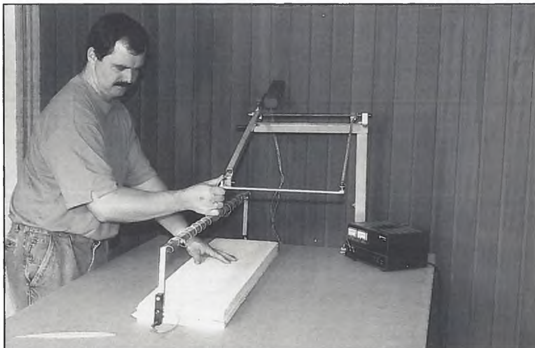
Die „Styroporschneidemaschine für den Einzelgänger oder Single“: Im Gegensatz zu den immer noch am gebräuchlichsten Schneidebügel-Vorrichtungen, zu deren Bedienung man einen geübten Helfer oder Helferin braucht, kommt man hier allein zu recht.
