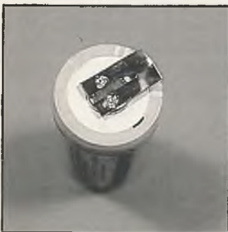
Dieser Verbinder hat nur zwei Schweißpunkte, die zudem noch schlecht ausgeführt sind; wie un schwer festzustellen ist, liegen sie mehr auf der Oberfläche
