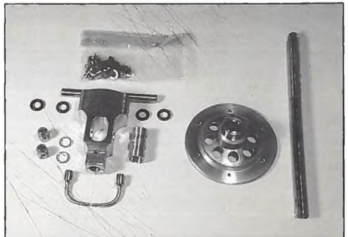
Links die Umbauteile für den Kopf, rechts der neue Dual-Freilauf mit Rotorwelle.
