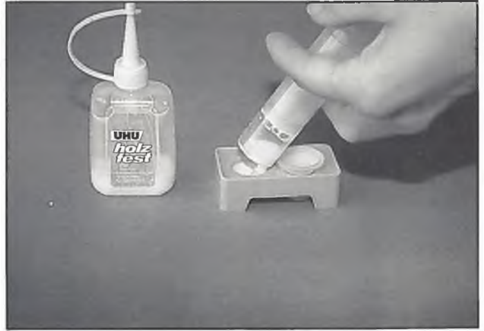
Dessen Verwendungszweck hier eindeutig demonstriert wird; mit seiner Hilfe zieht man den flüssigen Klebstoff in den Kolben
