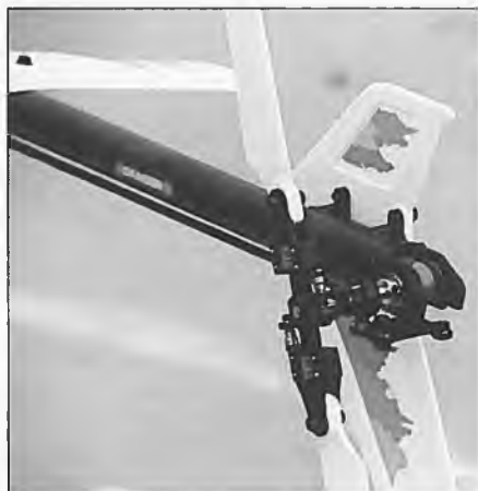
Der Zahnriemenantrieb ermöglicht ein kompaktes, zierliches Heckgetriebe. Die Blatthalter bestehen aus Metall-Seitenplättchen mit Kunststoff-Abstandhalter
