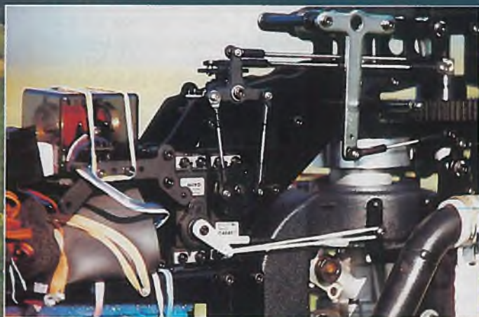
Zusätzliche, natürlich kugellagerte Umlenkhebel ermöglichen die doppelseitige Servoanlenkung, ohne die es zur Zeit anscheinend nicht mehr geht
