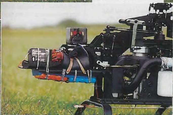
Der lange Vorbau läßt auch bei Verwendung eines Resonanzrohres keine Schwerpunktprobleme aufkommen. Der deutlich sichtbare Quarz am Empfänger wurde übrigens vor dem Erstflug noch gesichert!
