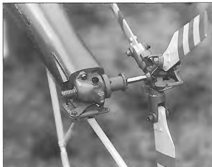
Das Heckgetriebe der Alouette III von Manfred Ennsgraber. Das Getriebegehäuse ist komplett aus Alu herausgearbeitet und die Ansteuerung des Heckrotors erfolgt durch die hohle Heckwelle, wie beim Original. Natürlich hat das Getriebe auch den Original-Umlenkwinkel von 100° anstelle der üblichen 90°.
