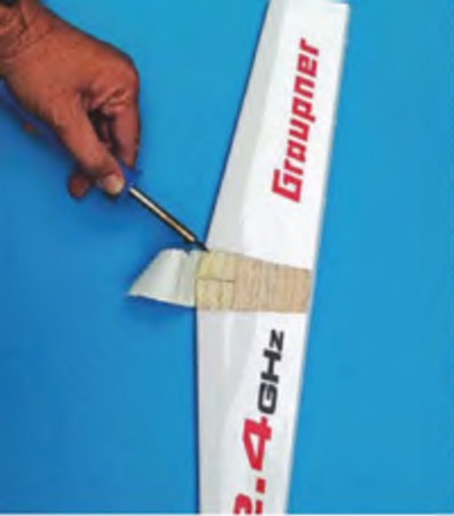
An der Höhenruderdämpfungsflosse ist mit einem Lötkolben die Folie zu entfernen.
