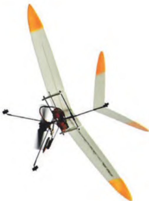
Wie man sieht: es funktioniert. Der Akku schiebt sich unter die verkürzte Tragflächen-seite und der Flieger legt sich in die Kurve.
