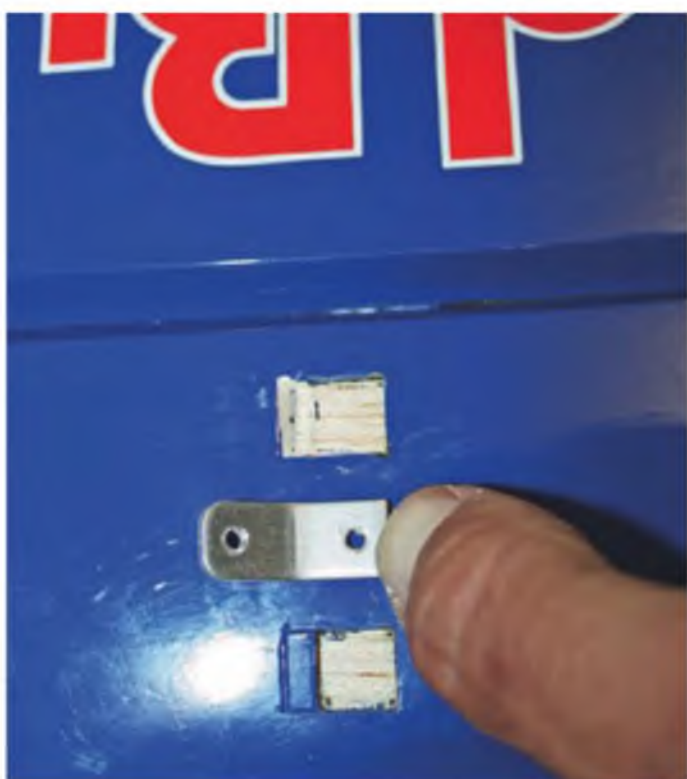
Das sehr leichte und stabile Höhenleitwerk ist im Bereich der Verklebung bereits von der Folie befreit, so etwas sieht man nicht oft!
