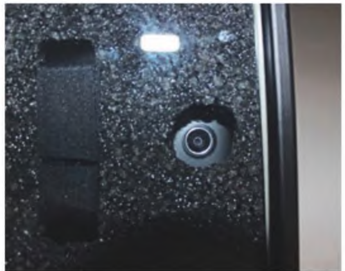
Die Kamera schaut durch ein kleines Loch im EPP. Es sollte etwas größer sein als die Linse, sonst sieht man die Ränder auf den Bildern.
