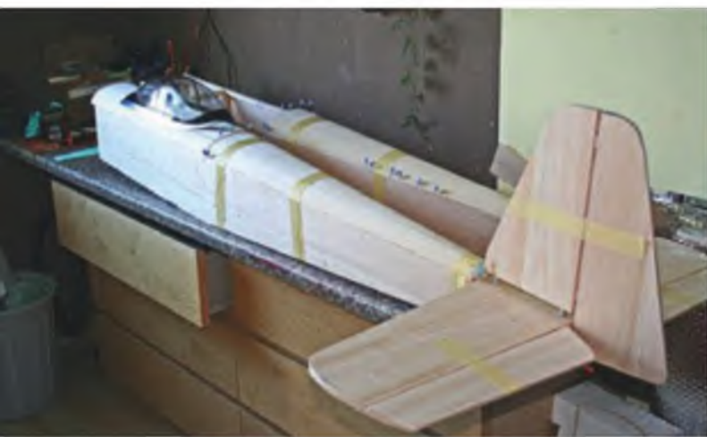
Die Styro/Balsa-Rumpfrücken werden mit dem Kastenrumpf verklebt, gleichzeitig eine kleine „Anprobe“ von Leitwerk und Kabinenhaube
