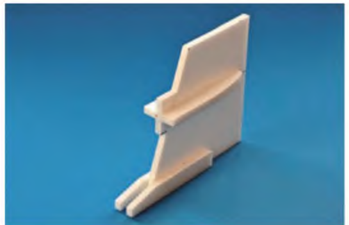
Das fertig aufgebaute Seitenleitwerk. Dort, wo der Motor montiert wird, fehlen noch die Sperrholzstreifen.
