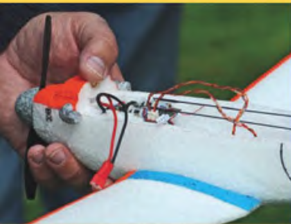
▲ Der Elektromotor und die Elektronik-Komponenten stammen von einer UMX-Sbach. Ein 2s1p-180-mAh-LiPo treibt einen 6x3-Zoll-Propeller an. (Foto: Peter Kohler)
