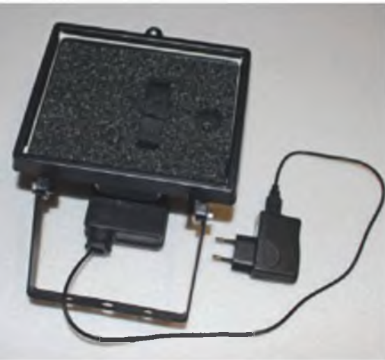
Die fertig aufgebaute Webcam ist bereit zur Montage. Die Stromversorgung erfolgt über das normale Ladegerät des Handys.
