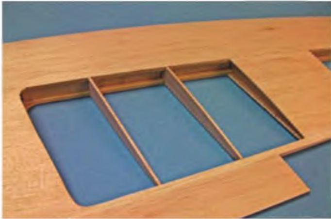
Der Flügel wird schließlich noch beplankt und verkastet.
