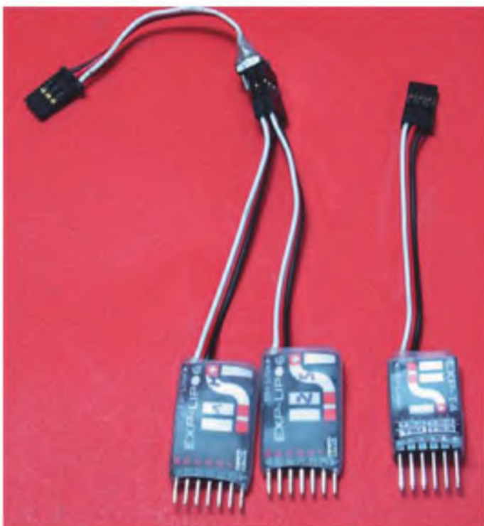
Zwei EXPs zur Messung von jeweils sechs Einzelzellen. Am rechten Modul können verschiedene Temperaturfühler angeschlossen werden.
