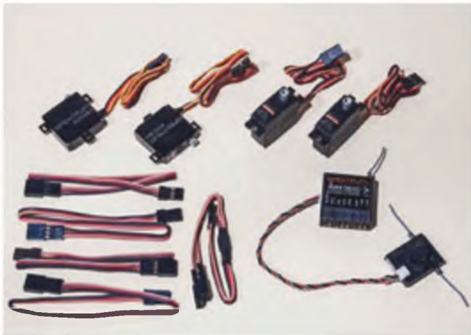
Servoverlängerungskabel, V-Kabel, vier Servos und Empfänger. Viel ist nicht nötig zur Steuerung des Modells.
