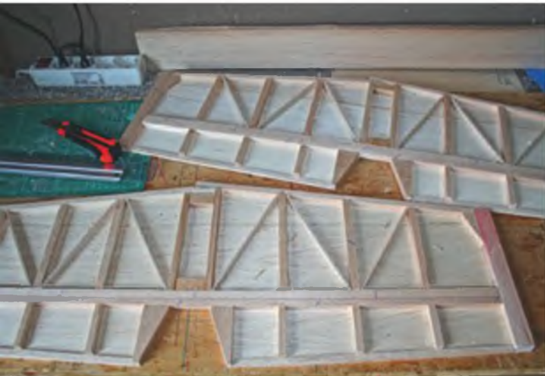
Die Leitwerke entstanden in klassischer Stäbchenbauweise mit anschließender Beplankung.
