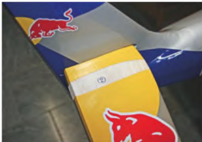
Das sehr leichte und stabile Höhenleitwerk ist im Bereich der Verklebung bereits von der Folie befreit, so etwas sieht man nicht oft!
