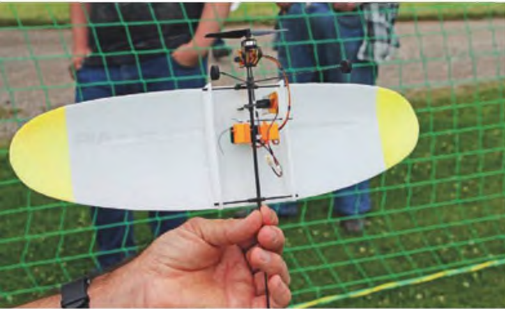
Die Technik auf einen Blick. Zwei Servos verschieben die komplette Tragfläche nach links oder rechts bzw. vorne oder hinten.
