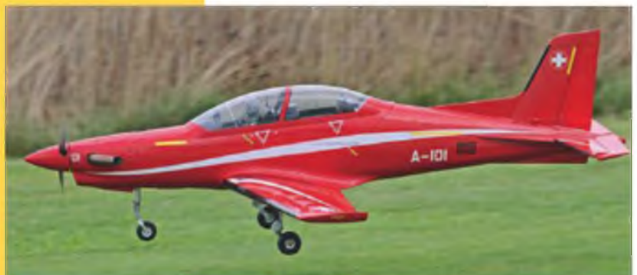
▲ Eine Pilatus PC-21 von ready2fly mit 1,39 m Spannweite und einem Gewicht von 4,1 kg. Als Motor kommt ein Skorpion S4025-12 mit einer 13x8-Zoll-Luftschraube an einem 6s-5.000-mAh-LiPo von Hacker zur Anwendung. Die ursprünglich in der Prototypenbemalung ausgelieferte PC-21 wurde durch Daniel Eichenberger soweit angepasst, dass sie nun das gleiche Outfit hat, wie die Originalmaschinen, welche bei der Schweizer Luftwaffe als Jettrainer im Einsatz stehen. (Foto: Peter Kohler)
