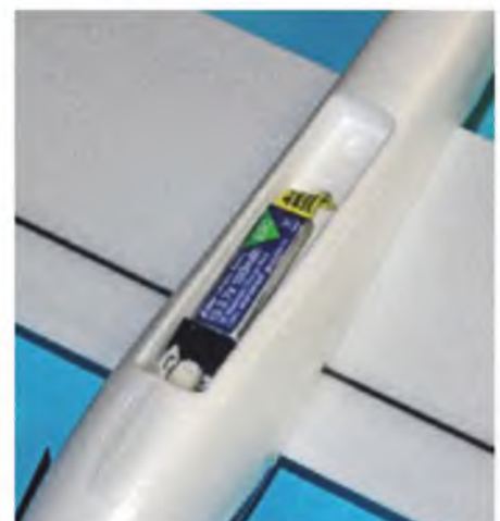
Der kleine 1s-LiPo wird unten am Rumpf in einer Vertiefung mit Klettband befestigt.
