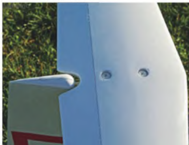
Das Höhenleitwerk wird mittels zweier Kunststoffschrauben auf dem Seitenleitwerk befestigt. ▼
