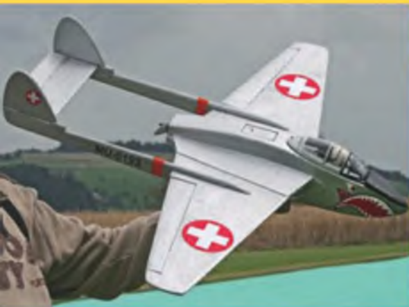
▲ Nach einem FMT-Bauplan von René Bützberger wurde diese DH-100 Vampire gebaut. Das Modell hat eine Spannweite von 88 cm und das Fluggewicht beträgt 600 g.
