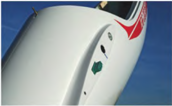
▲ Die elektrische Verbindung der Flächenservos erfolgt mit MPX-Steckern und Buchsen. Eine zusätzliche Flächensicherung (MPX) ist zu empfehlen.
