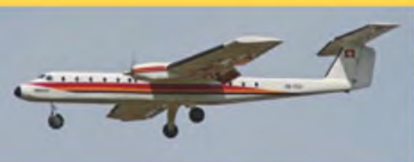
▲ Millennium, so wird diese zweimotorige Passagiermaschine genannt. Ursprünglich mit zwei Verbrennern ausgerüstet (siehe FMT 10/2000), wurde sie 2010/2011 auf Elektroantrieb umgerüstet. Seither fliegt sie mit zwei Turnigy C 5045-890-EL-Motoren an je einem 4s-4.000-mAh-LiPo. Die Spannweite beträgt 2 m, die Länge 185 cm und das Abfluggewicht 6.285 g.
