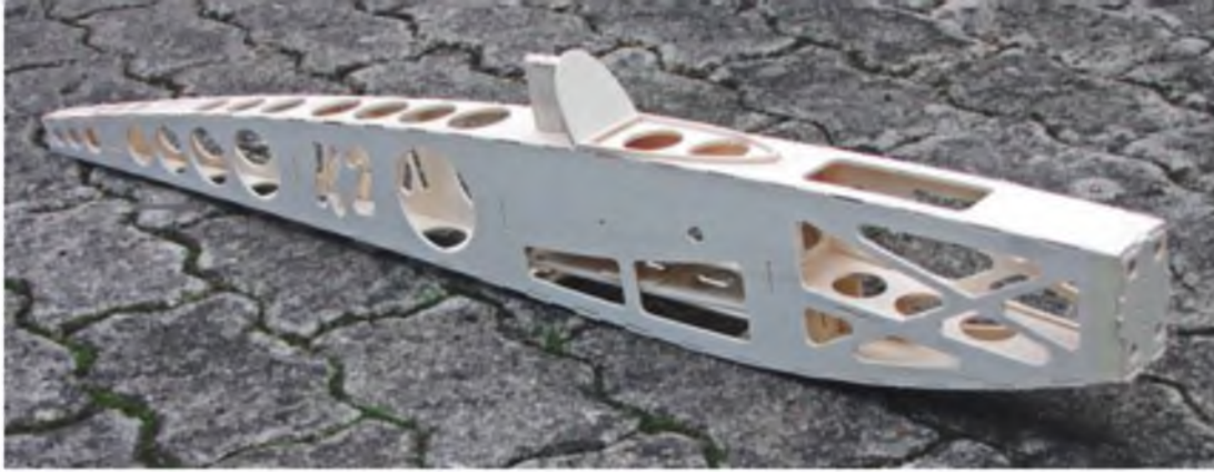
Bild 9: Die ersten Frästeile nur mal zusammengesteckt – das Modell nimmt Form an.
