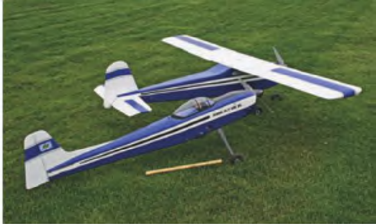
Vom Kwik Fly XL können in wenigen Minuten Tragflächen und Höhenleitwerk auf den Schlepp Kwik umgebaut werden.
