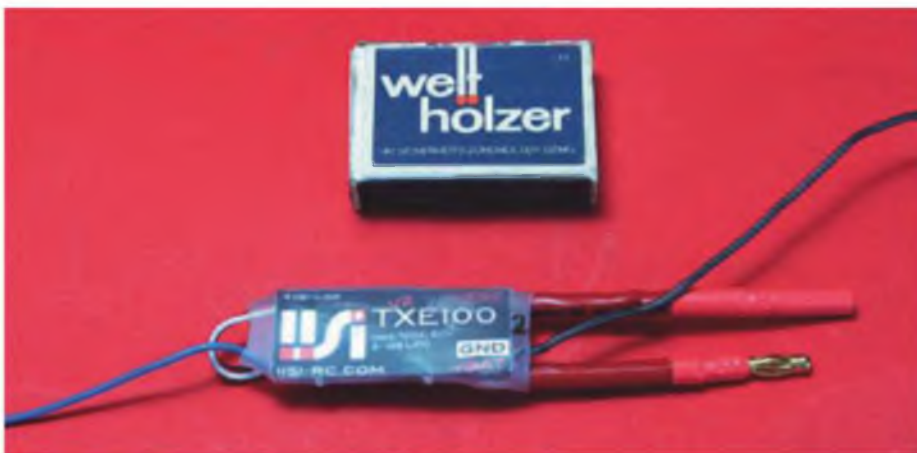
Dieses TXE ist für eine Last von 100 A ausgelegt. Eine kurzzeitige Überbelastung ist möglich, da ein Hall-Sensor zum Einsatz kommt. TXEs gibt es von 30 bis 200 A.
