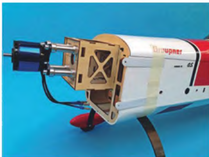
Das Anzeichnen der Bohrlöcher wird mit den Gewebestreifen zum Kinderspiel.
