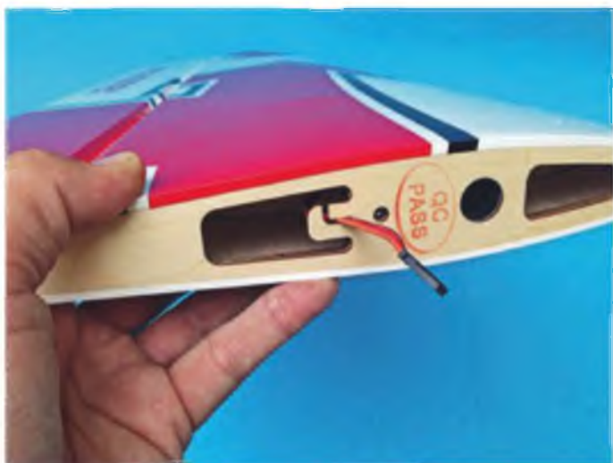
Eine Halterung in der Fläche verhindert, dass beim Transport das Kabel in der Fläche verschwindet. Jeder kennt das lästige Schütteln, wenn das Servokabel in der Fläche liegt...
