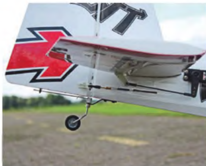
Der Hecksporn wird vom Seitenruder mitgenommen. Das Höhenruder-Servo sitzt direkt vor der Dämpfungsfläche.
