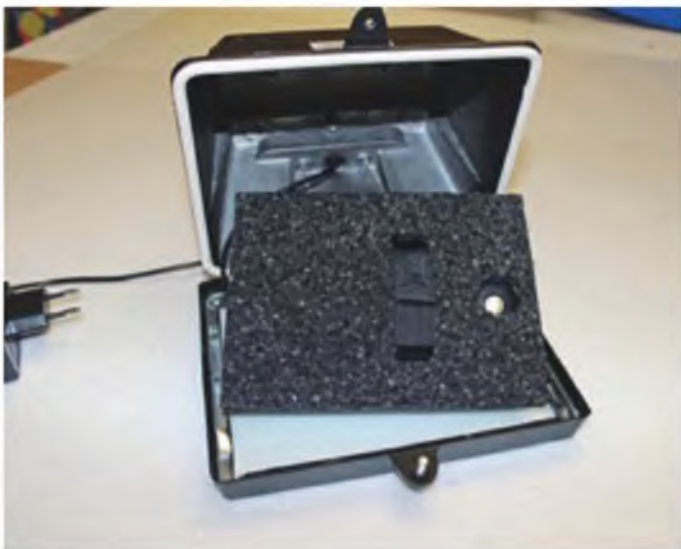
Die Kamera schaut durch ein kleines Loch im EPP. Es sollte etwas größer sein als die Linse, sonst sieht man die Ränder auf den Bildern.
