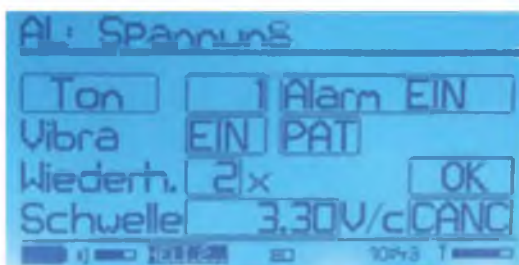
Alarmeinrichtung der Spannung. Sound, Vibration und Schwellenwert sind einstellbar.
