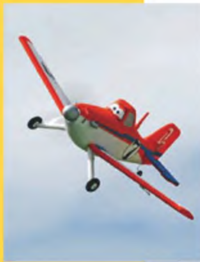
◀ Das Mikro-Modell im Maßstab von 4,7:1 hat eine Spannweite von 50 cm und wiegt nur 85 g. Gesteuert wird es über Quer-, Höhen- und Seitenruder, gekoppelt mit dem Spornrad, sowie der Motordrossel. Das Modell kann natürlich auch Indoor geflogen werden. (Foto: Peter Kohler)
