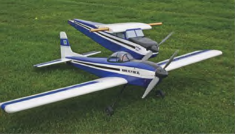
Vom Kwik Fly XL können in wenigen Minuten Tragflächen und Höhenleitwerk auf den Schlepp Kwik umgebaut werden.
