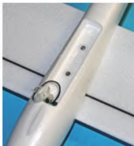
Der kleine 1s-LiPo wird unten am Rumpf in einer Vertiefung mit Klettband befestigt.
