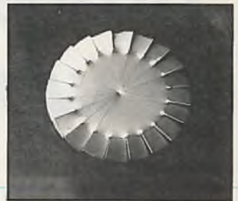
Das Turbinenrad, aus Edelstahl-Blech gefertigt
