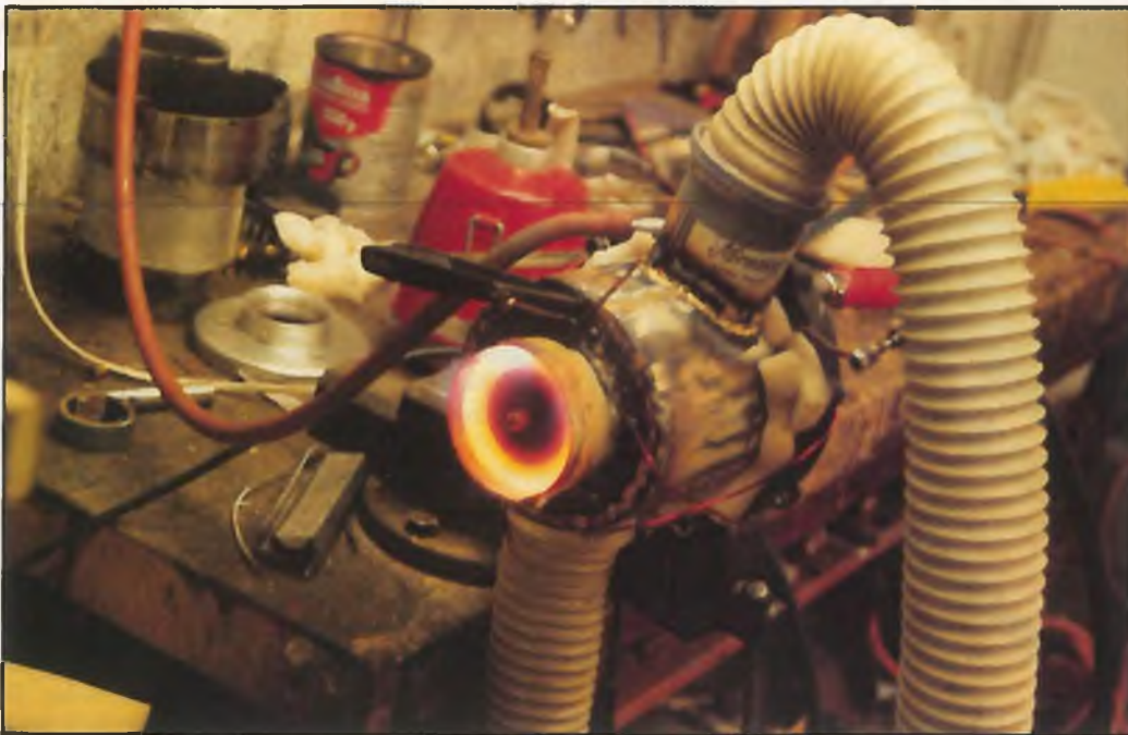
Das Turbinenentwicklungslabor bei Rolls-Royce sieht vermutlich etwas anders aus. Dennoch, auch mit Schraubzwingen- und Drahtbefestigung, Alufolie als Dichtung und Staubsaugerschlauch als Luftleitsystem: Das Modellstrahltriebwerk läuft!
