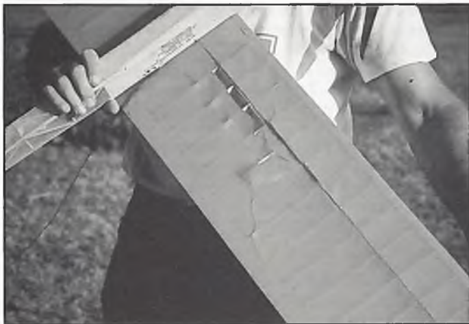
Schöberls Solix flog die meiste Zeit mit dieser zerfetzten Flügelunterseite, konnte sich aber trotz dieser Beschädigung und einer unterbrochenen Solarzellenreihe noch bei 25 % Einstrahlung in der Luft halten
