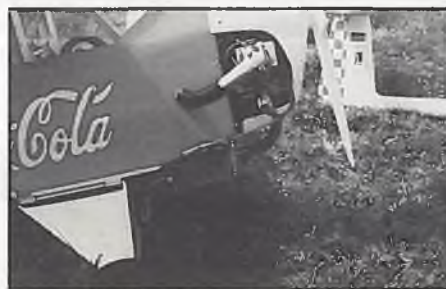
Die Mittel sind nicht immer schön, aber wirkungsvoll: Vierblattpropeller, überdimensionierte 2-Blatt-Luftschaublen, große Schalldämpfertöpfe, möglichst vollständige Motorverkleidung, Vergaserluft aus dem Rumpf, 4-Takt-Boxer: Das sind einige der Maßnahmen zur Lärminderung bei ausreichender Leistung
