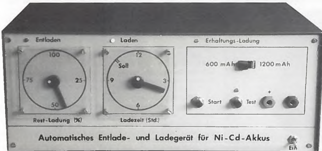
Ansicht des Automatik-Laders. Typische Situation 5 Stunden nach einem Flugtag: Die Ladungsreserve des Empfängerakkus war nahezu 50 %. Die Wiederaufladung läuft schonca. 4 Stunden.
