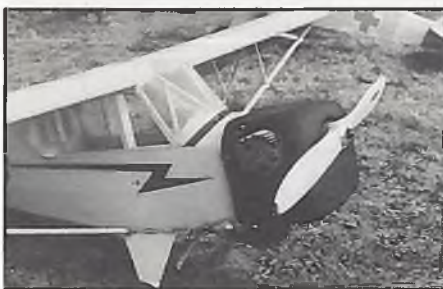
Die Mittel sind nicht immer schön, aber wirkungsvoll: Vierblattpropeller, überdimensionierte 2-Blatt-Luftschaublen, große Schalldämpfertöpfe, möglichst vollständige Motorverkleidung, Vergaserluft aus dem Rumpf, 4-Takt-Boxer: Das sind einige der Maßnahmen zur Lärminderung bei ausreichender Leistung
