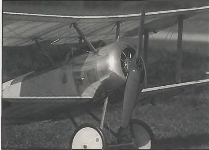
Hervorragend gebaute Sopwith Pup von Wolf-Dieter Banke. Grundlage war der Bausatz von Toni Clark. Spw. 2 456 mm, Länge 1 817 mm, 16 000 g, Motor Titan 38 ccm.
