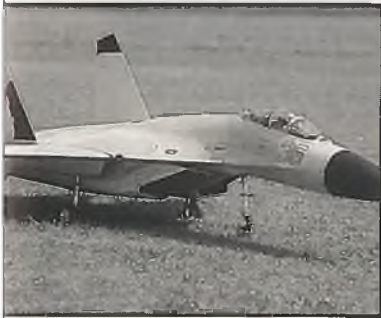
SU-27 Flanker von Werner Schletterer, Spw. 1 650 mm, Länge 2 450 mm, Profil Tragfläche Gö 445, 10 500 g, 2 x OS 15 ccm, Impeller.
