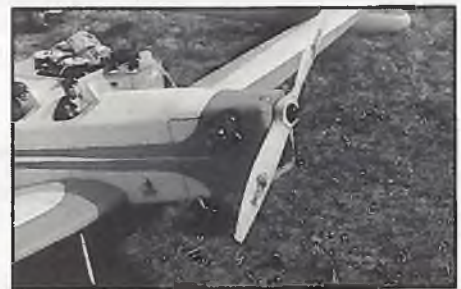
Die Mittel sind nicht immer schön, aber wirkungsvoll: Vierblattpropeller, überdimensionierte 2-Blatt-Luftschaublen, große Schalldämpfertöpfe, möglichst vollständige Motorverkleidung, Vergaserluft aus dem Rumpf, 4-Takt-Boxer: Das sind einige der Maßnahmen zur Lärminderung bei ausreichender Leistung
