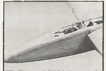
Viele Baukastenmodelle werden modifiziert. Hier ein Tercel von Höllein, den Jürgen Baumgarten auf Flächenverwindungs-Steuerung umbaute
