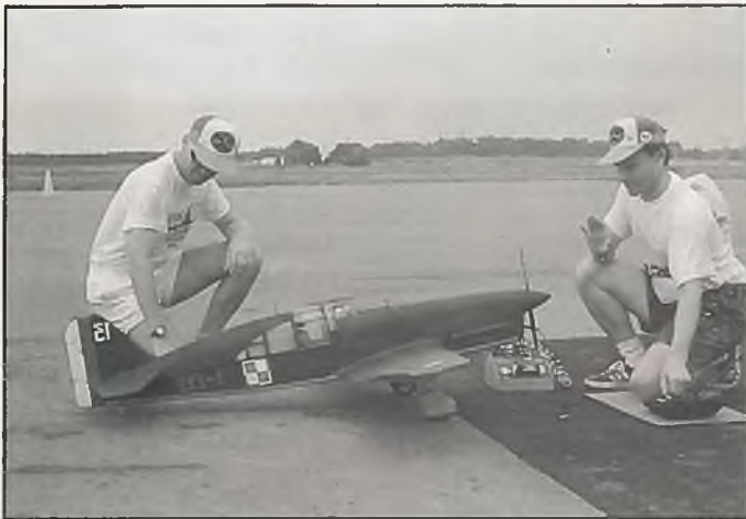
Caudron Renault CR-714 von Waclawik, CSFR, ist auch in der Bundesrepublik von Wettbewerben bekannt. 1 840 mm Spw., 5 600 g Gewicht, Motor ST-90
