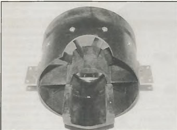
Die festen Komponenten: Der Ramtec-Mantel mit Stator und Motor-träger
