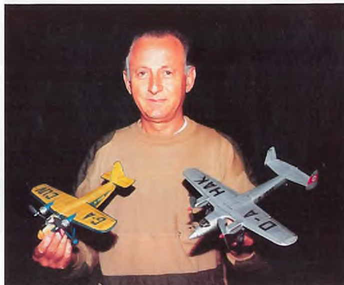
Die Peanuts des Franzosen Aime (Short Scion und Do 17): Im Rumpf befindet sich der Gummistrang, der über drei Zahnräder und zwei biegsame Wellen die Propeller antreibt. Es wurden Flüge von 22 Sekunden gestoppt!
