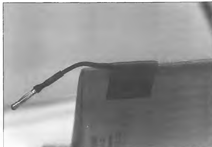
Antenne aus CU-Lackdraht an der Flügelendleiste, mit 2 mm-Goldstecker
