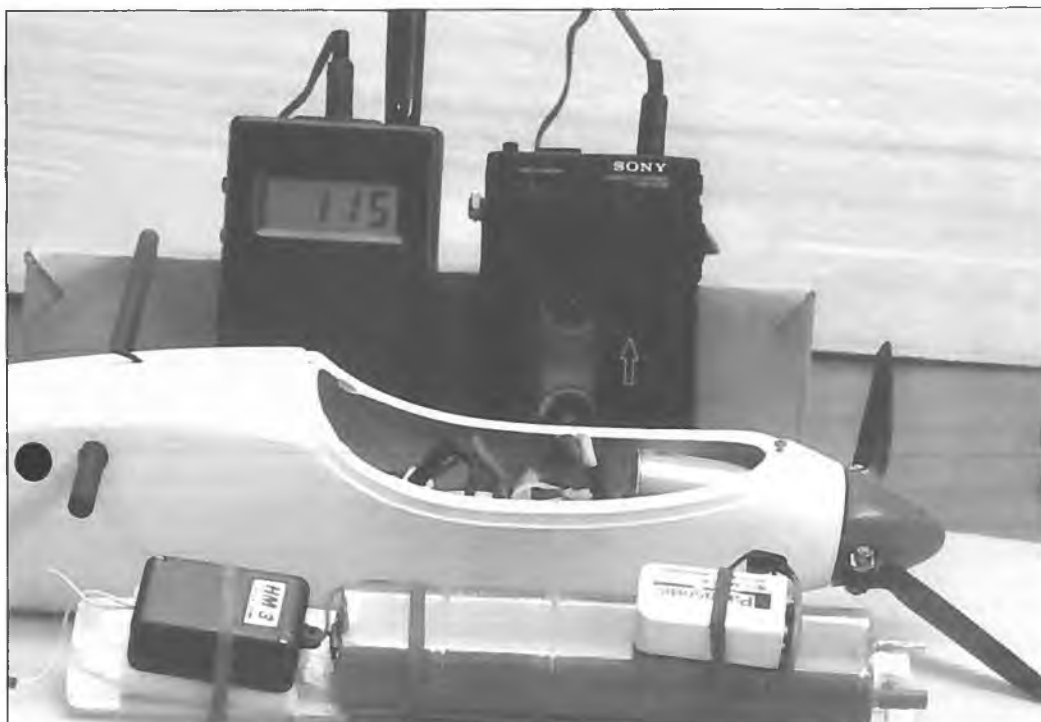
Variosender links neben dem Akku-Pack montiert, oben drauf der 9-V-Akku. Im Hintergrund der Empfänger (sein Höhenmesser gibt gerade den Höhenunterschied zwischen Flugplatz und Werkstatt an). Rechts der Kassettenrekorder
