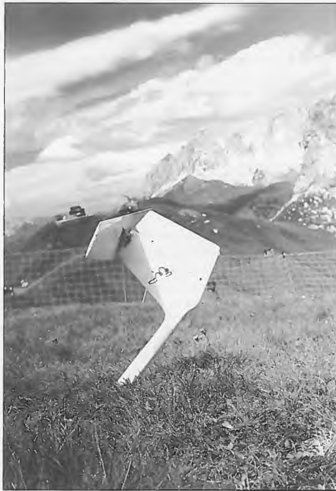
Eine wunderschöne Alpenstecklandung. Immerhin, dieser Rumpf ist sehr gut gebaut und verstärkt worden, was man an der Tatsache erkennt, daß die Rumpfröhre vor dem T-Leitwerk nicht brach
