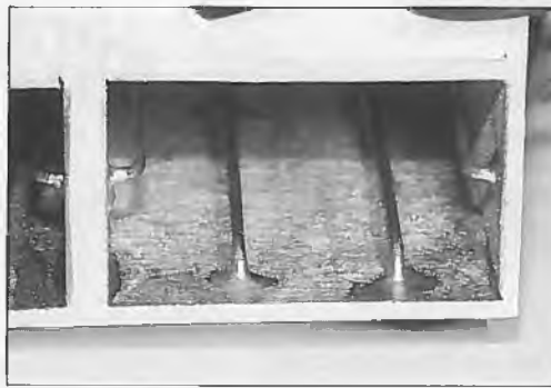
Die Abstandsschienen aus Messingdraht sorgen dafür, daß die Batterie von allen Seiten gekühlt wird
