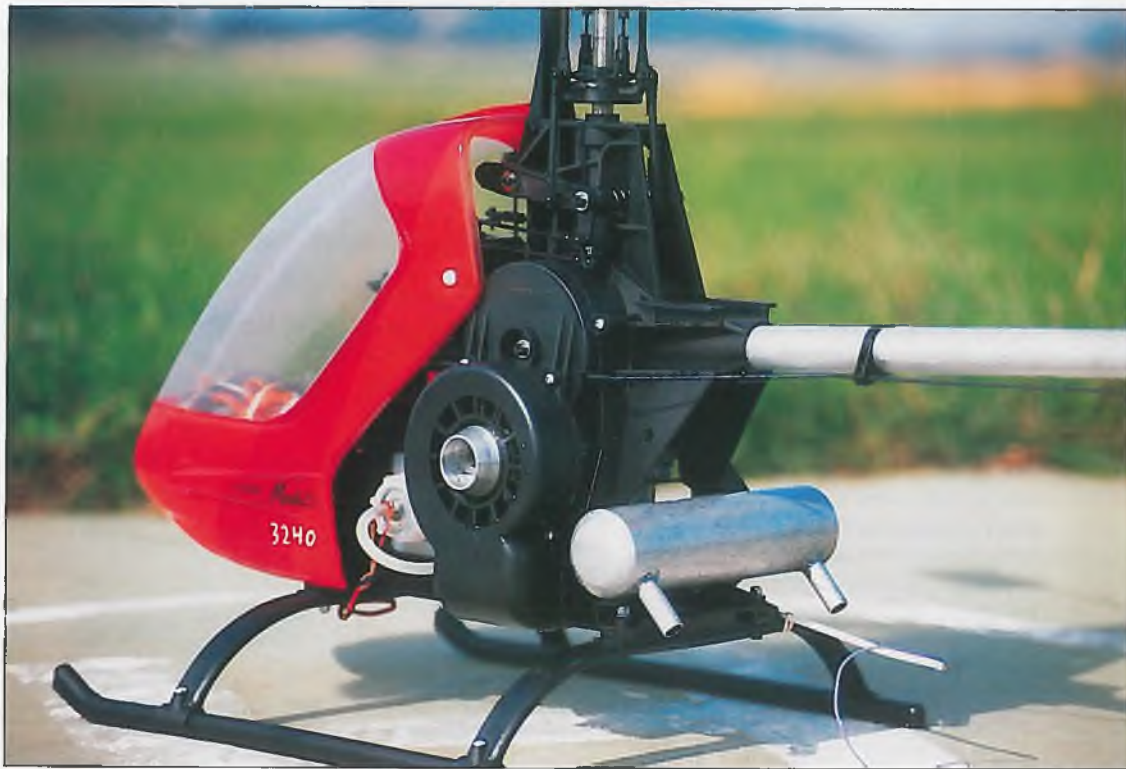
▲ Der Basic, hier schon mit dem Enya SS 44 BB und einem Vormuster des empfohlenen Spezialschalldämpfers
