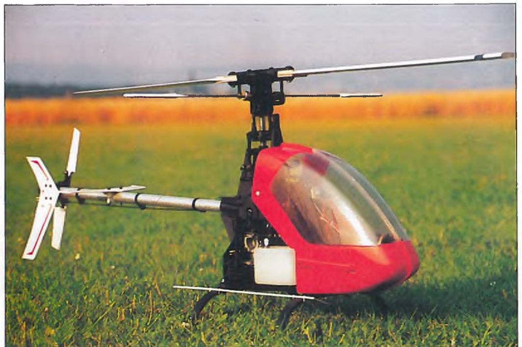
Praktisch: Der großvolumige Tank ist sehr gut einsehbar
