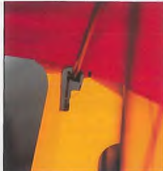
Der Servohebel mit einer Steuerstange. Die Aussparung wurde hier bereits nachgearbeitet, um die erforderliche Bewegungsfreiheit zu verschaffen. Der Pfeil zeigt die Stelle, an der der Hebel ursprünglich angestoben ist.
