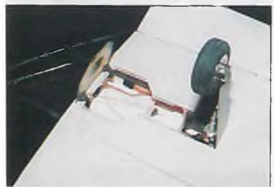
...und später von einem KFK-Formteil, an welchem auch die Fahrwerkstüren angeschlagen sind, verschlossen wird.
