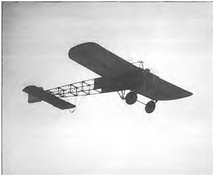
Ein richtiger Oldtimer, von viel Draht zusammengehalten (21 m Litze wurden für die Verspannung verbraucht!). Ein eindrucksvolles, hochinteressantes Flugbild
