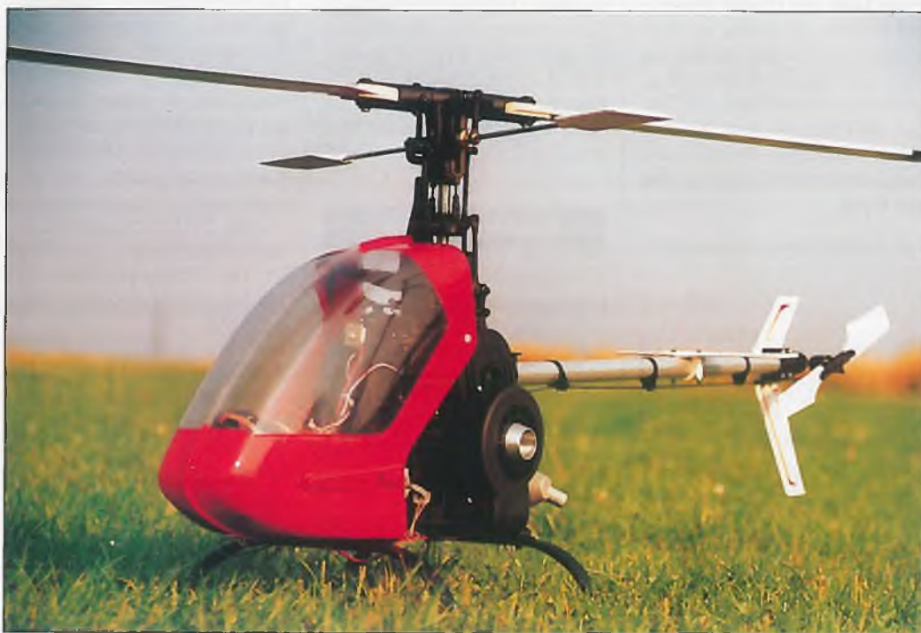
Praktisch: Der seitliche Spinner erleichtert den Anlaßvorgang
