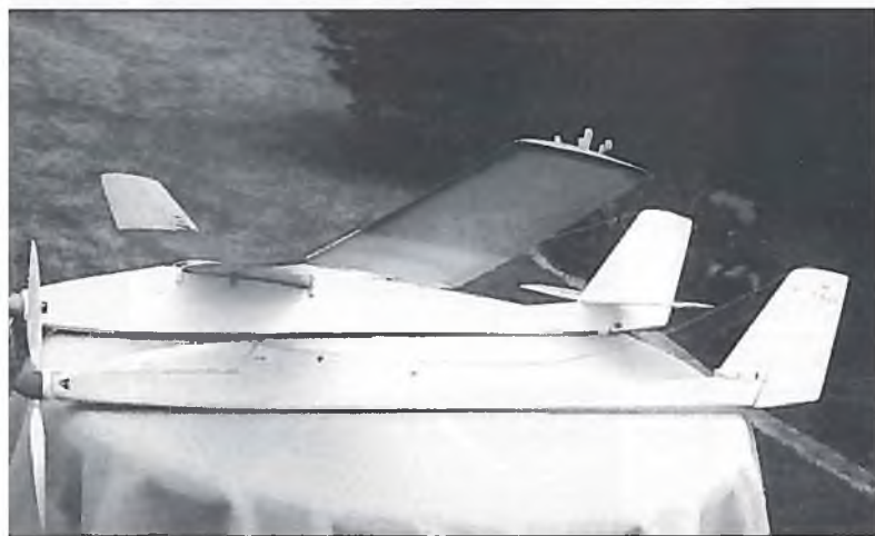
Der alte und der neue Rumpf: Deutlich ist der Unterschied im Querschnitt zu sehen. Dadurch ist der Rumpf leichter und hat weniger Widerstand. Die Form der Kabine ist der Kontur des angeklappten Propellers angepaßt
