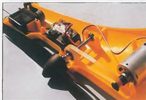
Der Antrieb erfolgt durch ein Zahnriemenge triebe, die Propellerwelle ist sogar kugellagert
