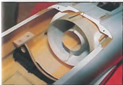
Um den gestiegenen Umweltanforderungen gerecht zu werden bietet Bob Violett als Option für seine Jets das „Hush-Kit“ an, gut für 4 dB(A) Lärmreduzierung
