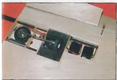
Die Flächen, beim „Neuen“ steckbar ausgeführt, haben auf der Unterseite eine Ausfräsung, die das Landeklappen- und Querruderservo, das Einziehfahrwerk, den Betätigungszylinder und das Rad, hier mit Bremse, aufnimmt.....
