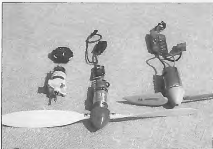
Die Antriebe im Größenvergleich. Graupner Speed 600 mit Regler 260 g, Speed 400 mit Getriebe und Mini-Regler 160 g, beide ind. Prop und Spinner. Das gleichgute, aber wesentlich preisgünstigere Groß-Getriebe, leider mit etwas größerem Durchmesser, und die Höhenmesser-Uhr von Casio.
