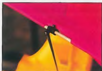
Dieses Kunststoffteil hält die Stabilisierungs- und Steuerstreben bei der Stange. Es wird durch eine Madenschraube am seitlichen Hauptholm festgeklemmt
