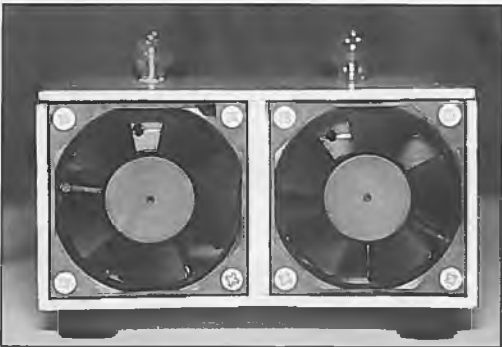
Die Axiallüfter sind an der Rückseite befestigt
