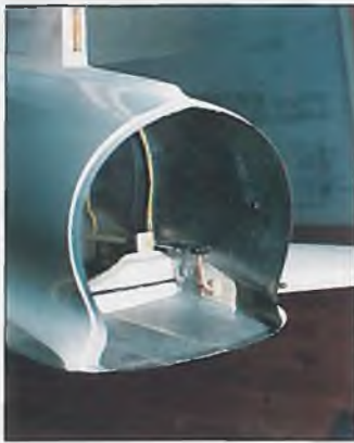
Durch außenliegende Ruderanlenkungen verschenkte der Aggressor II noch ein wenig Leistung, beim Aggressor III ist auch dies geändert: Eine innenliegende Anlenkung gehört zur Baukastenausstattung, genau wie ein Rumpf, der in der hinteren Hälfte aus Kevlarverstärktem Kohle-Epoxyaminat gefertigt ist.
