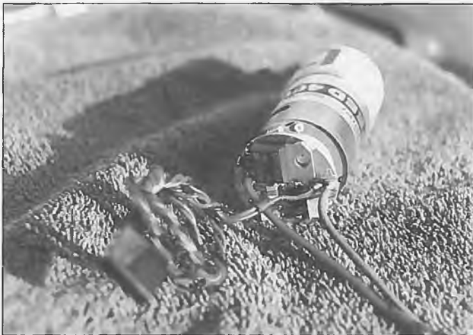
Eine weitere interessante Variante: Speed 400 mit direkt angelötetem Drehzahlsteller ermöglicht eine weitere Einsparung von 8 g. Der Nachteil: Der Drehzahlsteller ist ohne Bremse, und so kommt der große Propeller beim schnelleren Flug nicht zu Stillstand
