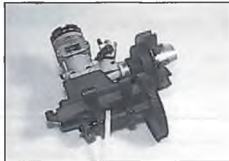
Der Motorblock mit erster Getriebestufe und eingelegtem Zahnriemen
