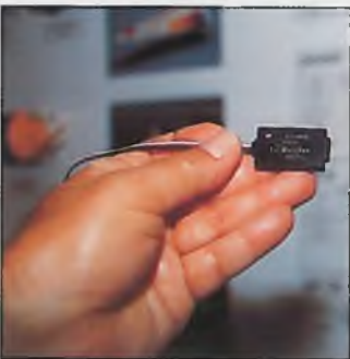
Auch neu bei robbe, „Fail Safe für alle“: Der Baustein wird zwischen Empfänger und Servo gesteckt und steuert das Servo bei einer Störung in eine vorgewählte Stellung. Nur jeweils ein Servo wird also mit Fail Safe bedient, man kann den Baustein aber bei allen Anlagen einsetzen
