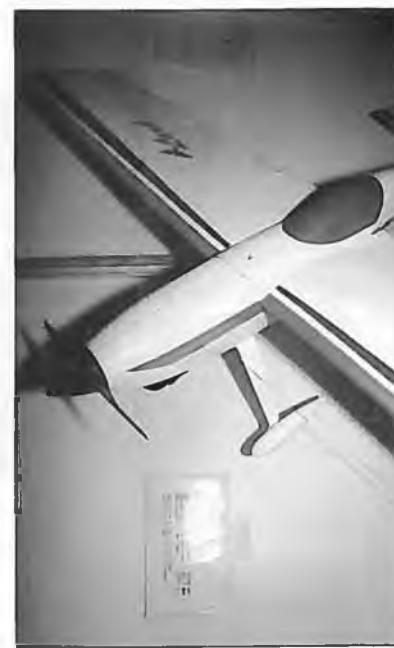
Ein schöner Trainer „LARK“ von OBAG (Fax 0042206682552) hat 1500 mm Spannweite und fliegt elektrisch (3 kg) oder mit Verbrenner (2,6 kg). Lieferung rohbaufertig (GFK-Rumpf, Balsflügel)
