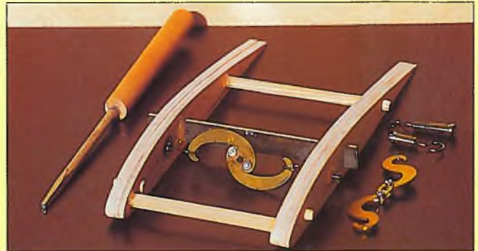
Die komplette Mechanik mit Vierkant-Öffnungsschlüssel. Die Federstahlhaken sind in M5-Gewindestücke eingelötet, die wiederum in M5-Gewindebuchsen eingeschraubt werden. Letztere sind in der Wurzelrippe eingearzt; man kann also jederzeit Ersatzhaken einschrauben
