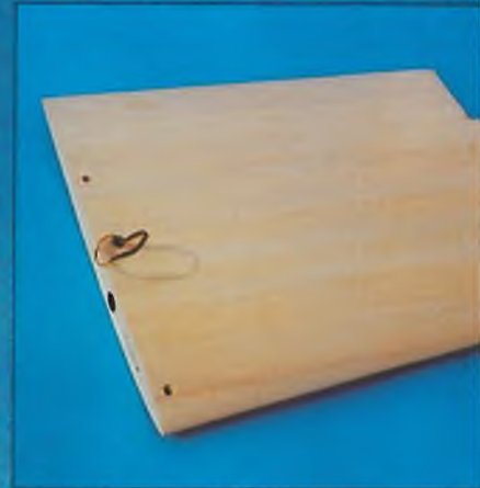
Sämtliche Bohrungen in der Tragfläche sind bereits werkseitig angebracht
