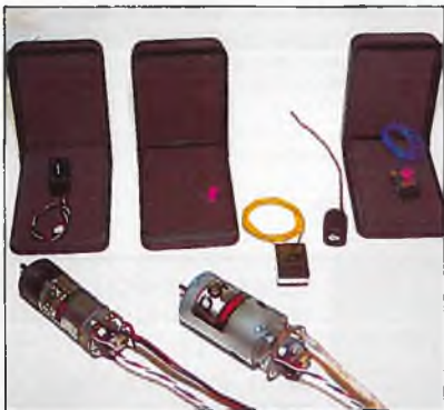
CETO: Elektroflugschalter und -regler zur Steckmontage auf die Rückseite von 400er und 600er E-Motoren. Dahinter die Mikroempfangsanlage, das Servo, der Quarz, der Empfänger
