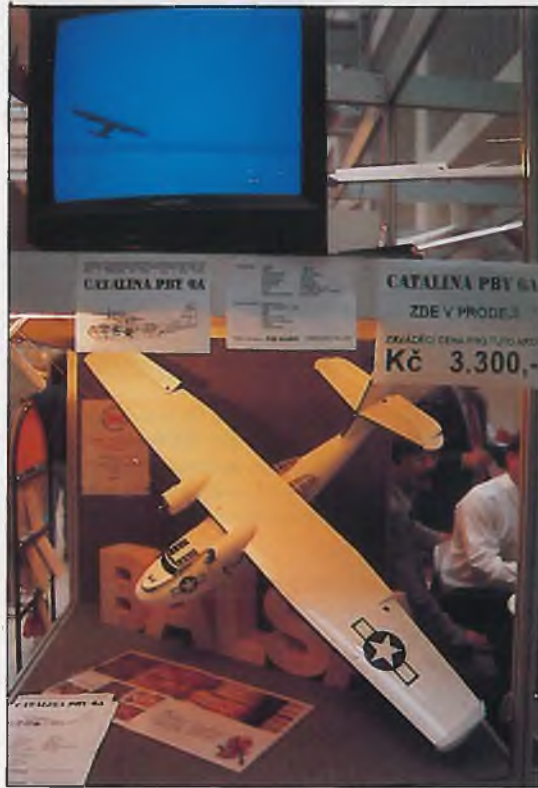
Die Catalina als bespannfertiges Modell von „hvp“ hat 1380 mm Spw., S 3021 Profil und fliegt mit 2 Speed 400 recht ordentlich, wie man sich auf einem Video überzeugen konnte. Das Modell, das einen der Preise auf der Ausstellung gewann, sollte bald in Deutschland angeboten werden
