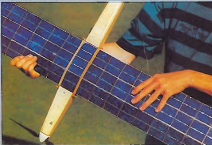
Aufbau des Solarzellen-Aramidwaben-Sandwich
