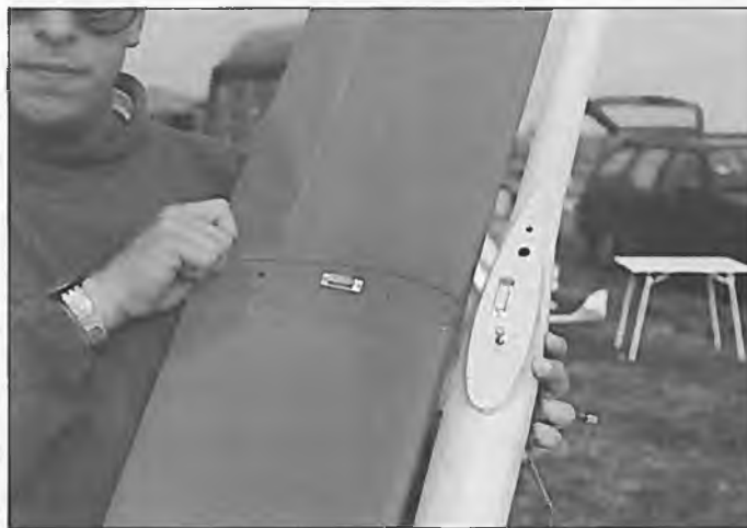
Paß: Ein angeformter Sattel auf dem Rumpf und eine entsprechend ausgeführte Vertiefung in der Flächenunterseite garantieren eine exakte Verbindung der beiden Teile. Modell „Thermik C“
