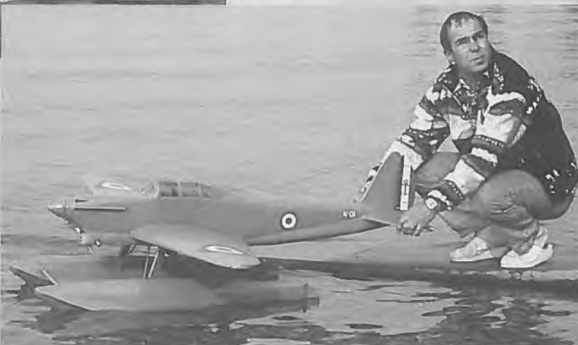
▲ Mit seiner He 42 hat Francois Rollier den undenkbbaren 4. Platz belegt. 2,08 m Spannweite, 7,5 kg Gewicht, 30 cm 3 ST, Anlage Grp.mc 20
