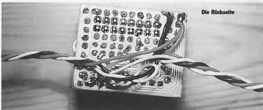
Mit etwas Geschick läßt sich der Baustein direkt am entsprechenden Servo befestigen und verkabeln
