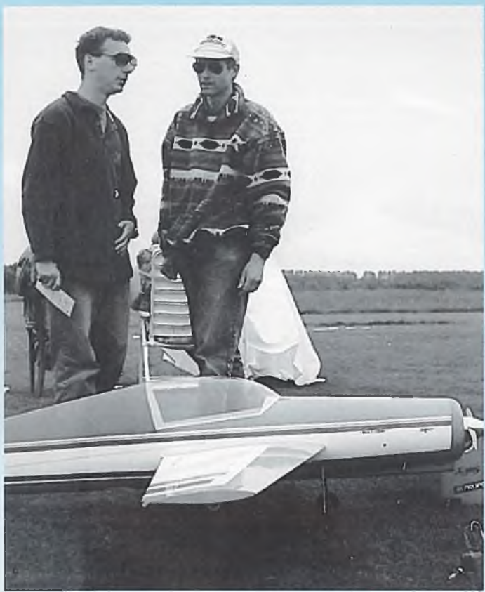
Die Überraschung von E.Lipperer: Super Tucano 2 x 2 m mit Semiscale-Abmessungen. Leicht bauen muß man! Mit 3-Bein Fahrwerk und Webra 120 R nur knapp unter der 5 kg-Grenze. Sehr ansprechendes Flugbild. Das Modell gibt es auch als Bausatz!
