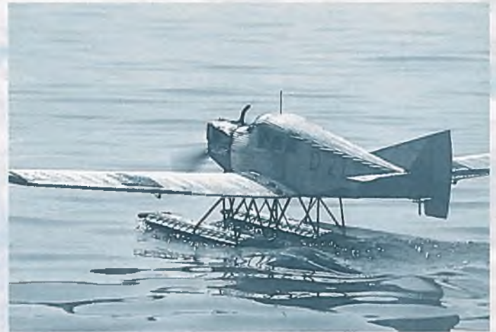
▲ Einfach hergestellt und dennoch sehr gut in der Wirkung: Die „Wellblechbeplankung“ auf der Ju F-13 von Michael Fölbach ist aus Wellpappe entstanden. 2,25 m, 5 kg, Enya 120 4-T, Anlage MPX Royal
