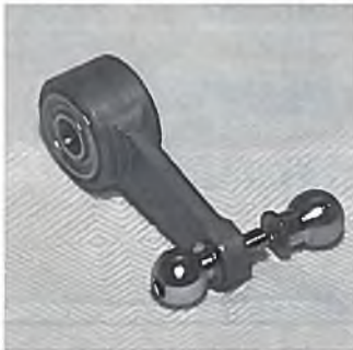
Details am Rande: der kugelgelagerte Alu-Umsetzhebel für die Parallelogramm-Ansteuerung der Nickfunktion
