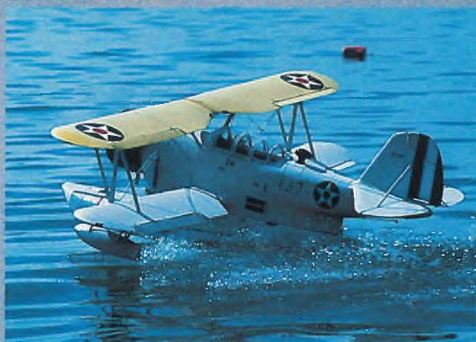
▲ Ein einmaliges Erlebnis ist auch diese Grumman Duck von John Scrivener. Das Amfibium flog nur außerhalb des Wettbewerbs, denn John absolvierte in Hagnau den ersten Wasserstart überhaupt. Elektrisches Fahrwerk, Rumpf und Schwimmer blechbeplankt, Antrieb durch einen 40 cm 3 Laser-V-Motor
