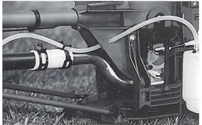
Details am Rande: der kugelgelagerte Alu-Umsetzhebel für die Parallelogramm-Ansteuerung der Nickfunktion
