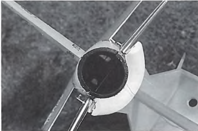
Ein „Ofenrohr“ als Auslaß für den Impeller. Die Idee ist gut, doch die raue Styroberfläche und der Quersteg, der die Höhenruder verbindet, kosten Leistung.
