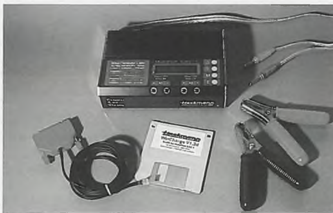
Sehr gut: Die Anschlußkabel sind mit Bananensteckern versehen, in den stabilen Batterieklammern sind entsprechende Buchsen. Die PC-Software besteht aus Diskette, Verbindungskabel und Anleitung.
