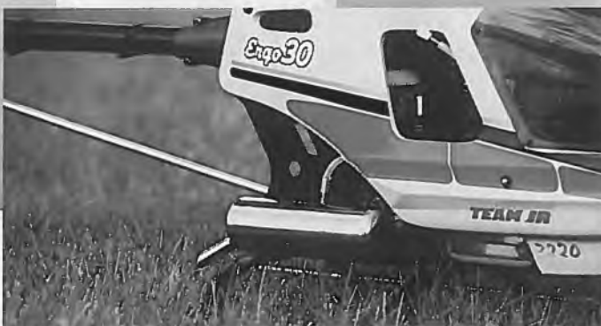
Recht harmonisch fügt sich der neue Edelstahldämpfer in das Gesamtbild des Ergo 30 ein
