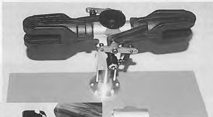
Das Alu-Zentralstück für den X-Cell-Rotorkopf soll besseren Rundlauf und höhere Steuerpräzision bringen
