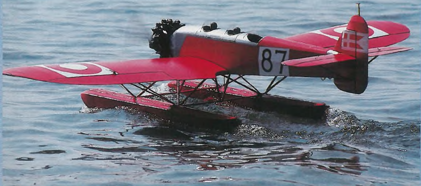
▲ Mit dieser He 8 konnte Günter Hückl den Wanderpokal des Grapner-Bodensee-Cups für sich gewinnen. Modelldaten: 2,4 m Spannweite, OS FS 160 Boxermotor, 7,3 kg Fluggewicht, Anlage MPX 3030. Finish entsprechend einer dänischen Arktis-Expeditionsmaschine aus den 30er Jahren
