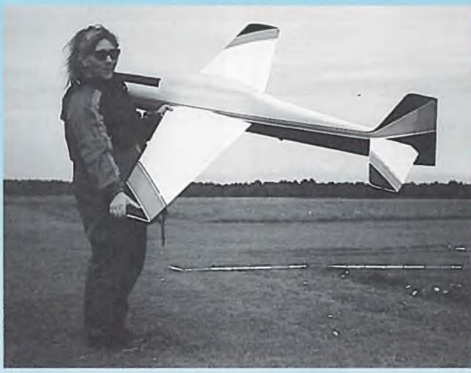
Die Überraschung von E.Lipperer: Super Tucano 2 x 2 m mit Semiscale-Abmessungen. Leicht bauen muß man! Mit 3-Bein Fahrwerk und Webra 120 R nur knapp unter der 5 kg-Grenze. Sehr ansprechendes Flugbild. Das Modell gibt es auch als Bausatz!
