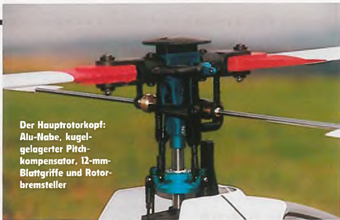
Sehr aufwendig ist die Parallelogramm-Ansteuerung der Taumelscheibe, die Steuerverfälschungen auch bei großen Pitchwegen verhindert
