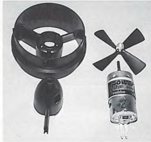
Der Rojet 410 dient als Antrieb. Im Neuhelftenkatalog steht zwar ein anderer Antrieb - geliefert wurde uns (auch nachdem wir nachgefragt hatten) der Rojet 410 mit dem 12-V-Motor. Damit liefert er laut Herstellerangaben 290 Gramm Schub: das ist bei der Gnat knapp vor dem Herunterfallen.
