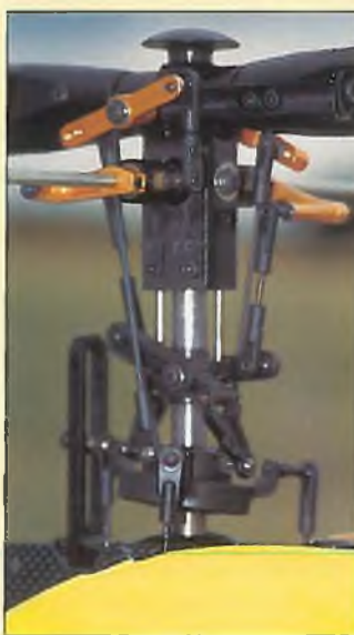
Der Hauptrotor des X-Cell, ganz in Metall und mit exzellenten Flugeigenschaften.
