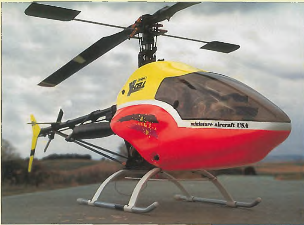
▲ Das Original-Kufenlandegestell ist sehr niedrig, so daß das Heck bei etwas unebenem Gelände ständig hinten aufsteht. Daher wurde ein zufällig vorhandenes Kufenge- stell eines Concept 60 von Kyosho verwendet, das erheblich mehr Bodenfreiheit bringt.
