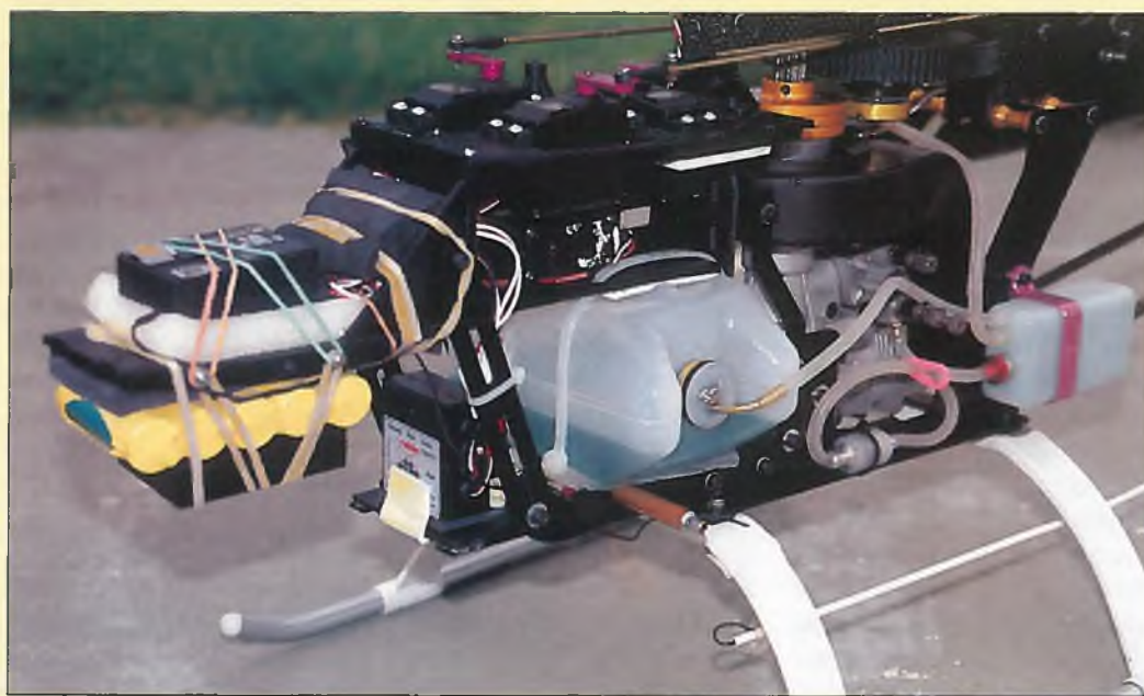
Die Elektronikaufgabe muß wegen ihrer Position beidseitig bestückt werden. Sie ist nirgends zusätzlich abgestützt und dürfte, wie allerdings auch bei vielen anderen Hubschraubern, eine teure Knautschzone im Falle eines Absturzes abgeben. Hier ist bereits der Kunstflugtank von Graupner eingebaut, ebenso ein zusätzlicher header tank hinten rechts.
