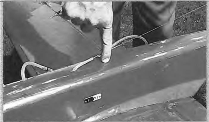
So kann man mit dem Fingernagel die Vibrationsstärke am gesamten Modell ertasten. Die gezeigte Zone am Rumpf ist vibrationsarm, weil hier der Schwingungsknoten liegt. Hier baut man die Sensibelchen, wie beispielsweise die Empfänger ein.
