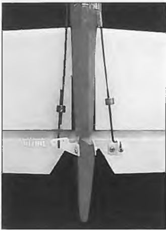
Das Steuergestänge des ELV-„Spatz“ wird mit Stellringen justiert.
