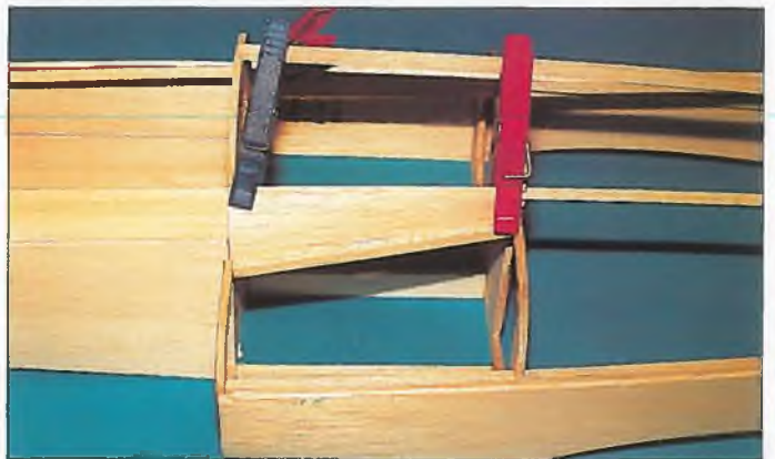
▲ Auch kleine Segmente können beim Beplanken vorkommen. Ein Fixieren mit Klammern ▼ ist hier aufgrund der Wölbung erforderlich.
