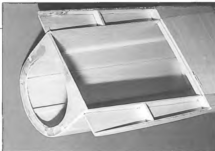
Die Rumpferweiterungen werden nach eigenem Ermessen angepaßt und hinten an der Höhenruderauflage nicht beplankt.
