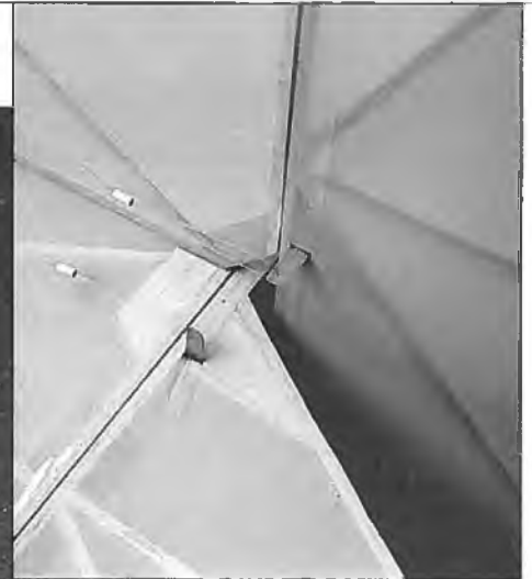
▲ Die Anlenkung der Ruder erfolgt mit dünnen Nylonfäden auf beiden Seiten.
