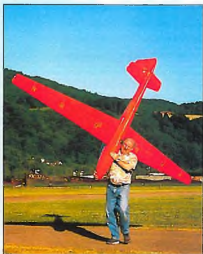
Ein Kofferraummodell ist der Lunak nicht; bei 4390 mm Spannweite und einem Gewicht von 9600 g muß man schon ordentlich zupacken.
