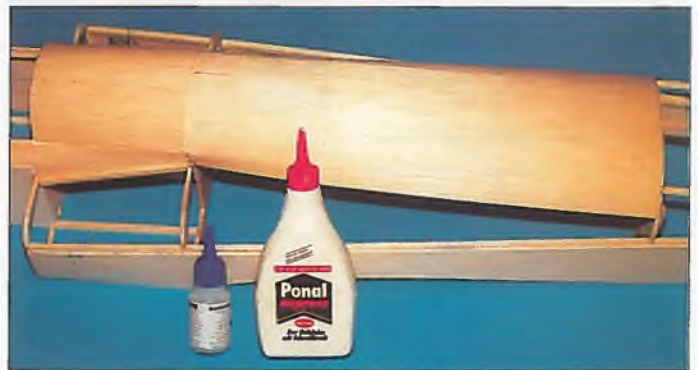
Die Beplankung beginnt oben und zwar segmentweise. Sekundenkleber und Weißleim sind dabei zwei gute Partner. Ich habe weiches Holz verwendet, um ein Anfeuchten zu vermeiden.
