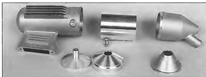
Das Innenleben des Schalldämpfers – die beiden Drehteile im Vordergrund links sind für den Interferenzeffekt zuständig.
