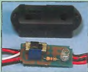
Die Platine des Schalterkabels. Der Eingang vom Akku ist ein vieradriges Kabel mit Doppelstecker. Zum Empfänger geht es mit zwei getrennten Steckerkabeln.
