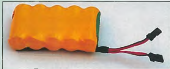
Den Akku mit zwei Anschlüssen muß man sich leider noch selbst machen.
