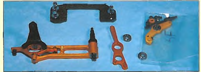
Für die mechanische Taumelscheibenanlenkung sind extrem hochwertige Alu-Früsteile vorgesehen, die aber bei diesem Modell der elektronischen 3Punkt-Anlenkung zum Opfer fielen.
