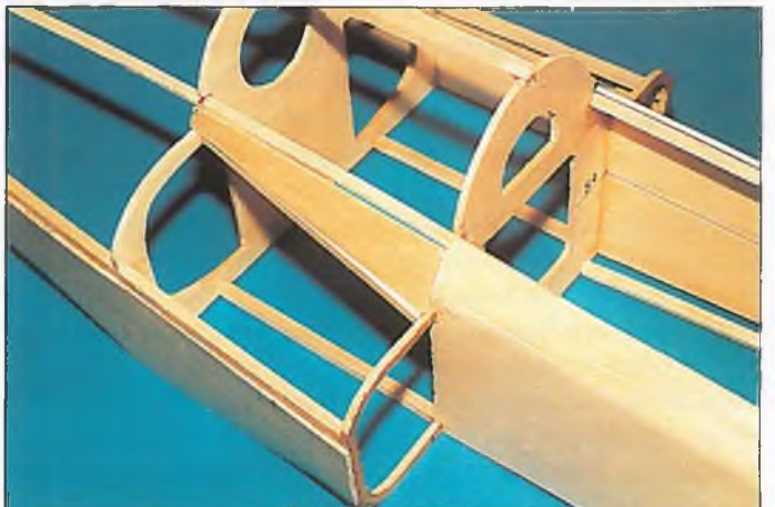
▲ Auch kleine Segmente können beim Beplanken vorkommen. Ein Fixieren mit Klammern ▼ ist hier aufgrund der Wölbung erforderlich.
