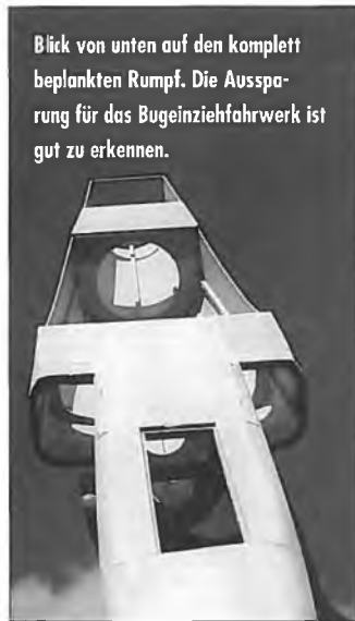
Die Rumpferweiterungen werden nach eigenem Ermessen angepaßt und hinten an der Höhenruderauflage nicht beplankt.
