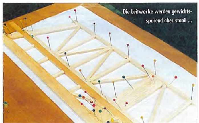
Aufbau des Rumpfbodens auf dem Baubrett. Die Breite des Rumpfes richtet sich nach den verwendeten RC-Komponenten.
