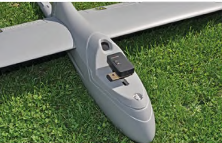
Perfekte Sicht. Dank Mittelmotor gibt es keine störenden Propellerstreifen im Bild.
