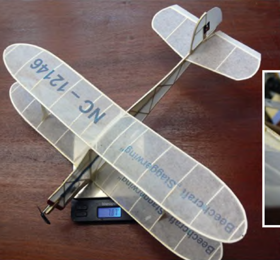
Die Beechcraft Staggerwing mit Siverlit-Direktantrieb nach einem Plan von Al Lidberg (SamsModels), Fluggewicht 7,8 g.
