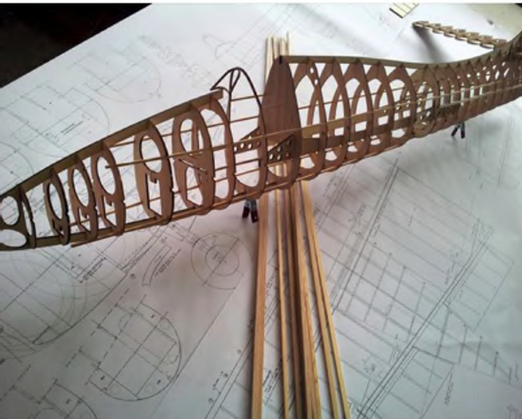
Die Qualitätskontrolle und Passprobe ist obligatorisch, nachdem ein Basis-Bausatz das erste Mal die Maschine verlässt – am Beispiel dieses Tigercat-Rumpfes ist zu sehen, was unter dem Begriff Basisbausatz zu verstehen ist.
