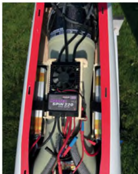
Die Akkus liegen im Bereich des Schwerpunktes neben den Einlaufkanälen – der Regler ist direkt auf dem Kanal montiert und mit einer Zwangskühlung ausgestattet.
