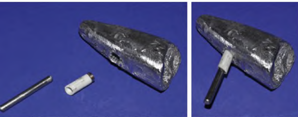
So funktioniert die im Text beschriebene Magnetfixierung des Flitschenhaken.
