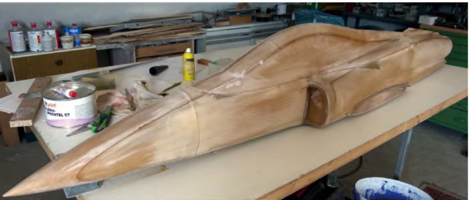
Das Urmodell des Rumpfes – fertig verklebt und gespachtelt.
