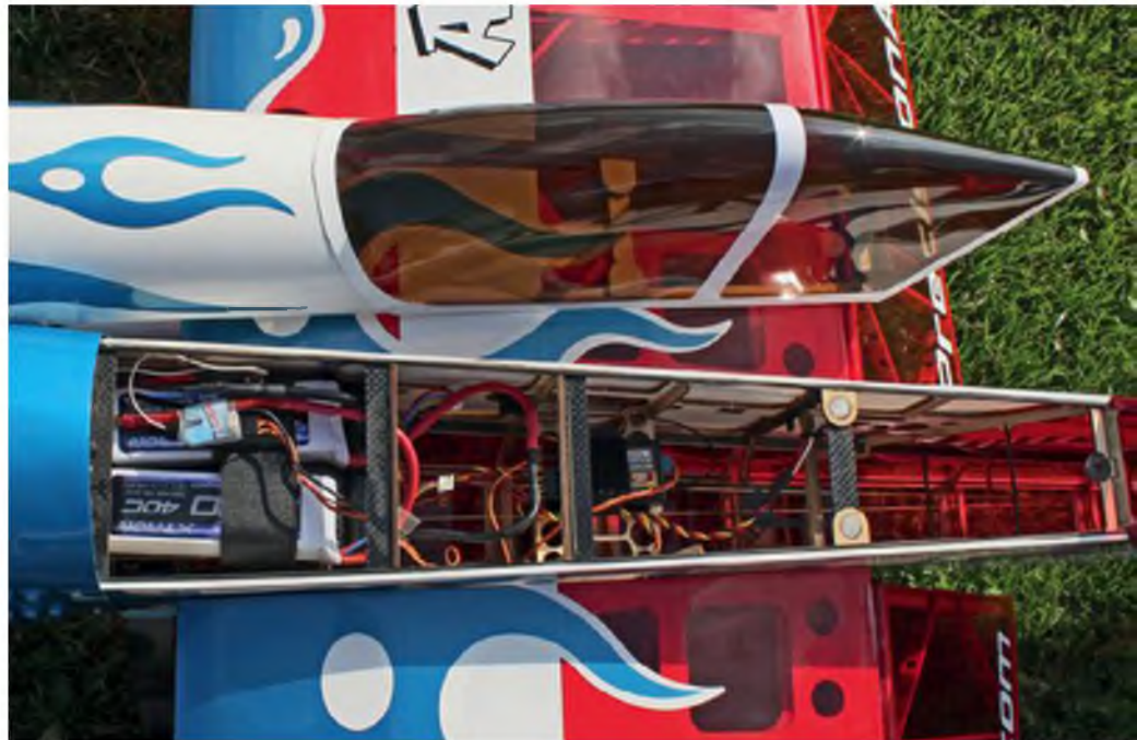
Die Fiber-Fusion-Bauweise ist sehenswert – die CFK-Verstärkungen vermitteln einen hochwertigen und edlen Charakter.
