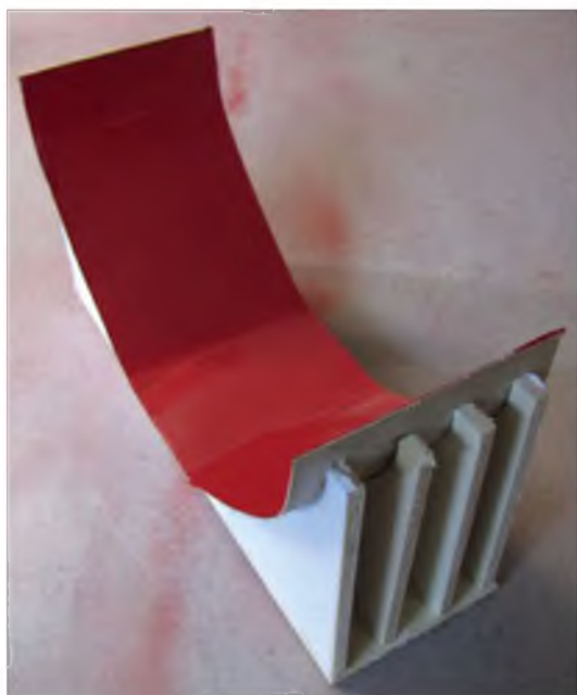
Bild 2: Aus vier Form-Spannten entsteht mit wenig Aufwand eine Laminier-Form.
