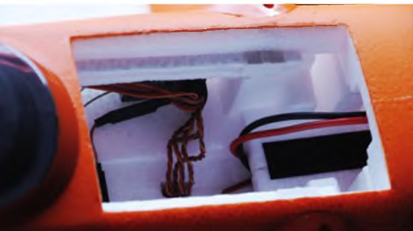
Das Akkufach (rechts im Bild) kann man gut erreichen. Den Empfänger habe ich mit doppelseitigem Klebeband an der linken Rumpfseite befestigt.
