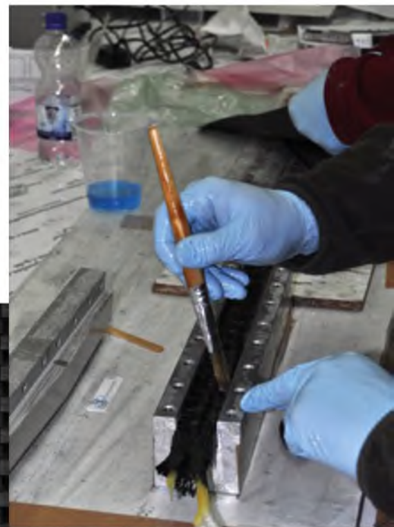
So wird ein Verbinder gemacht und in den Flügel eingebracht. Schön, dass man so was auch mal selbst sehen kann.
