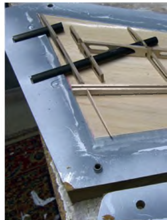
Das Innenleben des HLW vor dem Verkleben – die Steckung wird in der Form ausgerichtet.
