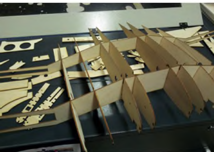
Verarbeitet wird ausgesuchtes Flugzeugsperrholz und Balsa – hier Teile einer Corsair.
