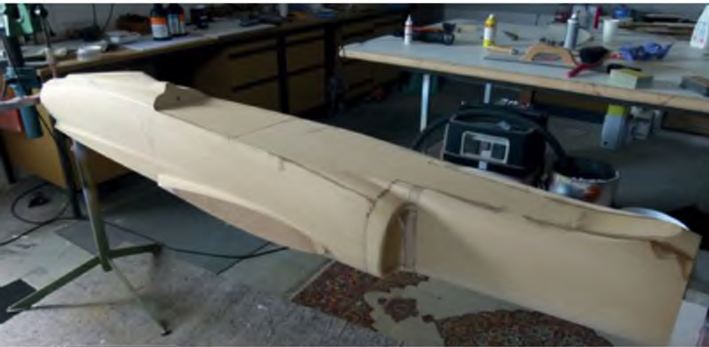
Rumpfspitze und Kabinenhaube werden als separate Bauteile gefertigt.
