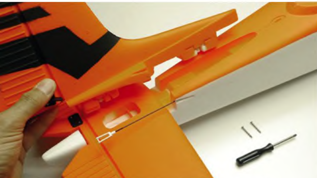
Die Leitwerksteile werden mit zwei Schrauben am Rumpf befestigt. Genau ausgeführte Passungen sorgen für einen festen und geometrisch korrekten Sitz.
