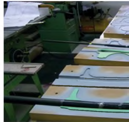
Auch die Spanten werden in Formen gefertigt.
