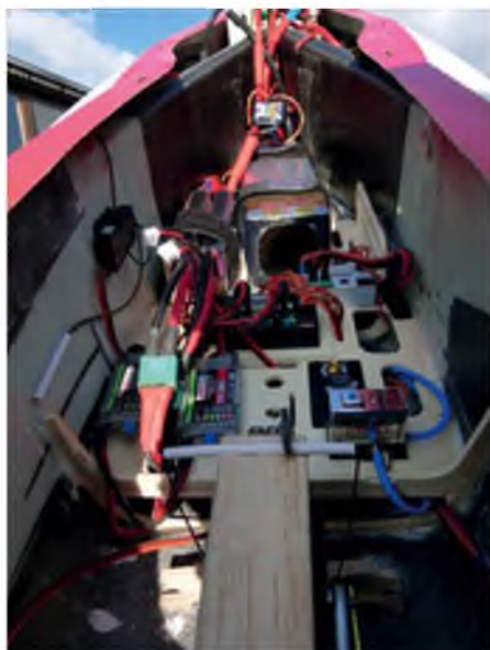
Der Raum für die RC-Ausrüstung zwischen Bugfahrwerk und den Einlaufkanälen ist reichlich bemessen.
