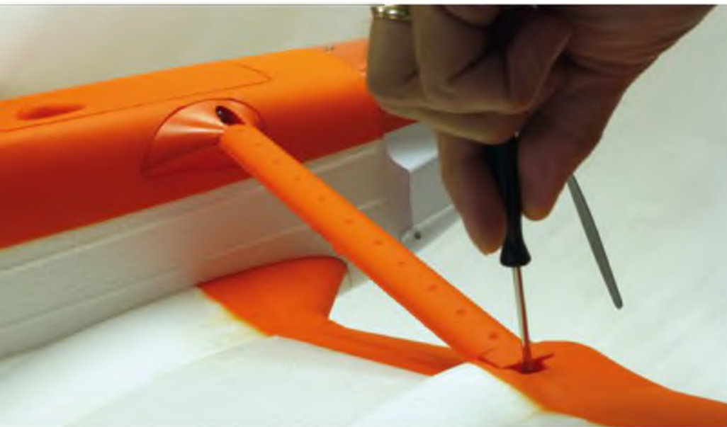
Die Tragflächenstreben werden mit kleinen Kreuzschlitzschrauben befestigt. Ein Schraubendreher mit magnetisierter Spitze erleichtert es, die Schrauben einzuführen.
