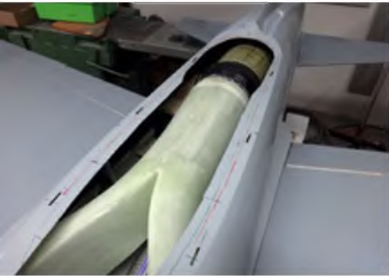
Die Luftführung ist komplett geschlossen, der Querschnittsverlauf ist optimal gestaltet.
