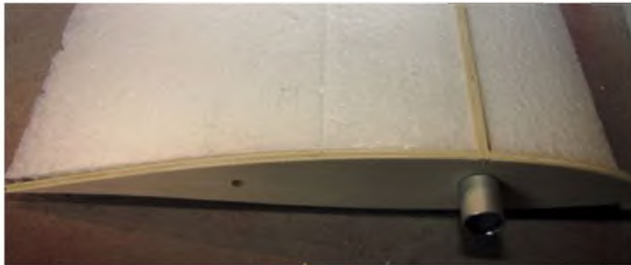
Bild 9: Wurzelrippe mit verzapftem Pappelsperrholz-Steg und Steckungsrohr
