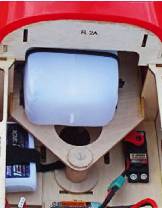
Der Tank sitzt auf einem demontierbaren Trägerbrettchen.
