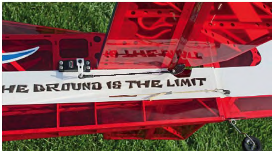
Das Höhenruderservo sitzt im Heck – die Ruder-Anlenkung erfolgt beidseitig mit Kugelköpfen.
