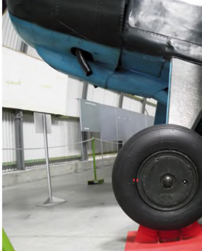
Das Hauptfahrwerk ist sehr robust konstruiert und hat hydraulisch gebremste Räder mit 600 mm Durchmesser.
