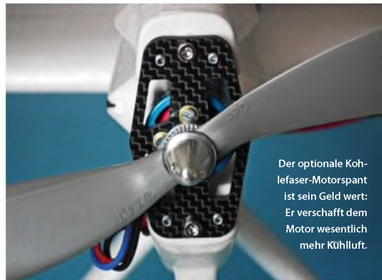
Mitgeliefert wird der bekannte Kunststoffspant für kleine Himax-Motoren (rechts). Optional gibt es einen Spant aus Kohlefaser, der sehr empfehlenswert ist.
