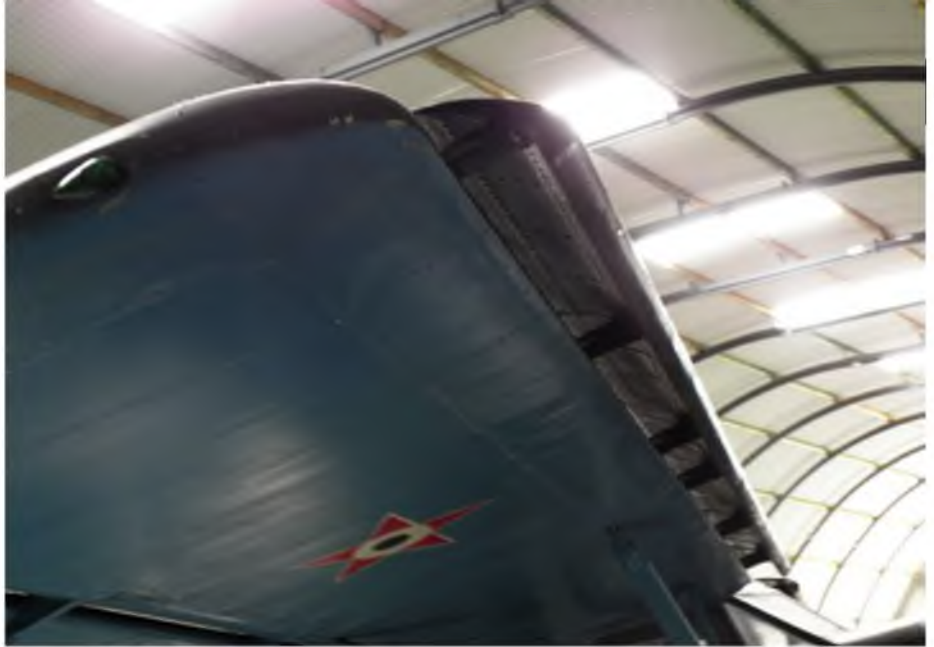
Die nicht steuerbaren, über die ganze Spannweite laufenden Vorflügel sind mitverantwortlich für die Gutmütigkeit und Langsamflug-Kompetenz der Jak-12.
