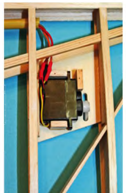
Die Teilbeplankung der Tragflächen hält sich in Grenzen. Die Stabilität wird auch durch die Verkastung und die Querstreben erreicht.
