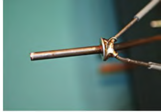
Der Fahrwerksdraht wird mit Bindedraht an den Fahrwerksstreben befestigt und anschließend verlötet.
