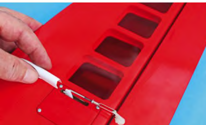
... und mit vier Schrauben in der Tragfläche versenkt. Optisch und technisch einwandfrei! Und wer es noch ganz schön machen will, klebt mit ein paar Tropfen Sekundenkleber eine Gestängeabdeckung auf.
