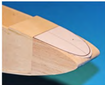
Für das Aufleimen der zweiten Rumpfseite sind kräftige Gewichte eine gute Sache.
