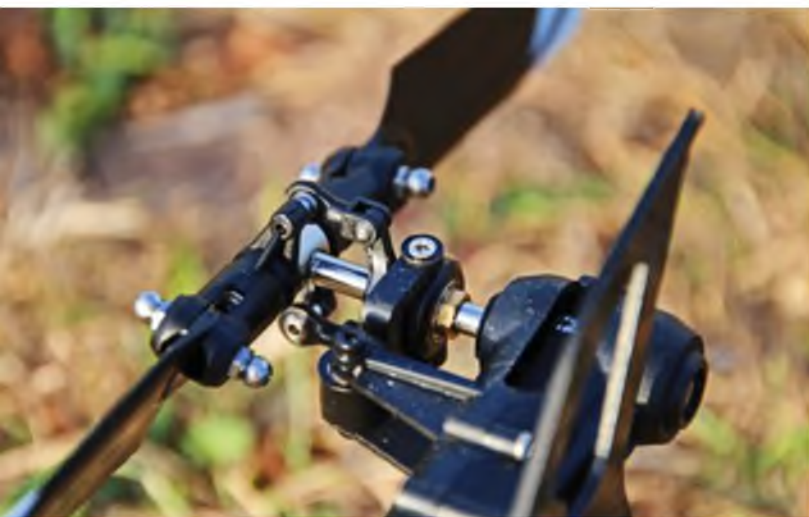
Neben dem Chassis sind beim Blade 360 CFX auch die Hauptrotorblätter sowie das Höhen- und das Seitenleitwerk serienmäßig aus CFK gefertigt.
