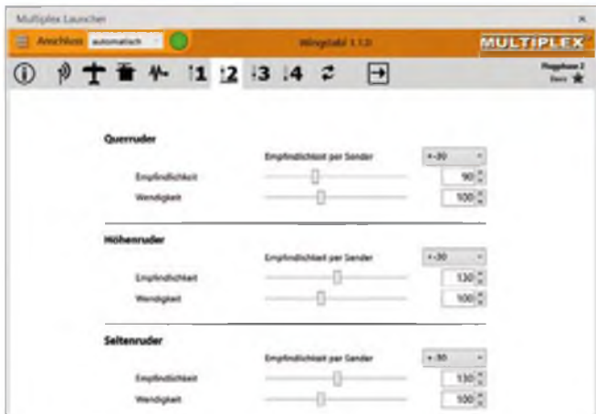
Die Basiseinstellungen, hier die Flugphase 2, sind mit wenigen Schieberbewegungen oder direkten Zahleneingaben rasch erledigt.
