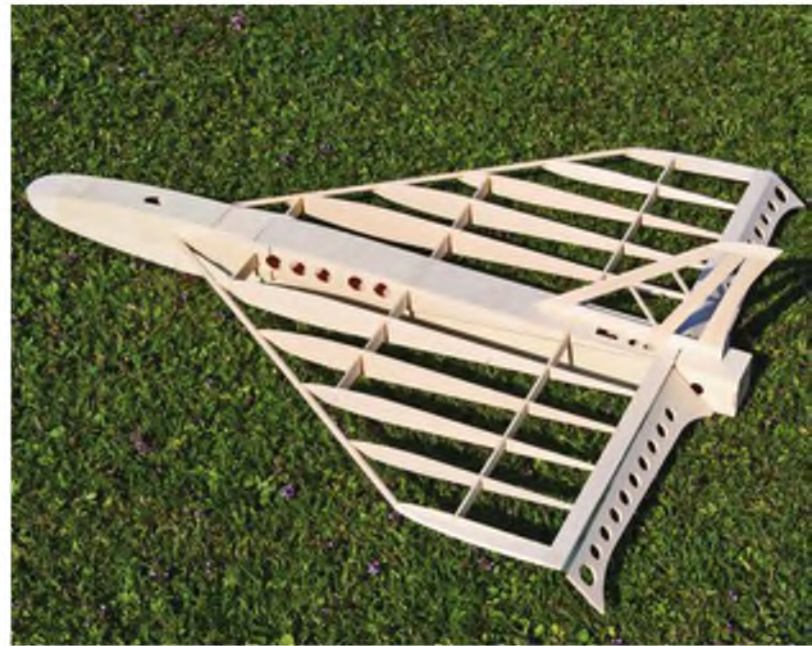
Die Teile der Seitenflosse. Das Seitenruder ist nicht angeleimt.
