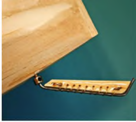
Der Sporn ist frei beweglich und kann mit dem Seitenruder gekoppelt werden.
