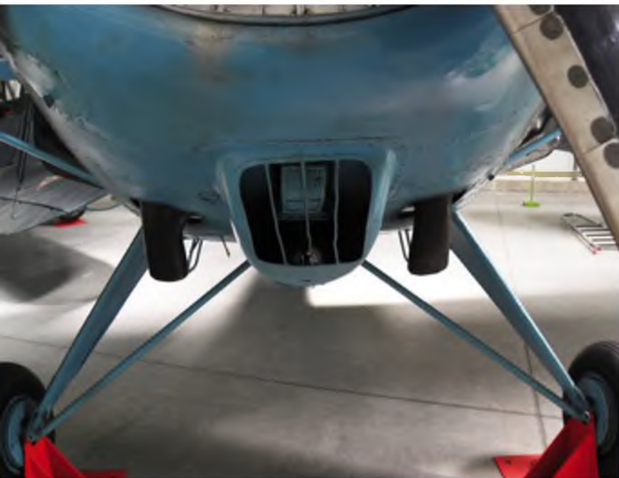
Das Hauptfahrwerk ist sehr robust konstruiert und hat hydraulisch gebremste Räder mit 600 mm Durchmesser.
