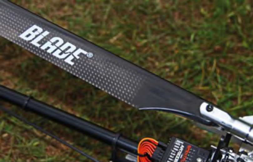
Neben dem Chassis sind beim Blade 360 CFX auch die Hauptrotorblätter sowie das Höhen- und das Seitenleitwerk serienmäßig aus CFK gefertigt.
