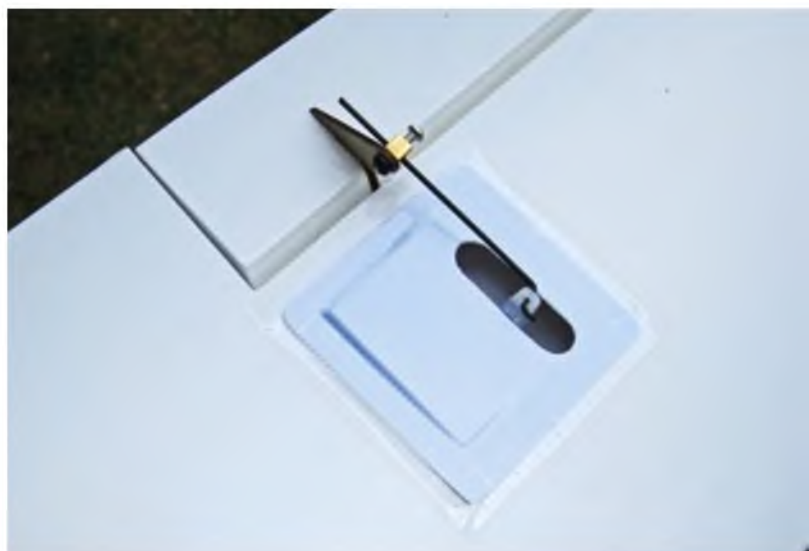
Die Flächenservos sind beim Rx-R-Modell inklusive Anlenkungen fertig eingebaut.
