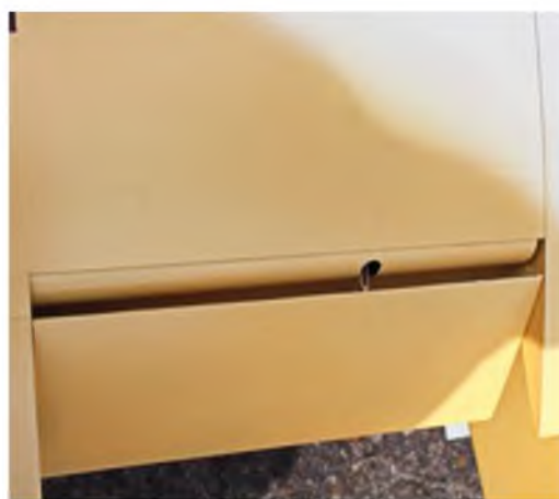
Die Landeklappenservos werden in der Tragfläche in den Stützrippen verschraubt. Die Anlenkung zur Landeklappe wird mit einer 3-mm-Gewindestange im Flächeninneren ausgeführt. Die Ruderhörner sind in den Landeklappen schon vom Hersteller eingeklebt.
