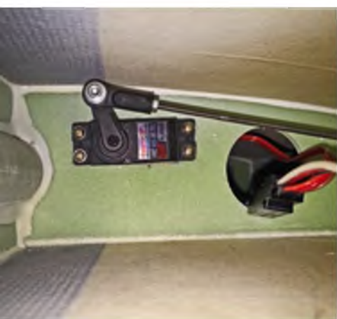
Die Landeklappenservos werden in der Tragfläche in den Stützrippen verschraubt. Die Anlenkung zur Landeklappe wird mit einer 3-mm-Gewindestange im Flächeninneren ausgeführt. Die Ruderhörner sind in den Landeklappen schon vom Hersteller eingeklebt.
