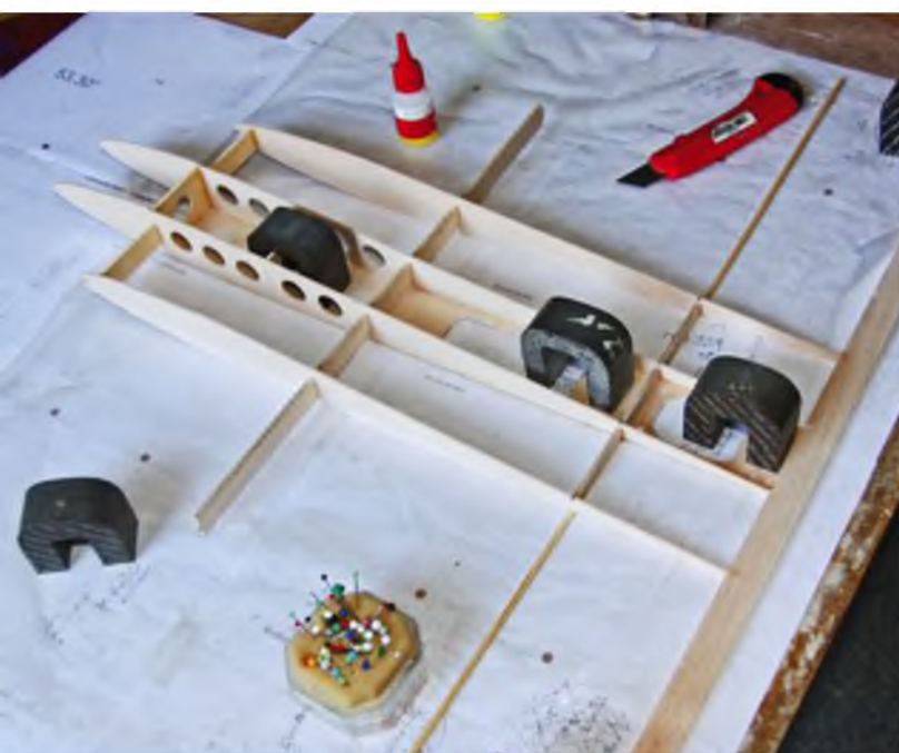
Die Wurzelkonstruktion ist zusammen mit Holm- und Endleiste auf dem Baubrett fixiert, Rippe für Rippe wird nun aufgefädelt. Der mittige Balsa-Hilfsholm wird noch nicht verklebt und bleibt erst einmal lose eingesteckt.
