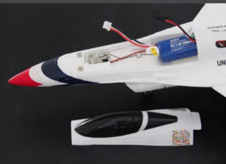
Nicht zum Lieferumfang des BNF-Basic-Modells gehört der 2s-280-mAh-LiPo. Das Bugrad ist lenkbar.
