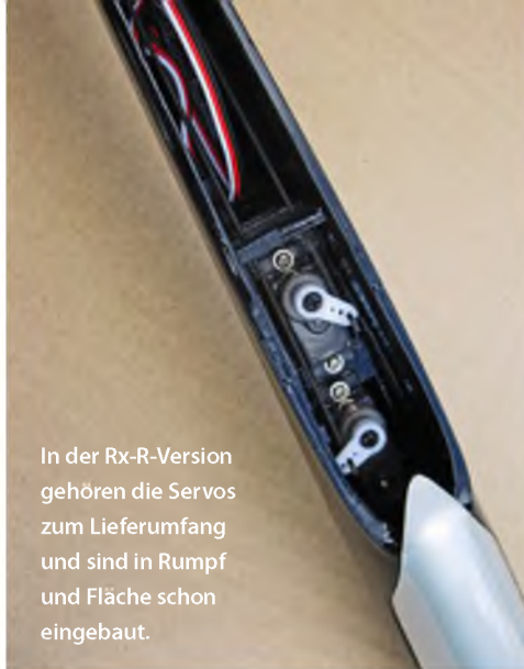
Die Flächenservos sind beim Rx-R-Modell inklusive Anlenkungen fertig eingebaut.
