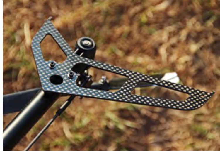
Neben dem Chassis sind beim Blade 360 CFX auch die Hauptrotorblätter sowie das Höhen- und das Seitenleitwerk serienmäßig aus CFK gefertigt.
