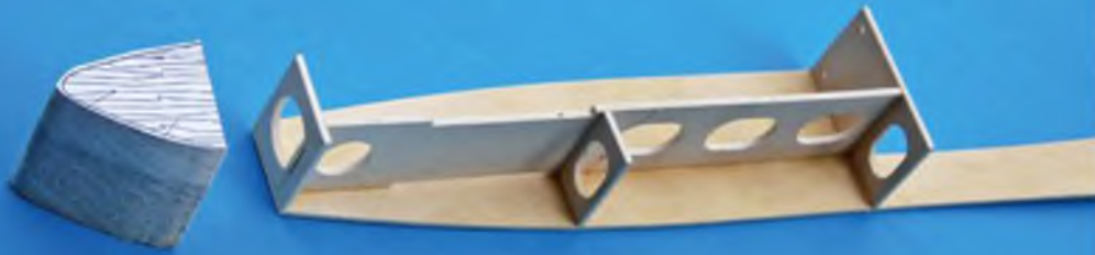
Alle Spanten werden auf eine Rumpfseite aufgeleimt. Hier das Vorderteil mit Akkubrett. Die Rumpfnase wird nach der Seitenansicht vorgeschritten.
