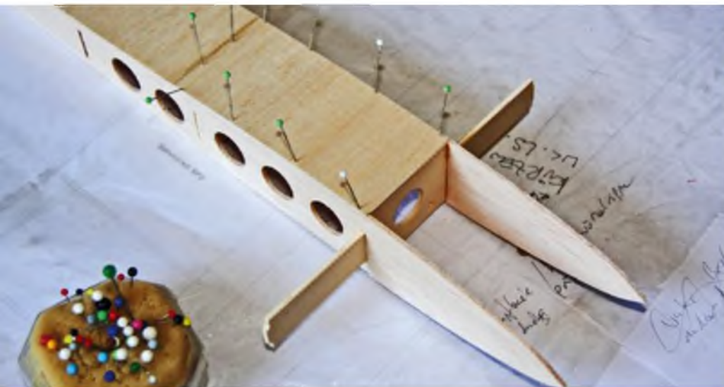
Die Teile der Tragfläche – hauptsächlich aus 2-mm-Balsa. Dazu kommen noch 3x3-mm-Kiefernleisten und eine Balsaleiste.
