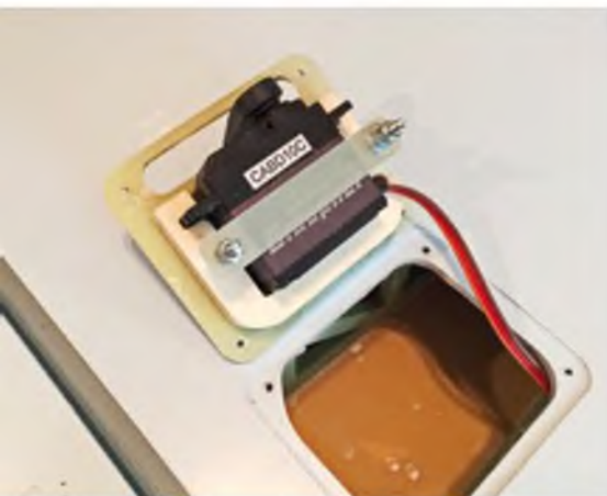
Die Querruderservo-Aufnahmen sind montagefertig. Die Anlenkungen sind mit 3-mm-Gewindestangen und Kugelköpfen ausgeführt.
