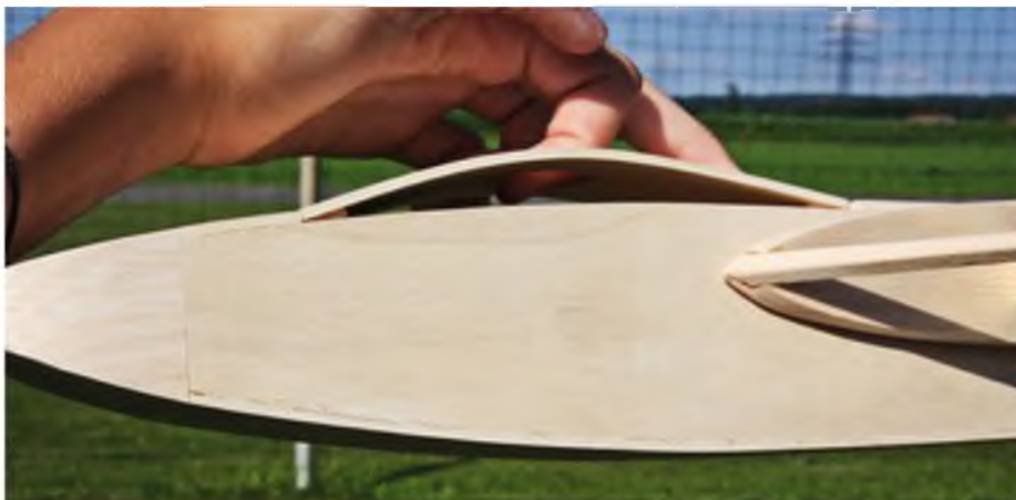
Mit aufgesetzter Tragfläche werden die Gewinde für die Tragflächenschrauben eingebohrt.
