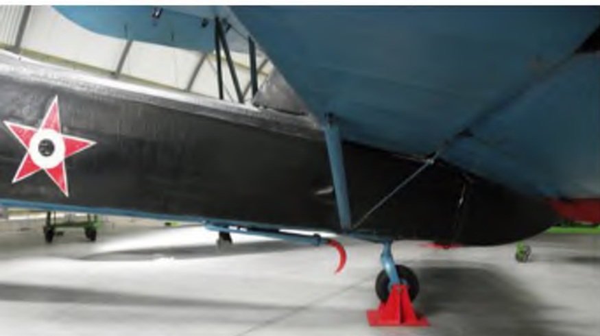
Das Hauptfahrwerk ist sehr robust konstruiert und hat hydraulisch gebremste Räder mit 600 mm Durchmesser.
