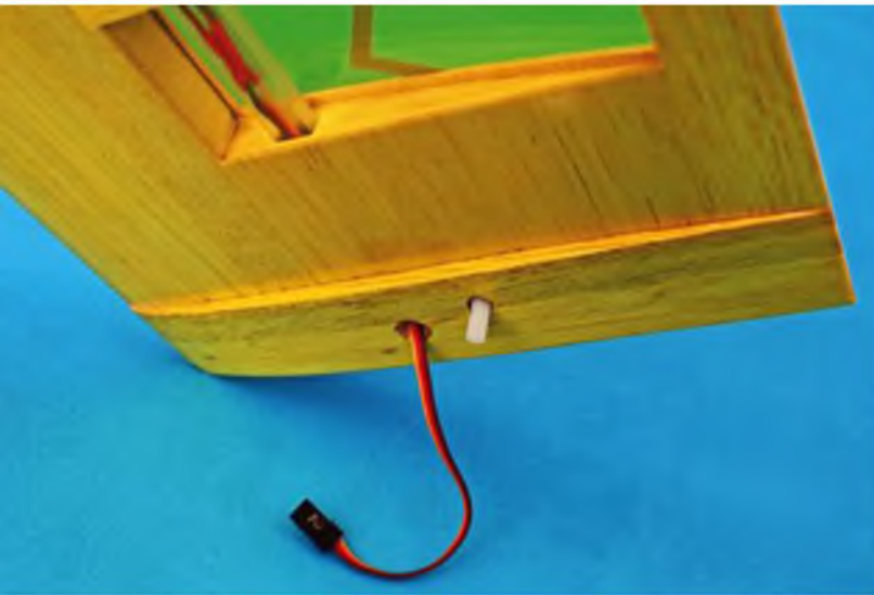
In die Profilanformung müssen nur noch die Durchgangsbohrungen für das Querruder und die Schraube zur Tragflächenbefestigung gebohrt werden.
