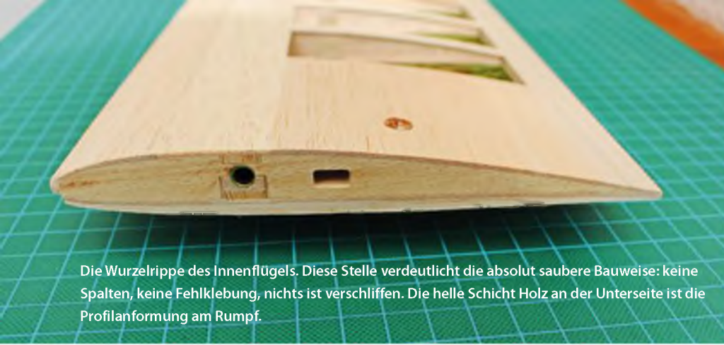
In die Profilanformung müssen nur noch die Durchgangsbohrungen für das Querruder und die Schraube zur Tragflächenbefestigung gebohrt werden.
