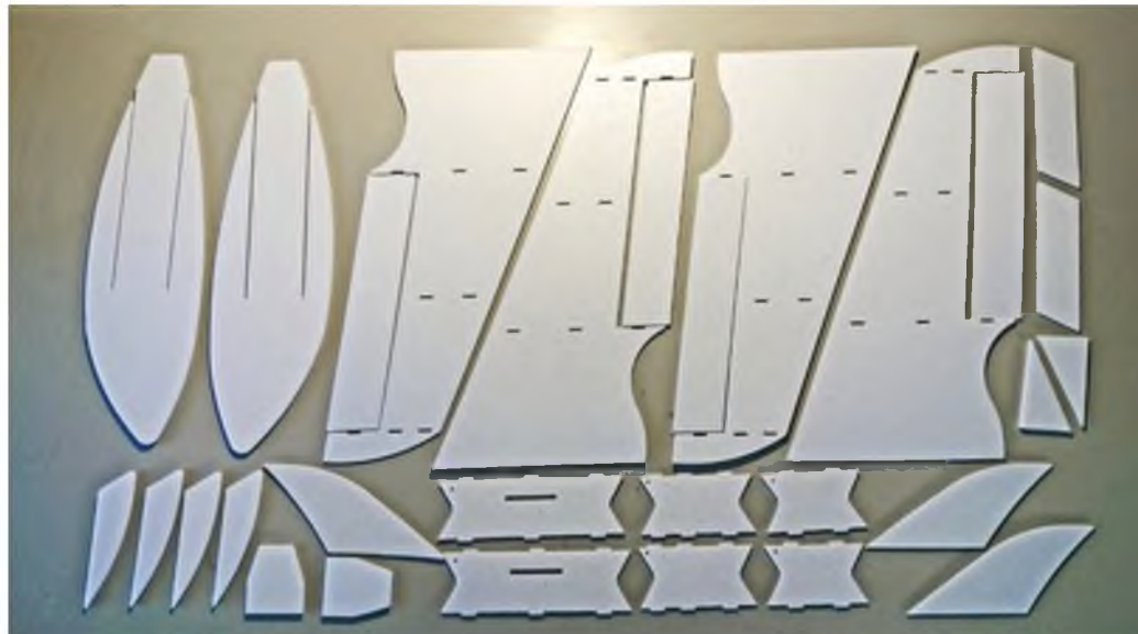
Die fertig ausgeschnittenen Depronteile des Sharky Boxwing, hier aus dem erhältlichen Frästeilsatz, der den Bau beschleunigt.
