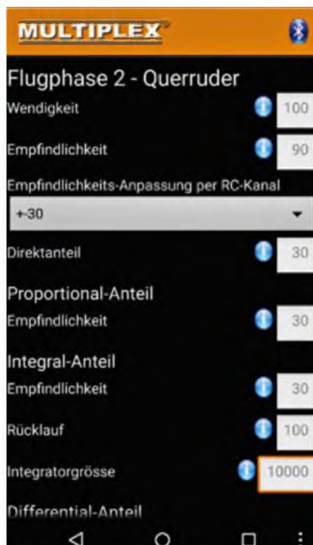
Zur Feinjustage des WingStabi kann man die Werte jeder Flugphase getrennt einstellen und so sein Kreisel-system optimieren.
