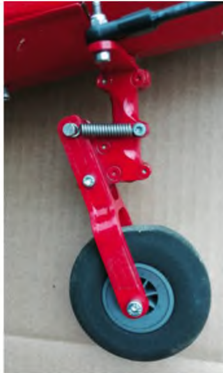
In der neuen Ausführung liegt die Radachse genau im Drehpunkt. Seitlich auf das Rad wirkende Kräfte führen nicht mehr zu dessen Auslenkung. Das Servo steht somit lastfrei.
