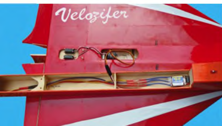
RC-Einbau: Servos und Empfänger in der Fläche, Regler im Rumpf direkt hinter dem Hauptspant. So bleiben die notwendigen Verlängerungskabel möglichst kurz. ▼
