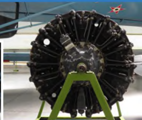
Angetrieben ist die Jak-12R durch einen 260 PS starken Neunzylinder-Sternmotor Iwtschenko AI-14R mit verstellbarer Luftschraube.
