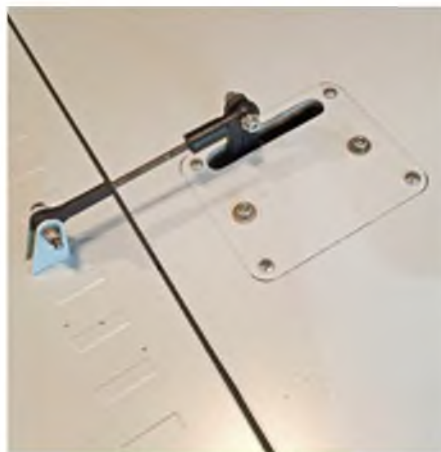
Die Querruderservo-Aufnahmen sind montagefertig. Die Anlenkungen sind mit 3-mm-Gewindestangen und Kugelköpfen ausgeführt.
