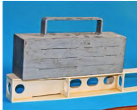
Für das Aufleimen der zweiten Rumpfseite sind kräftige Gewichte eine gute Sache.
