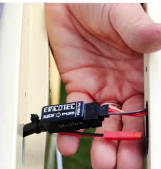
Die Höhenrudersteckung auf der linken Seite. Der kleine Stecker ist für die Lichtsteuerung des Antikollisions-Blitzers und der PWM-Adapter für das linke Höhenruderservo. In dem PWM-Adapter werden die digitalen Informationen für das Servo gespeichert, welche man mit der Software programmiert. Dadurch ist man nicht an einen Servohersteller gebunden, sondern kann jedes Fabrikat am S.BUS anschließen.
