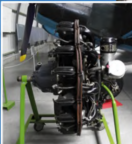
Angetrieben ist die Jak-12R durch einen 260 PS starken Neunzylinder-Sternmotor Iwtschenko AI-14R mit verstellbarer Luftschraube.
