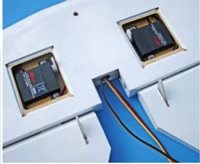
Das Höhenruder des Habicht wird kurz und direkt angelenkt, die Servos sitzen im Leitwerk.
