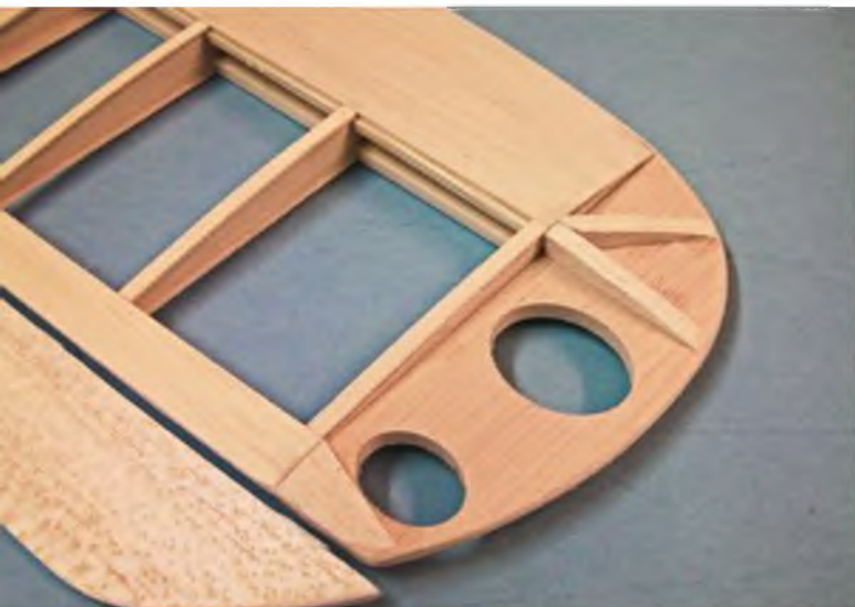
Der Randbogen mit Abstützung, fertig verschliffen.
