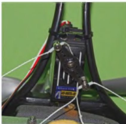
Das Beschleunigerservo kommt oben in den Käfig. Dafür sind bereits Löcher angebracht. Unten wird es verschraubt, oben mit einem Kabelbinder befestigt.
