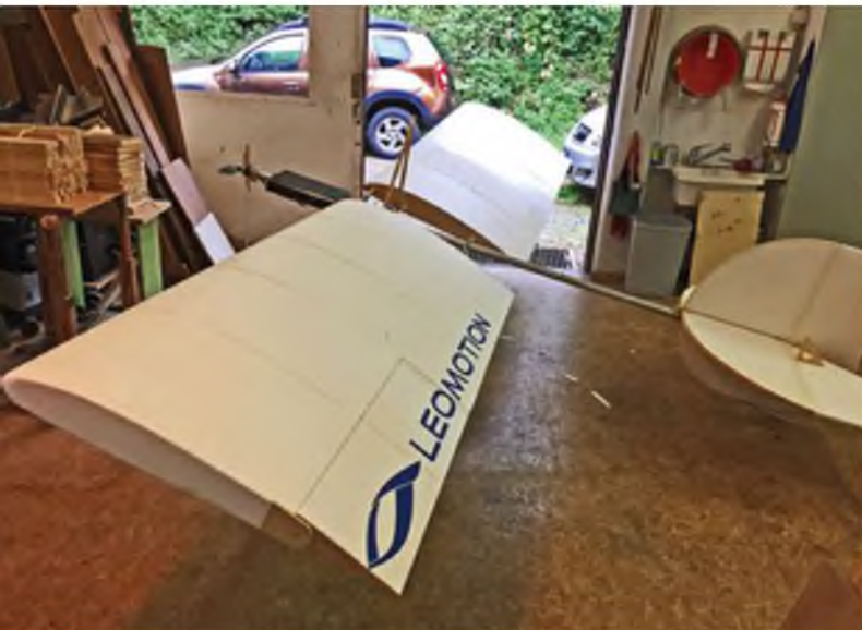
Das Flügelende ist im Bereich der Querruderachse mit einem 8-mm-Sperrholz abgedeckt, durch das die Holzschraube mit Schaft in das Querruder eingedreht wird.
