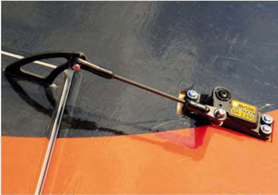
Einfach, leicht und spielfrei: die Ruderanlenkung mit Kugelköpfen und CFK-Stangen.
