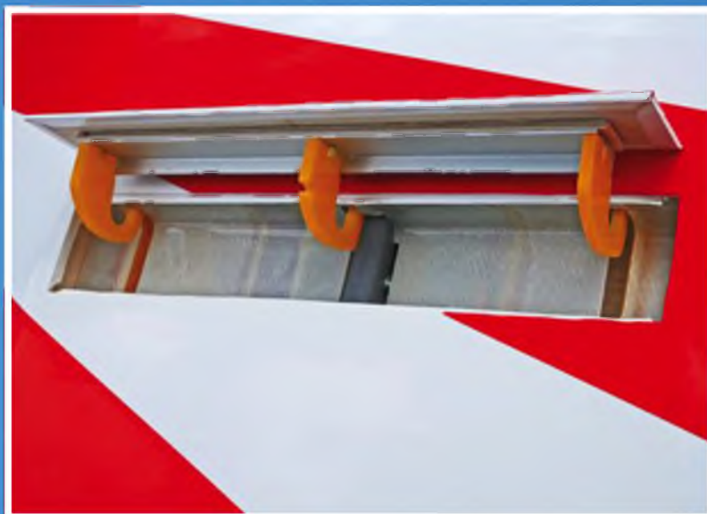
Die Dreh-/Störklappen sind funktionsfähig eingebaut, es müssen nur noch die Abdeckungen auf der Oberseite aufgeklebt werden.
