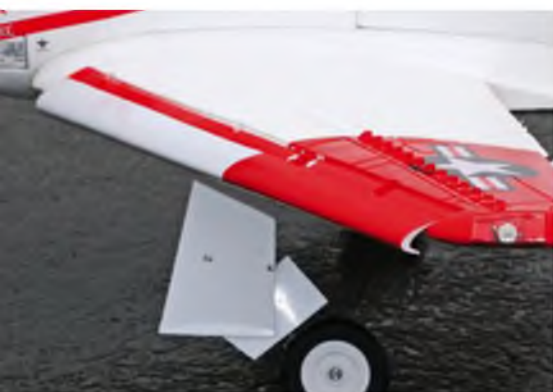
Die vorbildgetreu ausführenden Vorflügel sehen zwar unheimlich toll aus, haben aber keinen feststellbaren Einfluss auf die Flugeigenschaften.
