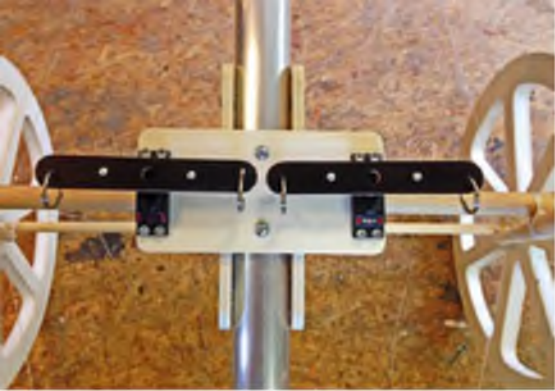
▲ Auf den Fahrwerkskonsolen sitzt das Servobrett. Die Höhen- und Seitenruderservos mussten wegen den langen Abtriebshebeln genug Abstand bekommen.
