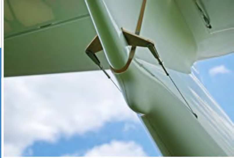
Die Ansteuerung des Seitenruders erfolgt beidseitig durch Fesselfluglitze.
