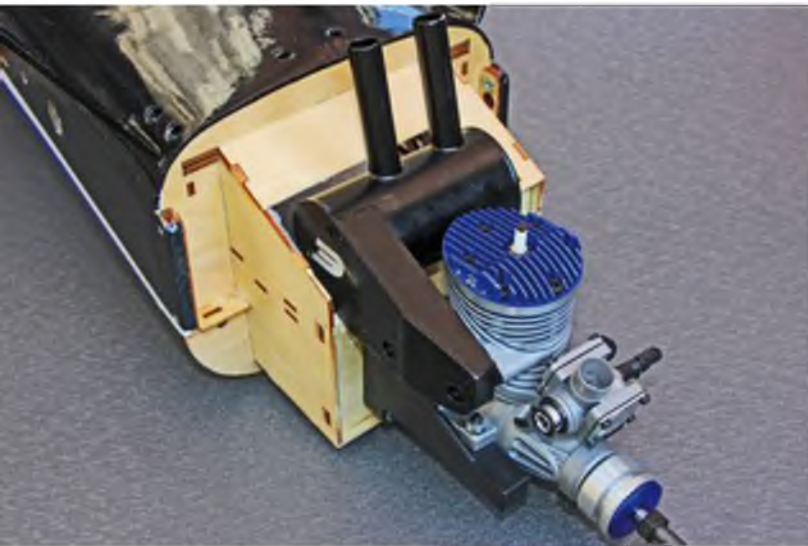
Der Motordom muss auf der Unterseite mit einer Aussparung versehen werden, um den Dämpfer des 20er Evos unterzubringen. Die Stabilität ist trotz der großen Öffnung immer noch ausreichend.
