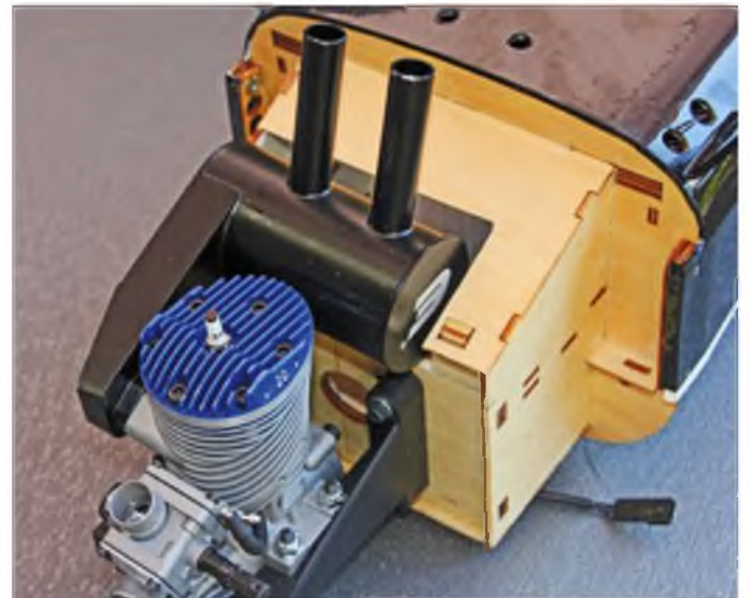
Der Motordom muss auf der Unterseite mit einer Aussparung versehen werden, um den Dämpfer des 20er Evos unterzubringen. Die Stabilität ist trotz der großen Öffnung immer noch ausreichend.
