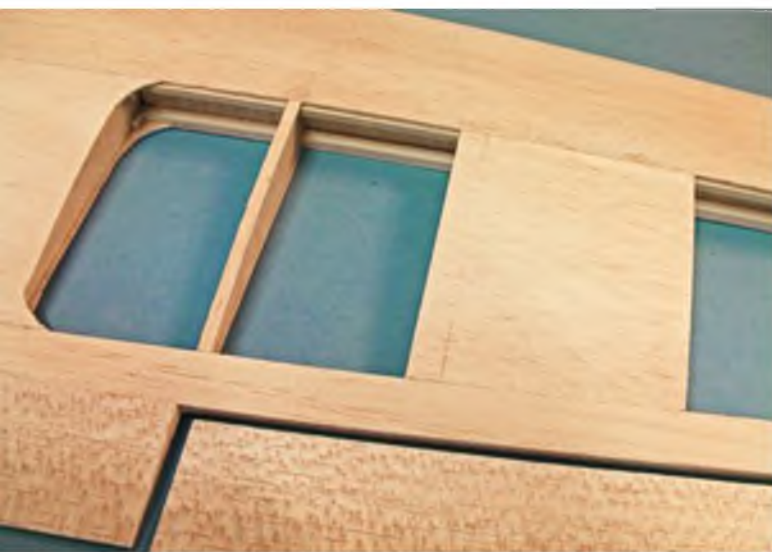
Der rohbaufertige Flügel.
