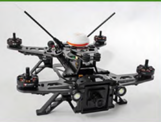
▲ Der Runner 250 im Auslieferungszustand. Es sind nur noch die Propeller und Klettband zur Befestigung des Antriebsakkus anzubringen, wofür kein Werkzeug erforderlich ist.
