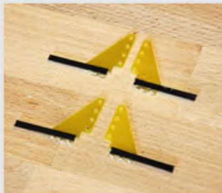
Wichtig ist es, den Ruderhörnern großflächig Halt zu geben und die Verbindung zwischen Gestänge und Ruder- bzw. Servohorn ausreichend stabil auszuführen.
