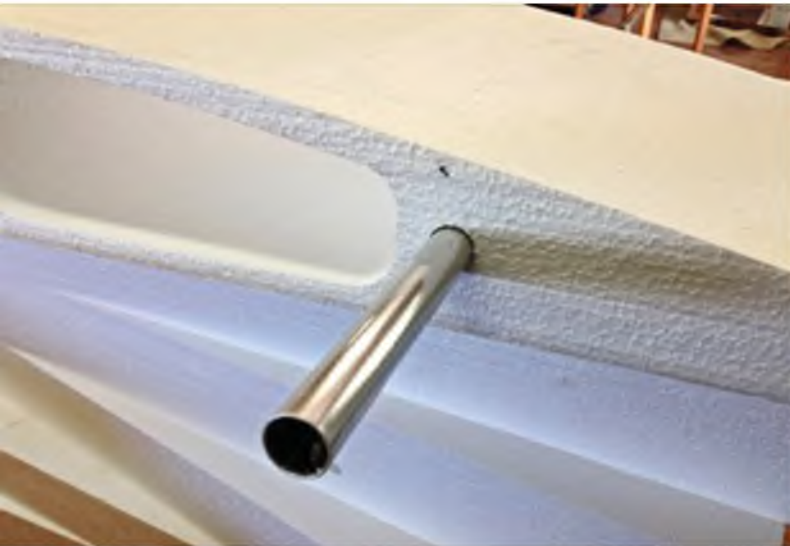
▲ Auf den Fahrwerkskonsolen sitzt das Servobrett. Die Höhen- und Seitenruderservos mussten wegen den langen Abtriebshebeln genug Abstand bekommen.
