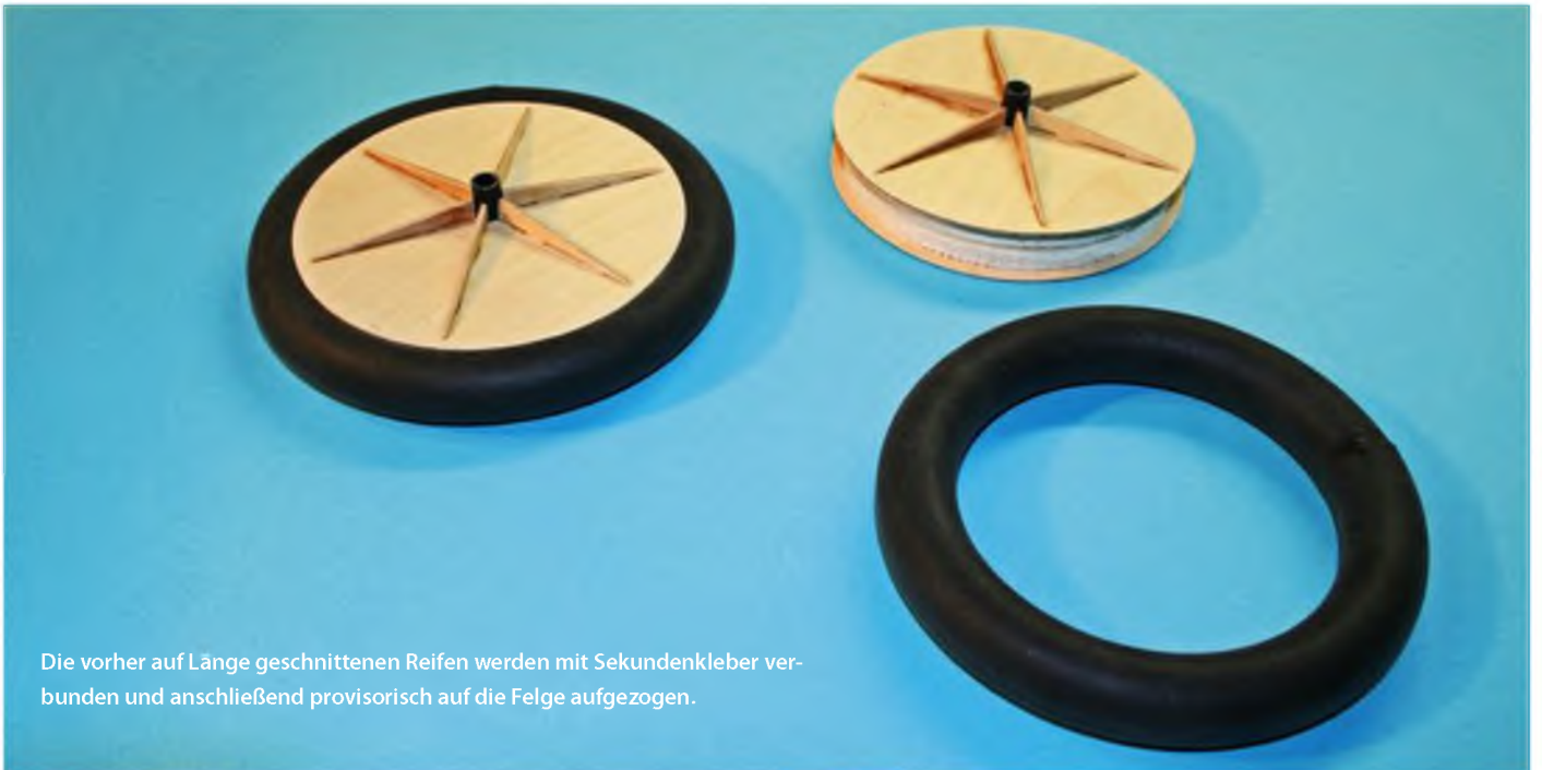
Insgesamt 6 Sperrholzspeichen werden nacheinander eingesetzt und mit Sekundenkleber gesichert.
