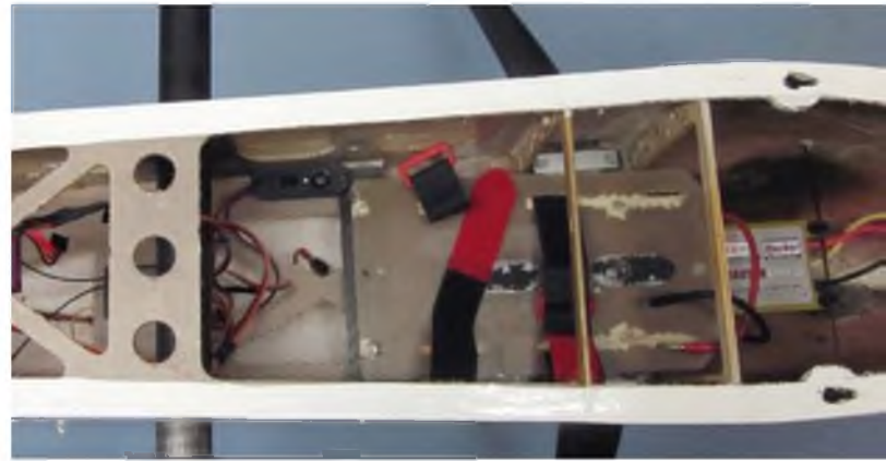
Das Akkubrett im Chinook besteht ebenfalls aus Wabensandwich – der Regler ist davor in der Rumpfmittle aufgehängt.
