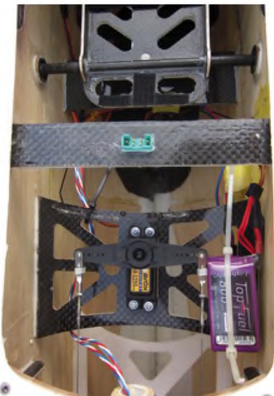
Das Seitenruderservo im Optimus. Der Rumpf ist als Balsa-Sandwich laminiert.
