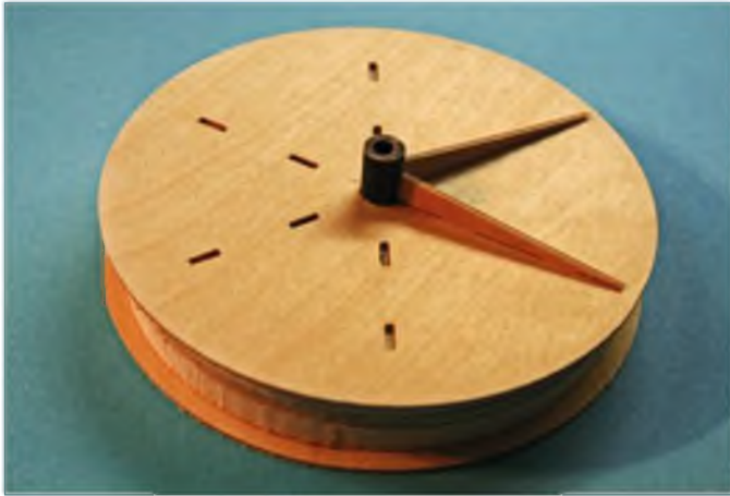
Insgesamt 6 Sperrholzspeichen werden nacheinander eingesetzt und mit Sekundenkleber gesichert.
