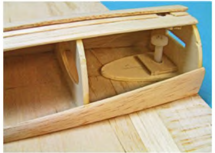
Ein Blick auf die Flächenverschraubung vor dem Beplanken.
