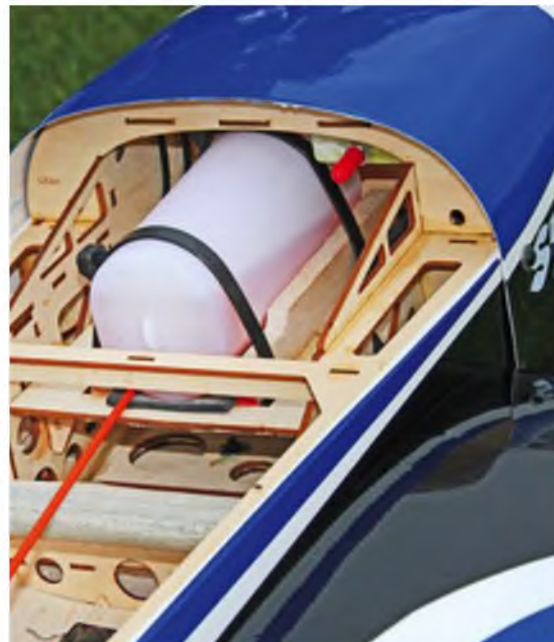
Zur Aufnahme des kleineren Tanks wurde das Akkubrett modifiziert, den Tankknippel platzierte ich direkt oberhalb des Tanks.
