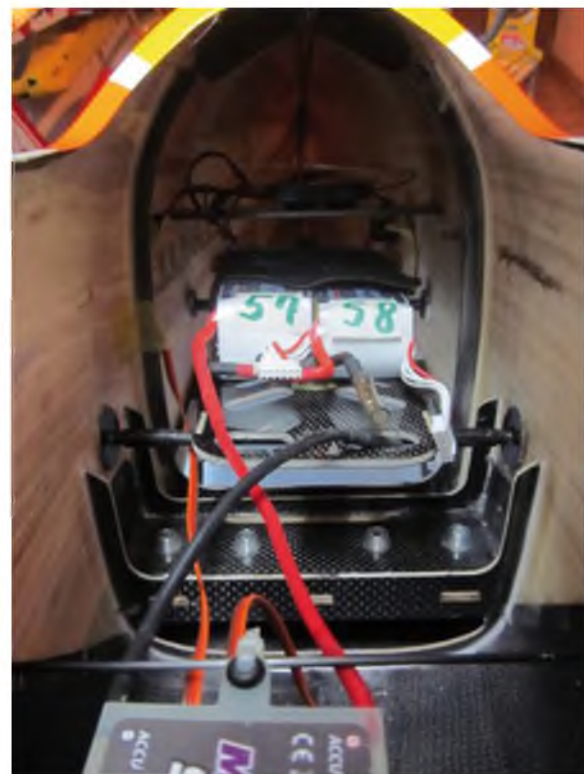
Das Akkubrett im Chinook besteht ebenfalls aus Wabensandwich – der Regler ist davor in der Rumpfmittle aufgehängt.
