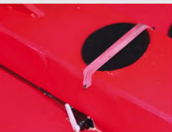
Die einfachste Möglichkeit, den Deckel geschlossen zu halten, ist ein Gummiring, der über einen durch den Rumpf laufenden CFK-Stab gespannt wird.
