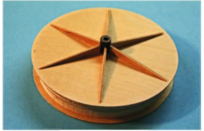
Insgesamt 6 Sperrholzspeichen werden nacheinander eingesetzt und mit Sekundenkleber gesichert.
