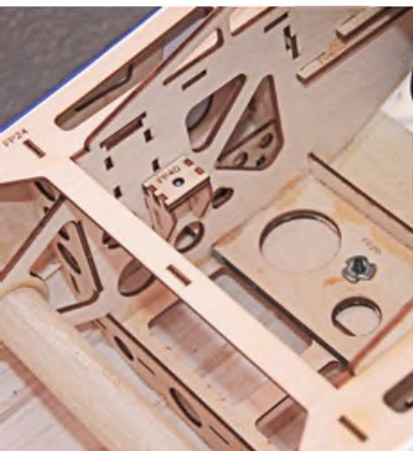
Im vorderen Bereich des Rumpfes befinden sich verschiedene Befestigungspunkte für das Akkubrett oder eine Tankhalterung.
