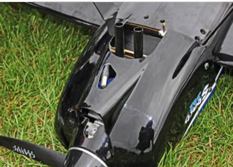
Der Motordom muss auf der Unterseite mit einer Aussparung versehen werden, um den Dämpfer des 20er Evos unterzubringen. Die Stabilität ist trotz der großen Öffnung immer noch ausreichend.
