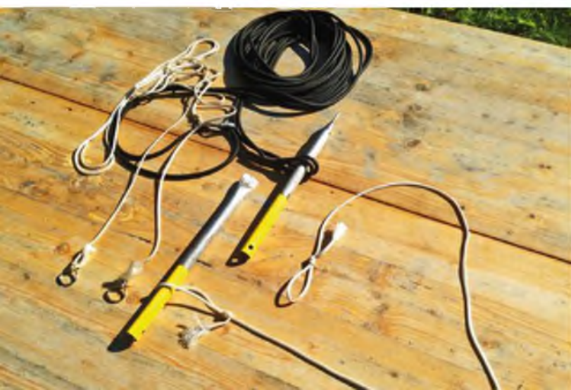
Das Start Equipment: Querbohrungen in den Pflocken erlauben das Einstecken in den Rasen mit einem Schraubendreher oder Ähnlichem, ein Hammer ist nicht nötig.
