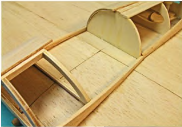
Die Halbspanten des Cockpits werden direkt auf der Fläche aufgebaut.
