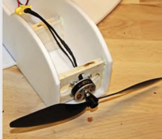
Der Motor wird einfach auf einem leichten Sperrholzspant verschraubt.
