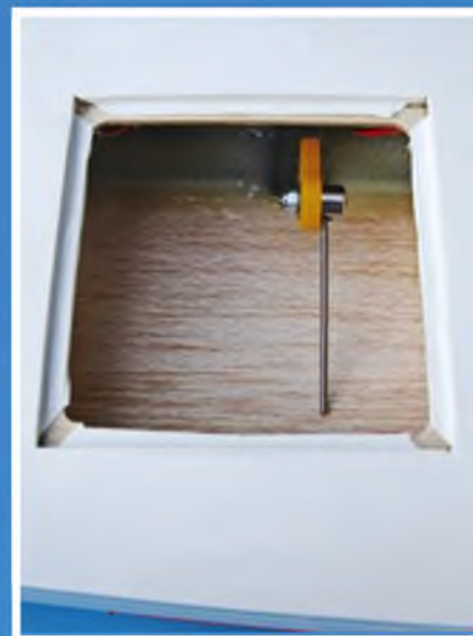
Hier ist die Anlenkung der Störklappen zu sehen. Der Anschluss am Servo ist noch zu erledigen.
