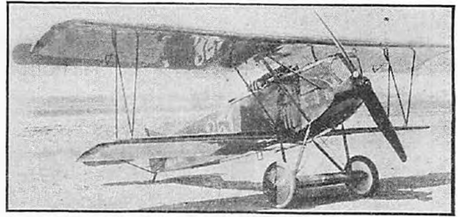
Fokker D.7. Speed 120 m.p.h. (Mercedes motor)
