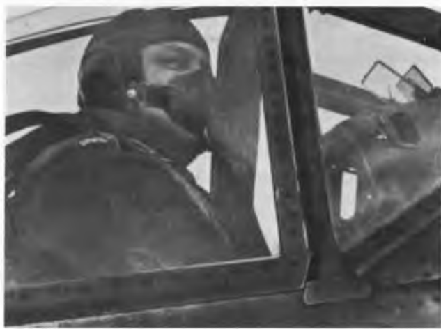
Attraverso il tettuccio è ben visibile la carenatura sovrastante il cruscotto ed i vetri del collimatore a riflessione Revi 16B. (Bundesarchiv).
