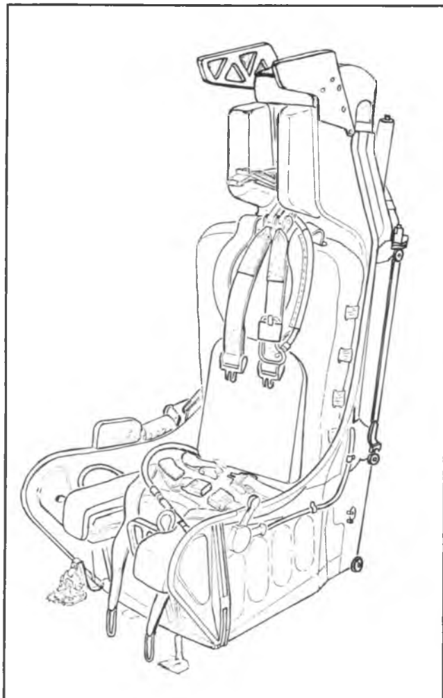
Il seggiolino eiettabile dell'A-10 è un Douglas Escapac. La colorazione è completamente in gray 36231, l'appoggiatesta e in colore nero, l'imbottitura dei cuscini in colore grigio 36231, le cinture in 36118 o 36440 o 33538 o 34092. I tubicini sono in nero con i terminali in colore argento.
