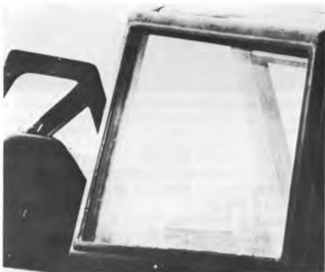
Primo piano dei pannelli addizionali in blindovetro tipici dei Rustsätze R7 ed R8: all'estrema sinistra in basso è visibile lo spigolo superiore della corazzatura addizionale esterna posta ai lati dell'abitacolo. (Bundesarchiv)
