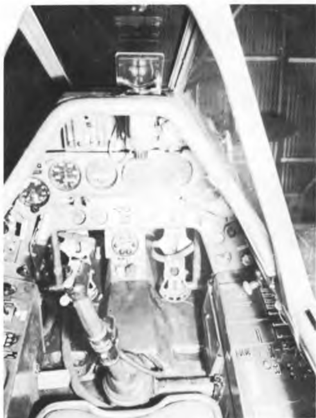
L'abitacolo del FW190 A-3; tranne l'aggiunta di alcuni strumenti, l'aspetto rimane pressoché invariato anche per tutte le varianti successive (Ministry of Defence)
