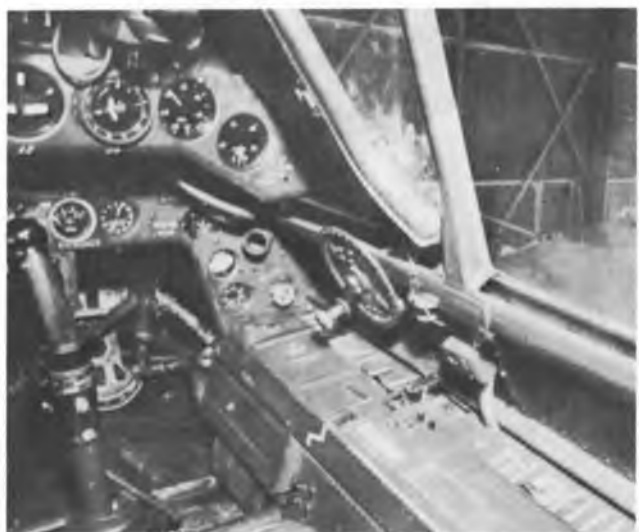
L'abitacolo del FW190 A-3; tranne l'aggiunta di alcuni strumenti, l'aspetto rimane pressoché invariato anche per tutte le varianti successive (Ministry of Defence)
