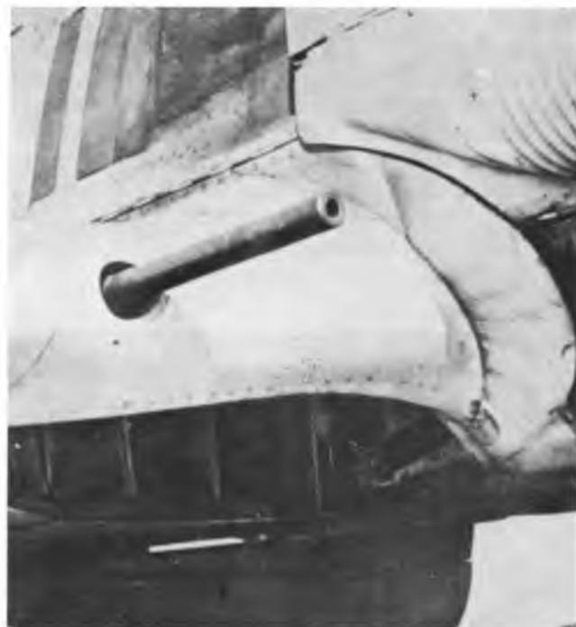
Questo dettaglio illustra chiaramente il pannello inserito fra la capottatura del motore e l'attacco alare presente su tutti i '190 dalla variante A-5 in poi, dovuta all'allungamento di 150 mm. della parte anteriore della fusoliera. (Bundesarchiv)
