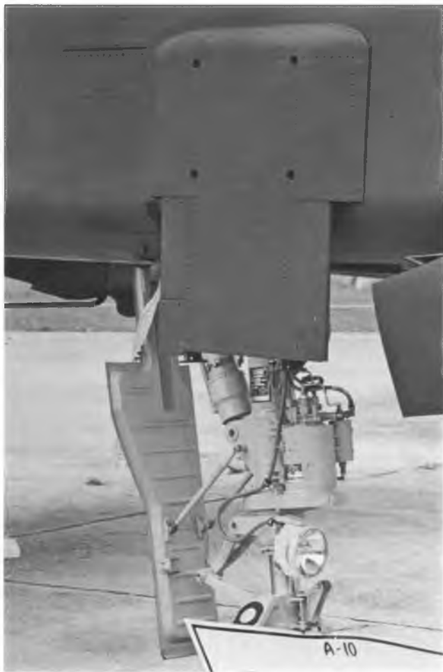
Dettaglio del carrello anteriore dell'A-10A Lizard. Da notare le targhette nere con parole e rettangoli argento, le piccole aste che collegano gamba carrello e portello, la «O» in nero, e la striscia rossa in tela «REMOVE BEFORE FLIGHT». Si notano anche il supporto «PAVE PENNY» e la antenna a «U» sotto la fusoliera.
