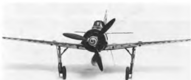
Questa vista anteriore mostra, oltre ai rigonfiamenti alari già descritti, l'antenna inferiore tipo Morane e le barrette indicatrici di carrello estratto fuoriuscenti dalla superficie alare.
