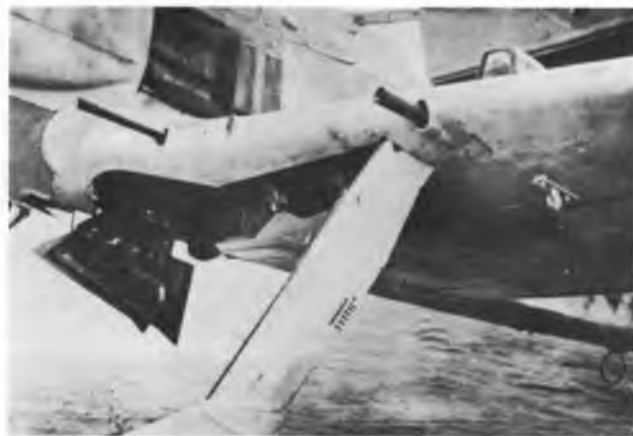
Questa immagine del FW190 V51 permette di osservare la sistemazione dei cannoni alari MK108 da 30 mm., l'interno dei portelli del carrello, nonché il gancio al quale veniva appeso uno dei due tubi lanciarazzi subalari WGr.21 (VFW)
