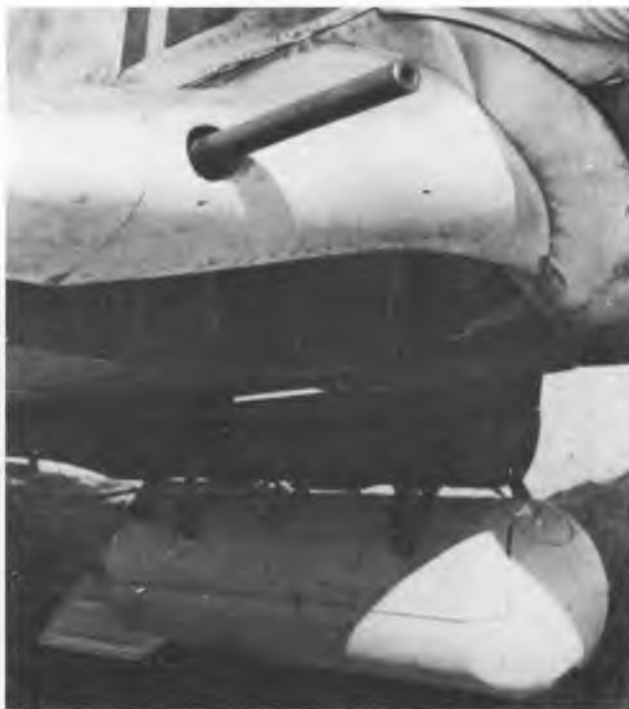
Contentore Ab 250 per bombe incendiarie o antiuomo; colorazione in 76 uniforme. (Bundesarchiv)
