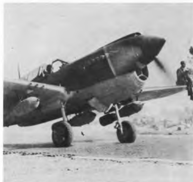
Decollo di un P-40N con un carico di bombe. Notare i cerchioni e le gambe di forza del carrello. (I.W.M.)
