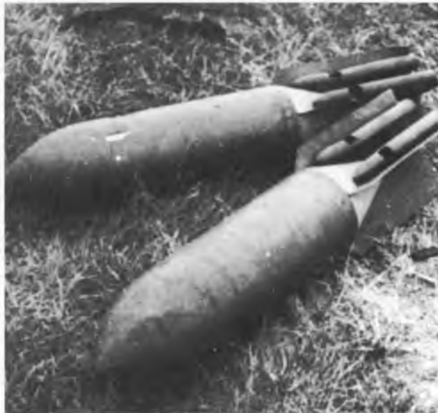
Bombe SC 250, con cono posteriore dipinto in giallo 04 e dispositivi «trombe di Gerico» applicati ai governali, per modificarne il fischio durante la caduta e farlo rassomigliare a quello di bombe di grosso calibro. (Bundesarchiv)
