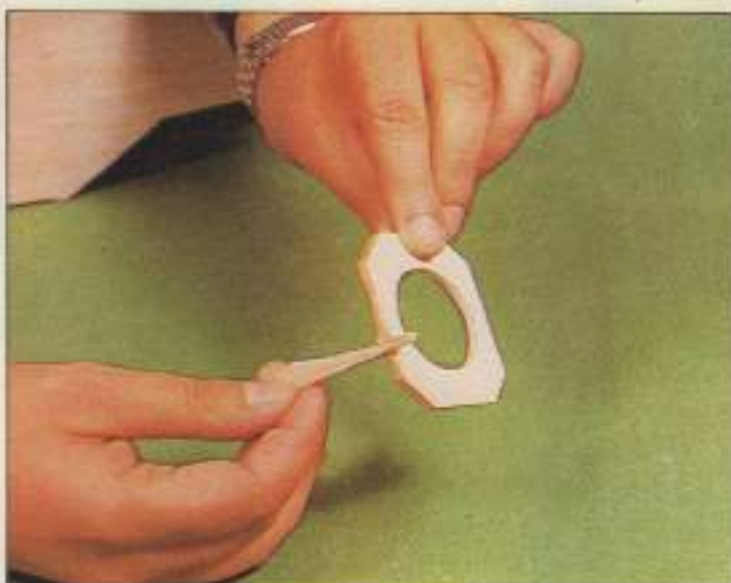
13. La cuaderna «E» se impregna con pegamento en sus lados, con el fin de ser instalada en su lugar correspondiente.
