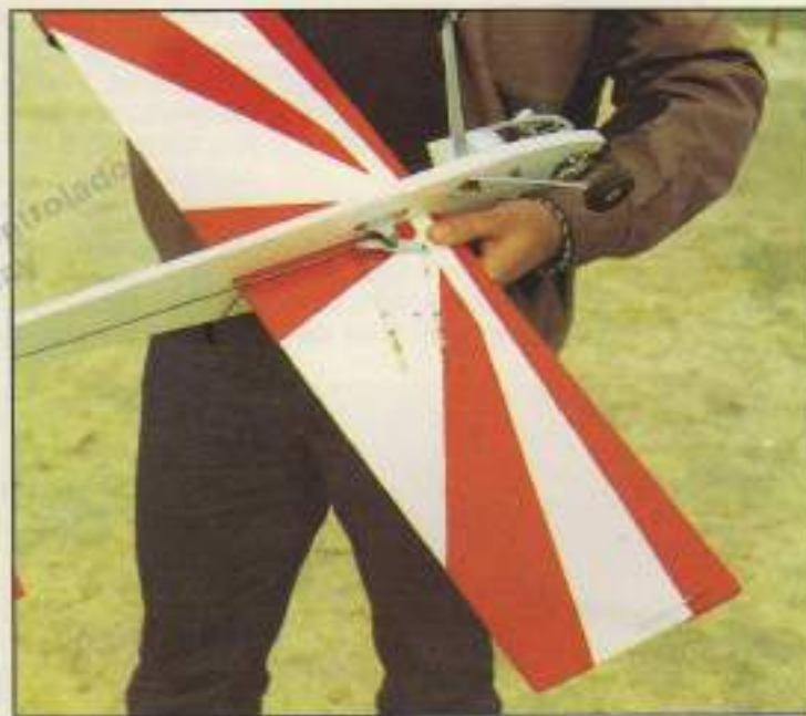
El balancín puede ser también realizado con aluminio, artesanalmente.
