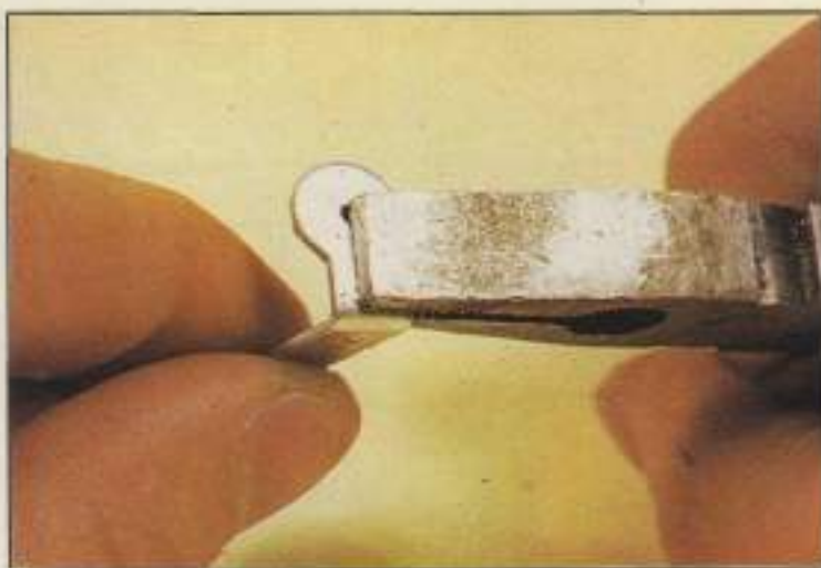
Mediante unos alicates se dobla adecuadamente a 90°.
