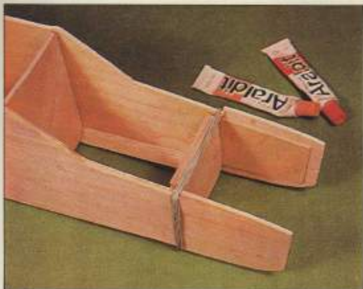
12. Utilizando pegamento epóxico, fijarla en su sitio procurando que quede perpendicular al eje del fuselaje.
