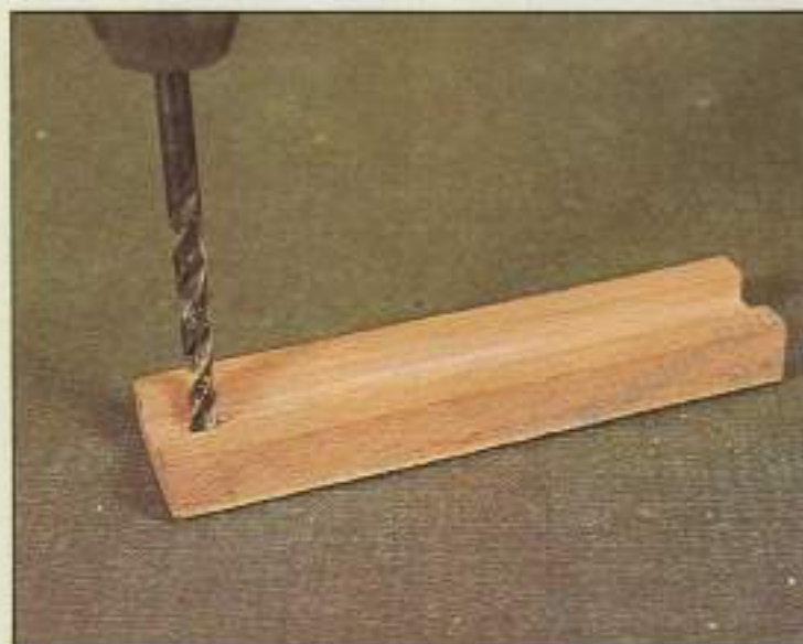
20. Siguiendo las indicaciones del plano respecto a posición, realizar dos taladros del mismo diámetro que el tren.
