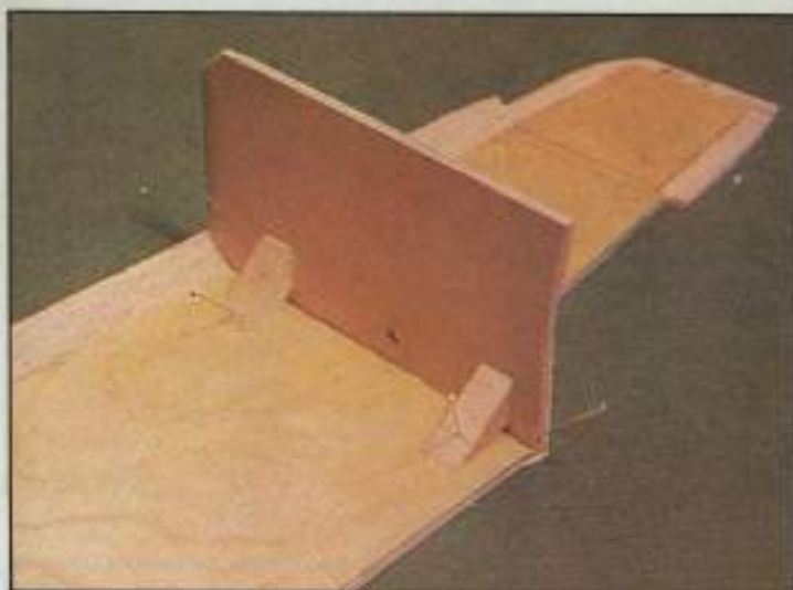
1. Las cuédrnas centrales se pegan en su sitio exacto, marcado previamente en los costados del fuselaje, por la cara interior.
