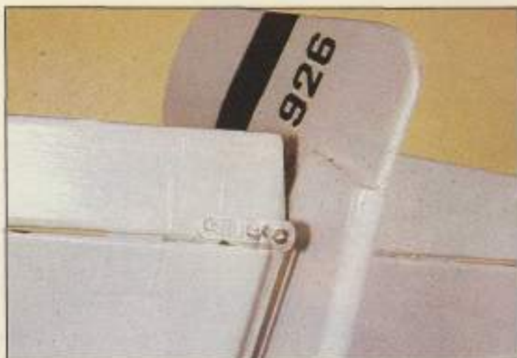
Horn de profundidad instalado en un estabilizador de «Mustang».
