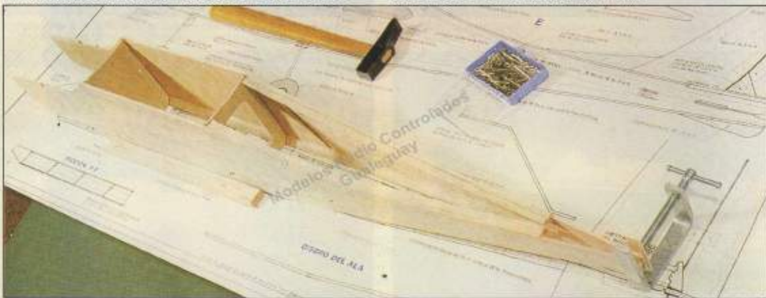
9. Se encaja el fuselaje entre las piezas de madera, comprobando que las marcas hechas en las cuadernas, coincidan con el eje del fuselaje que está representado en el plano. Si no es así, modificar la situación hasta conseguirlo.
