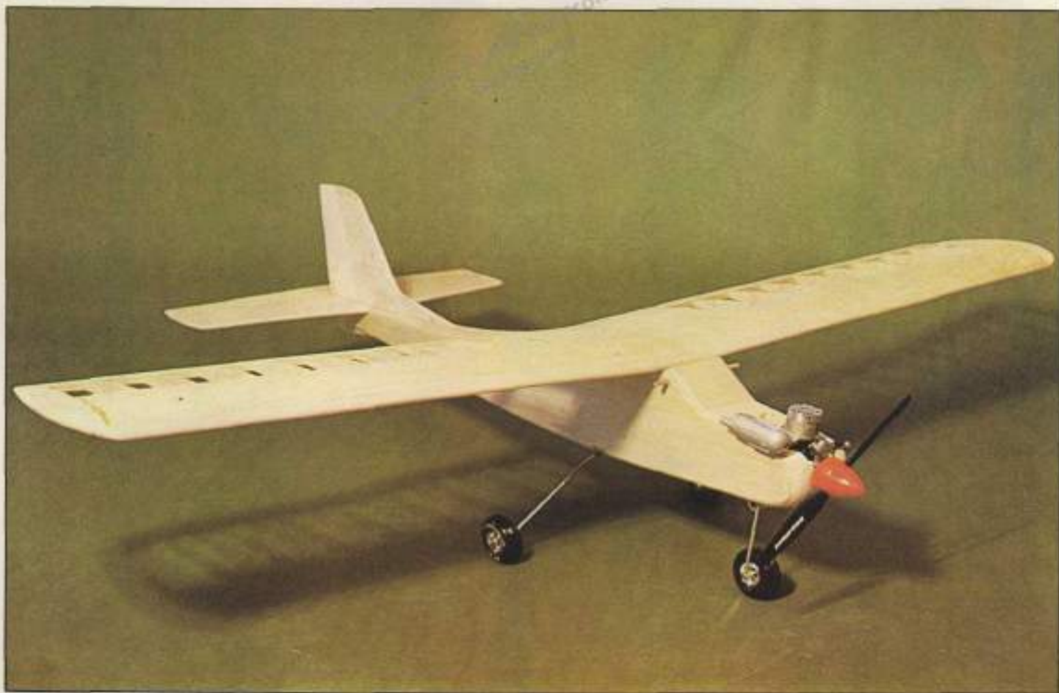
9. El «Hopper» va tomando forma. Tras esta etapa, pasaremos a la instalación del equipo de radio control y sus accesorios.
