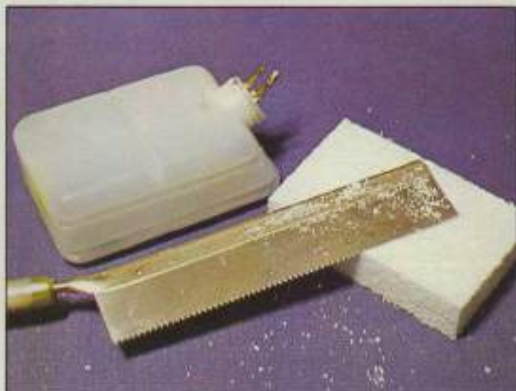
7. Antes de instalar el depósito en el fuselaje, cortaremos unos trozos de foam o gomaespuma, que servirán para su ajuste y aislamiento.
