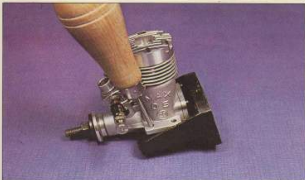
Mediante un punzón, se marcan en la bancada los taladros del motor, procurando hacerlo con la mayor precisión posible para su posterior ajuste.
