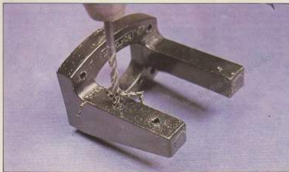
Los tornillos de rosca-chapa son muy eficaces para fijar un motor en bancada de plástico. Hacer en ésta los taladros, de un diámetro ligeramente inferior a los tornillos.
