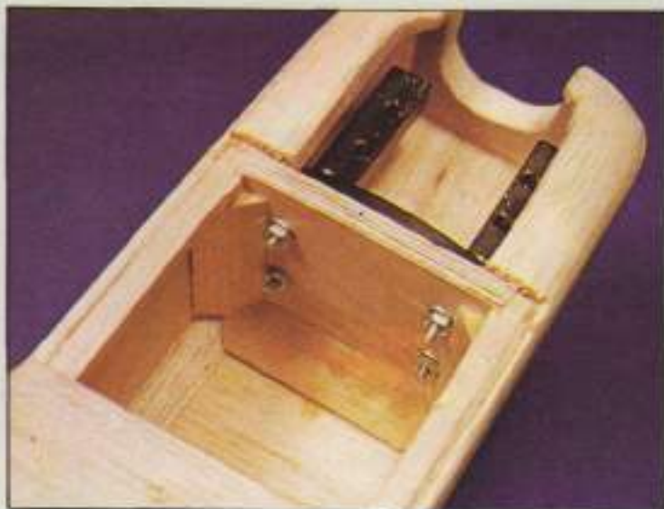
7. Zona posterior de la cuadema, con los tornillos y tuercas empleados en la sujeción de la bancada. Asegurar bien estos puntos.
