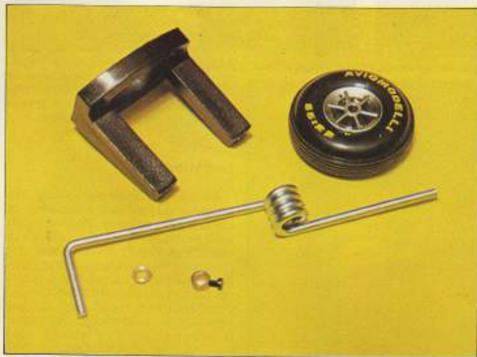
Elementos que componen el tren de aterrizaje delantero.
