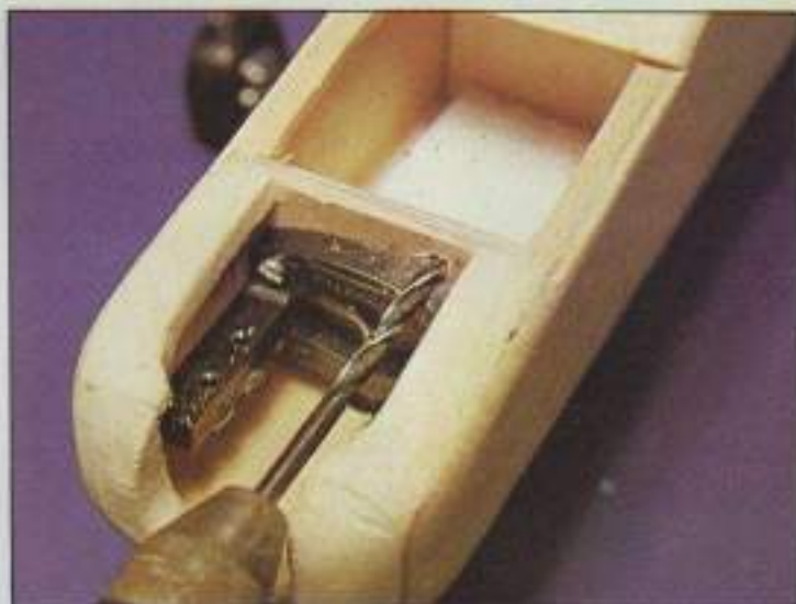
8. En la cuaderna delantera, si no se ha hecho antes, hay que hacer un taladro para el paso del tubo de silicona que va al motor.
