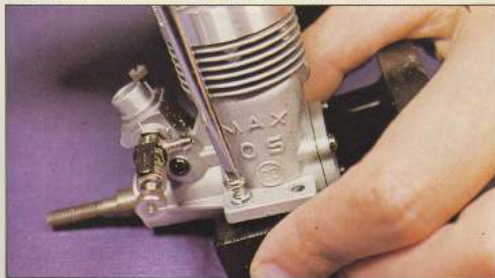
Atornillar el motor en la bancada, comprobando que los tornillos entran suficientemente fuertes, y que coinciden los taladros de ésta, con los del motor.
