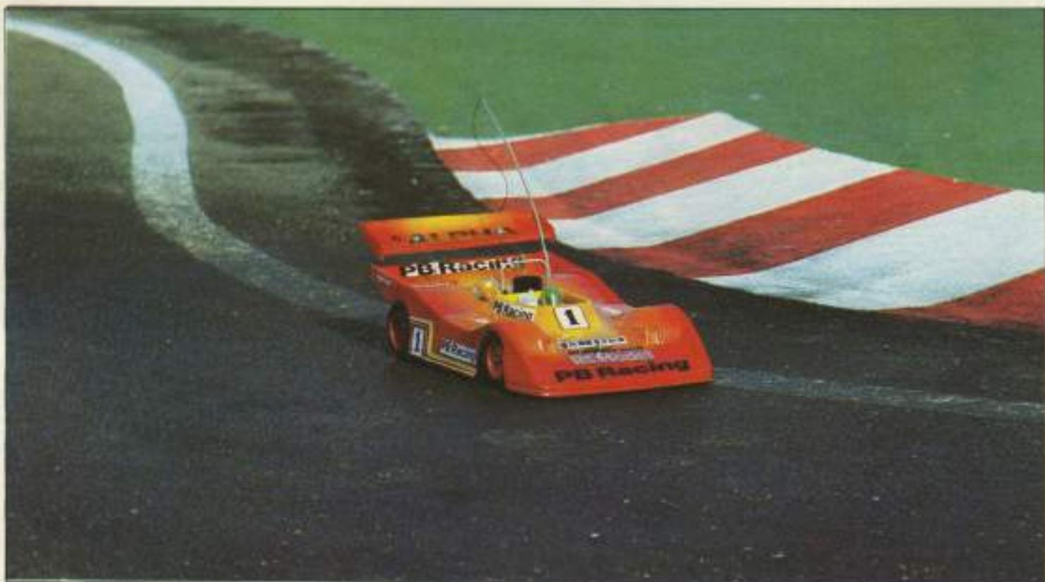
Estos coches utilizan motores de 3,5 cc, aprovechados al máximo mediante transformaciones y combustibles especiales.
