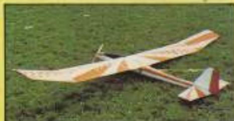
**ELECTRON:** Envergadura: 2.460 mm. Longitud total: 1.360 mm. Peso: 1.400 gr. Motor: Mabuchi RS 540 S. Materiales: Todo madera. Equipo de radio: Tres canales. Precio: 650 ptas. (Suscriptores 550 ptas.). Referencia: P-14.
