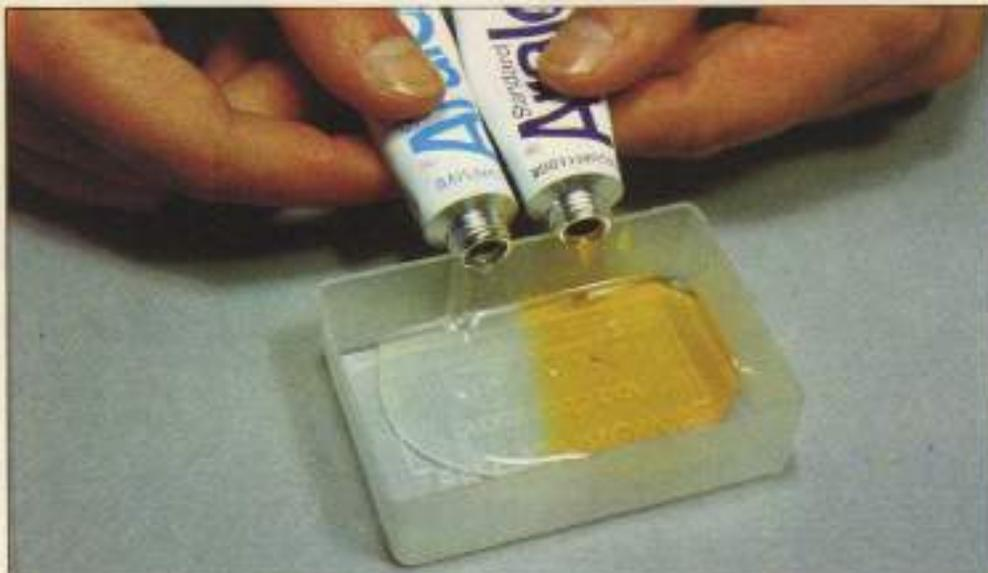
1 Mezclar un pegamento epóxico en cualquier recipiente plástico o metálico.
