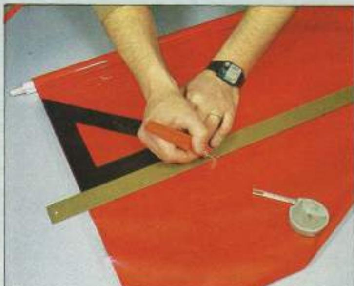
1 Trazar y cortar con regla y cuchilla el material correspondiente a una de las caras de una semiala, dejando 4 cm de sobrante.
