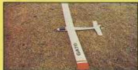
**GATO:** Envergadura: 1.644 mm. Longitud total: 958 mm. Peso: 750-900 gr. Motor: 0,8 c.c. Materiales: Todo madera. Equipo de radio: Dos canales. Precio: 550 ptas. (Suscriptores 375 ptas.). Referencia: P-07.
