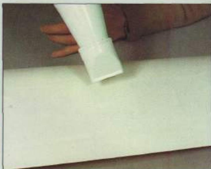
14 Utilizando el secador, aplicar calor a toda la superficie del ala en sus dos caras, para tensar totalmente. Insistir.
