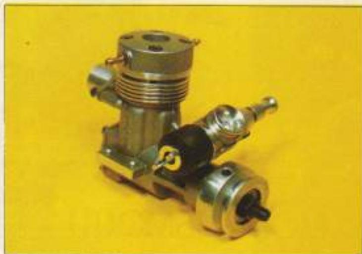
Los motores de pequeña cilindrada alcanzan las 35.000 rpm.
