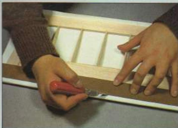
7 Si sobra material, cortar antes de pegar utilizando unas tijeras o una cuchilla, poniendo una regla que proteja la madera.
