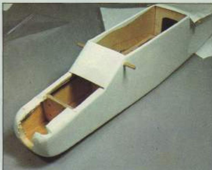
20 Después, utilizando pequeños trozos, se van recubriendo las demás zonas del fuselaje, hasta completarlo.
