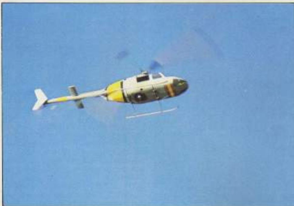
Las palas de un helicóptero generan la sustentación al girar.
