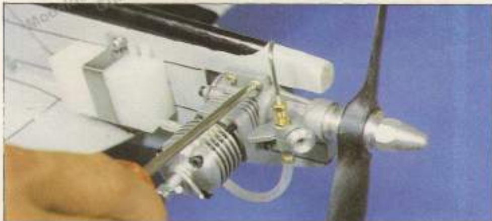
Cuando el modelo tiende a subir o bajar por su cuenta, se deberá revisar el centro de gravedad y la incidencia del motor.
