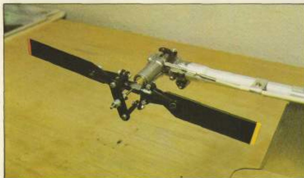
Rotor de cola clásico con el sistema de transmisión del paso variable.
