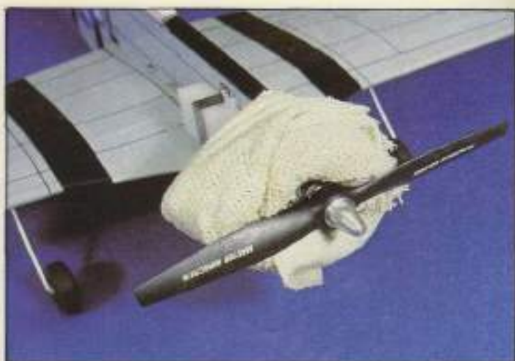
Un trapo protege el motor cuando el modelo no se utiliza.
