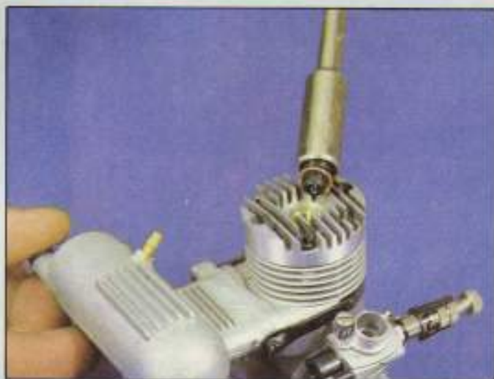
1. Desenroscar la bujía utilizando una llave especial.
