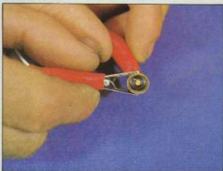
3. El filamento deberá iluminarse por temperatura.
