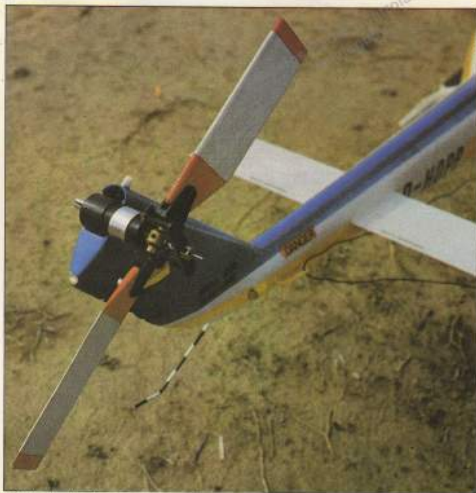
Detalle de rotor trasero con transmisión interna, en un modelo a escala.
