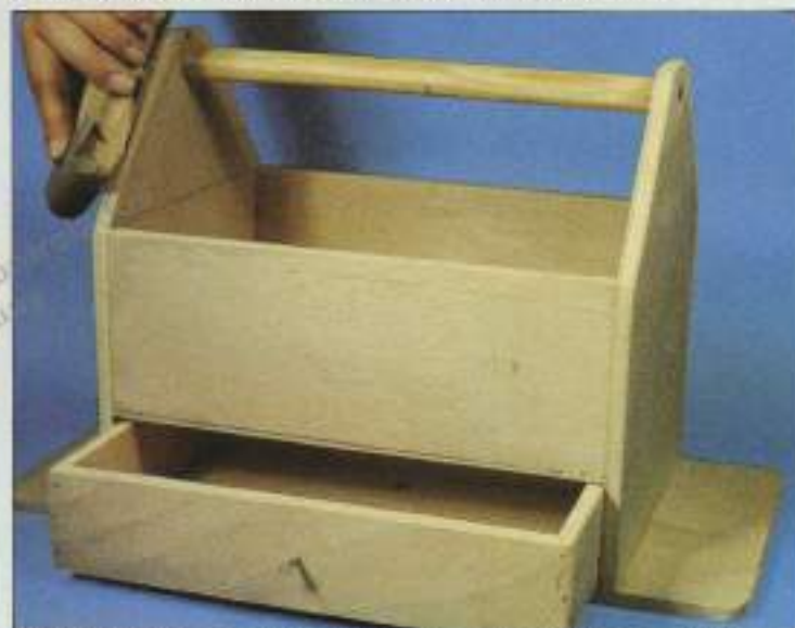
10. Concluida la fase de montaje, repasaremos todo el conjunto con lija muy fina para mejorar la superficie de la madera.
