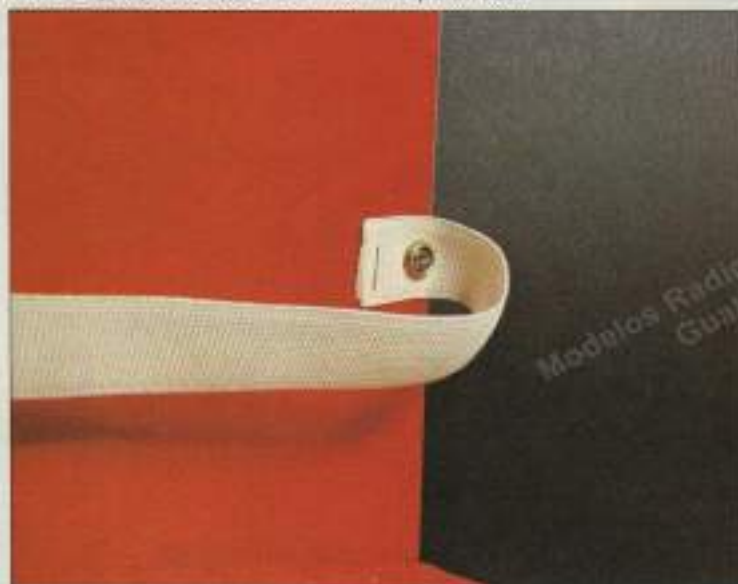
15. Unas cintas de goma sujetarán la lata del combustible. Fijarlas con un tornillo y ovalillos cónicos.
