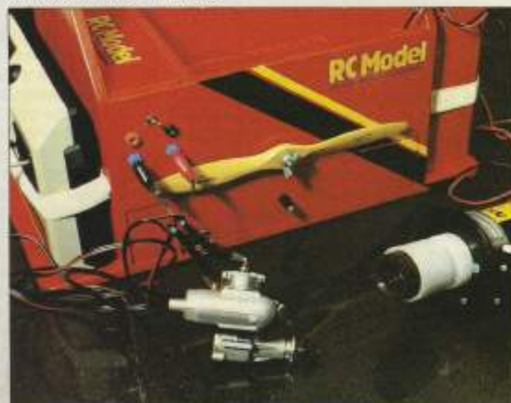
18. Una vez concluidas las conexiones, tendremos corriente de 12 v. para el arrancador, y 1,5 v. para las bujías.
