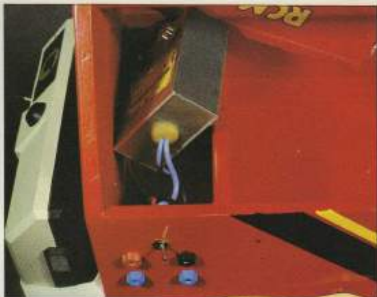
13. Después de instalar los conectores, situaremos el alimentador de la bujía, procurando no invertir la polaridad.
