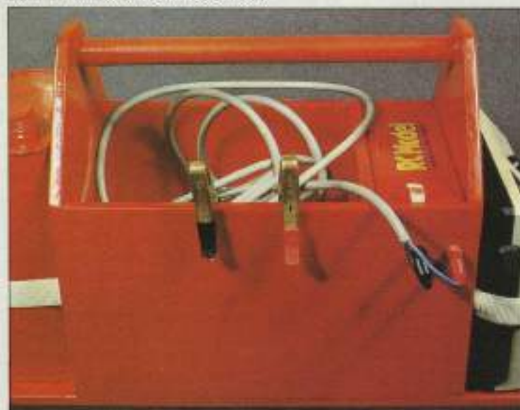
17. En la parte posterior se conecta un cable que suministrará corriente desde una batería de coche.
