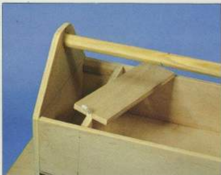
7. Cortar y ajustar la tapa del compartimento del sistema eléctrico. Adaptar una cinta como tirador.
