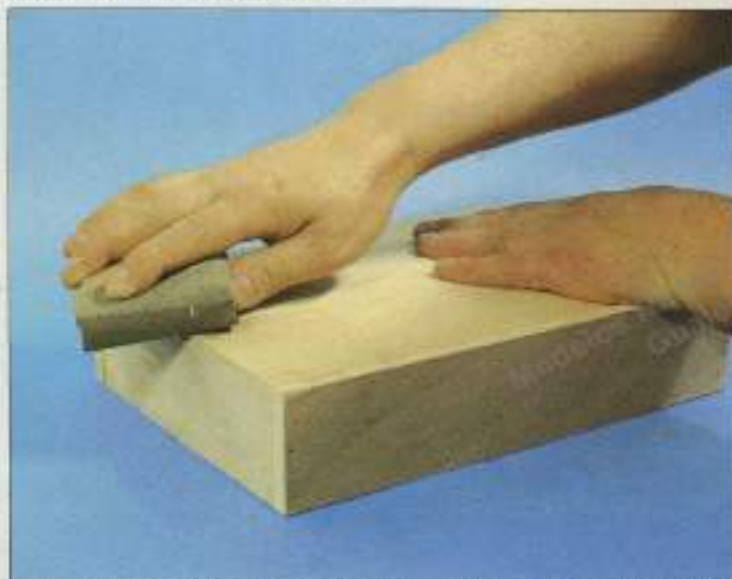
9. Es posible que una vez acabado, no deslice con facilidad. Comprobar puntos de rozamiento y repasar con lija.
