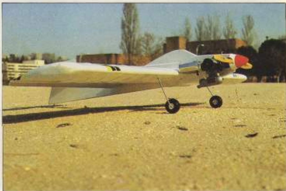
Las alas suelen ser de gran espesor, y perfil simétrico.
