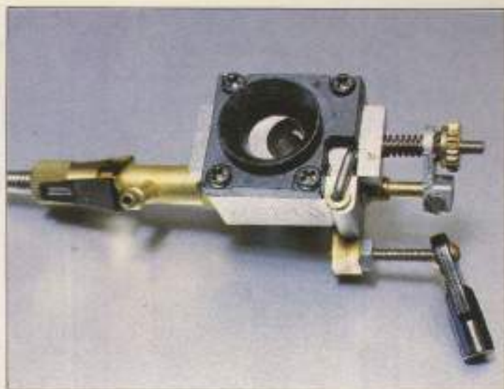
Carburador de «guillotina» o «cortinilla».
