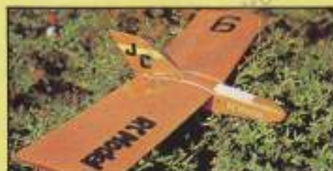
NANA: Envergadura: 875 mm. Longitud total: 475 mm. Peso: 300-450 gr. Materiales: Foam y madera. Equipo de radio: Dos canales. Precio: 600 ptas. (Suscriptores 525 ptas.). Referencia: P-32.
