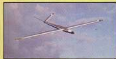
AGRESOR: Envergadura: 2.000 mm. Longitud total: 1.060 mm. Peso: 1.600 gr. Materiales: Porex y madera. Equipo de radio: Tres canales. Precio: 900 ptas. (Suscriptores 800 ptas.). Referencia: P-44.
