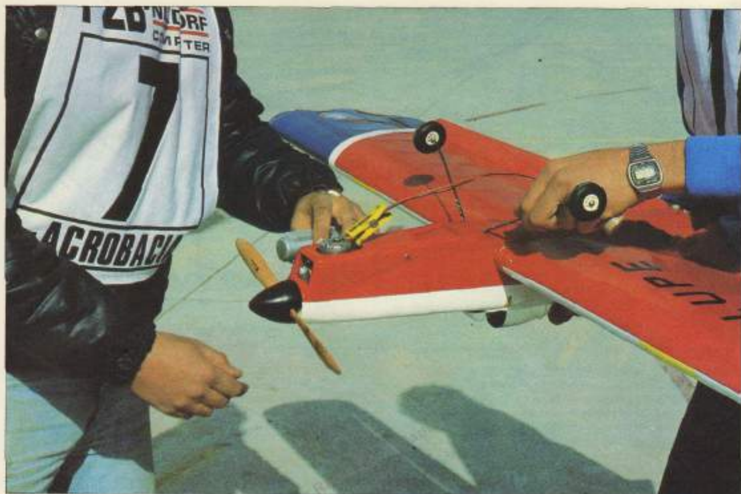
Cuando el motor va en posición invertida, se facilita el arranque dando la vuelta al modelo.
