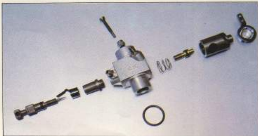
Despiece de un carburador con variación de potencia.
