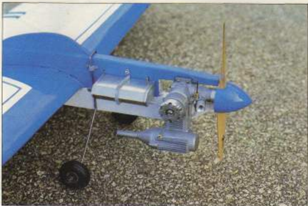
Disposición de motor y depósito en un entrenador de acrobacia.
