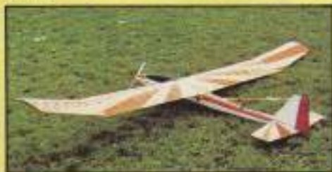
ELECTRON: Envergadura: 2.460 mm. Longitud total: 1.160 mm. Peso: 1.400 gr. Motor: Mabuchi RS 540 S. Materiales: Todo madera. Equipo de radio: Tres canales. Precio: 690 ptas. (Suscriptores 550 ptas.). Referencia: P-14.
