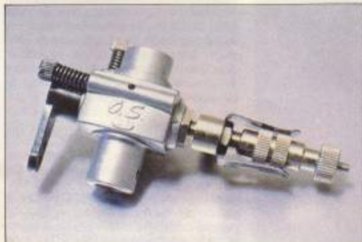
Se observa el orificio para el aire del ralenti.
