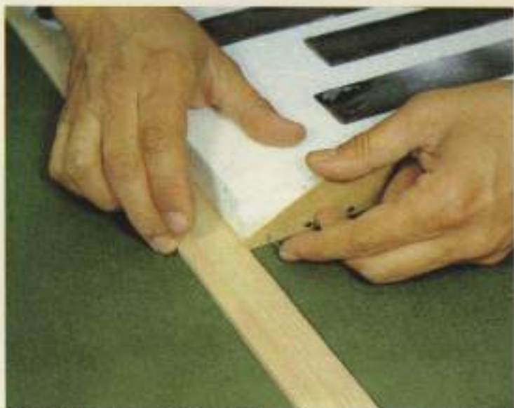
19. Si el borde marginal es achafanado, utilizar unas plantillas como estas para realizar el corte.
