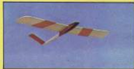
DARDO II: Envergadura: 1.260 mm. Longitud total: 810 mm. Materiales a emplear: Foam y madera. Equipo de radio. Dos canales. Precio: 600 ptas. (Suscriptores 525 ptas.). Referencia: P-29.
