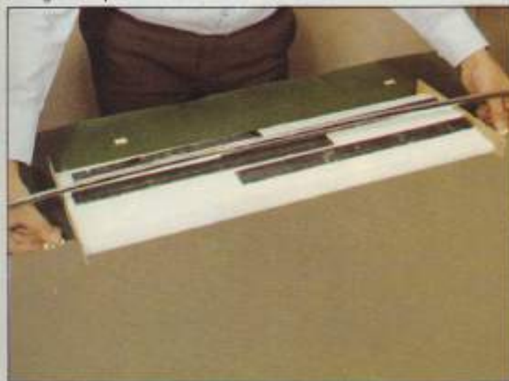
17. Cortar los bordes utilizando las plantillas adecuadas.
