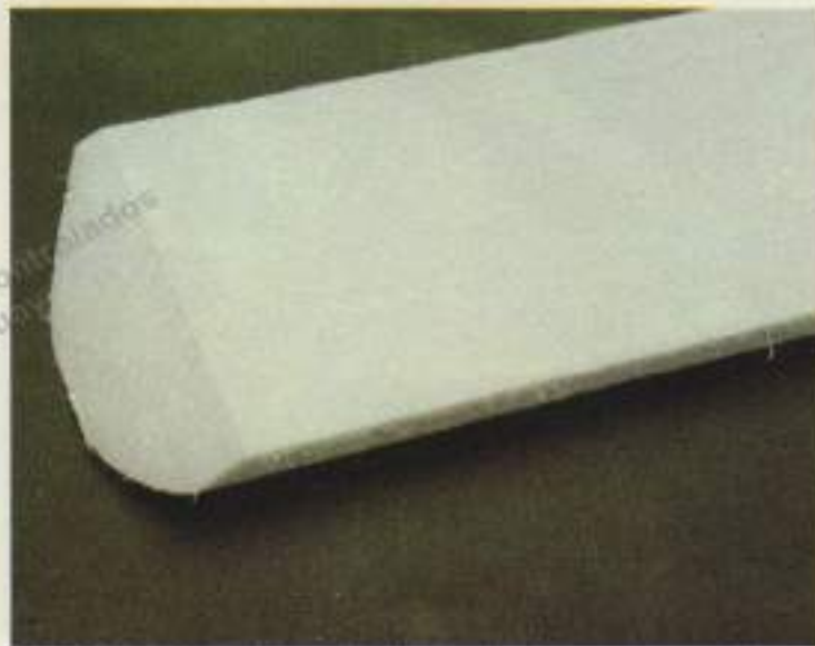
22. Al retirar la cama del extradós citada, el borde marginal aparece con su forma definitiva. Repasar con lija fina.
