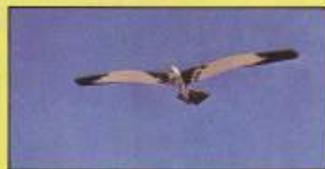
BERCAJO: Envergadura: 2.420 mm. Longitud total: 920 mm. Peso: 1.350 gr. Materiales: Todo madera. Equipo de radio. Dos canales. Precio: 700 ptas. (Suscriptores 625 ptas.). Referencia: P-40.
