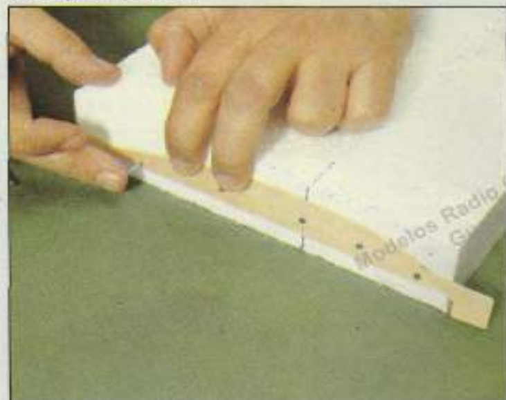
9. Fijar las plantillas utilizando para ello clavos o tornillos largos de rosca-chapa. Asegurar la fijación.
