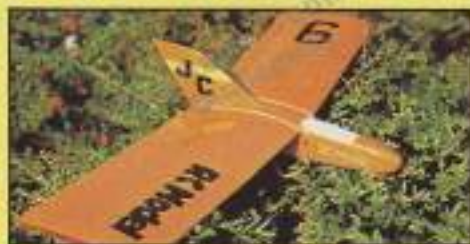
NANA: Envergadura: 875 mm. Longitud total: 475 mm. Peso: 350-400 gr. Materiales: Foam y madera. Equipo de radio. Dos canales. Precio: 600 ptas. (Suscriptores 525 ptas.). Referencia: P-38.
