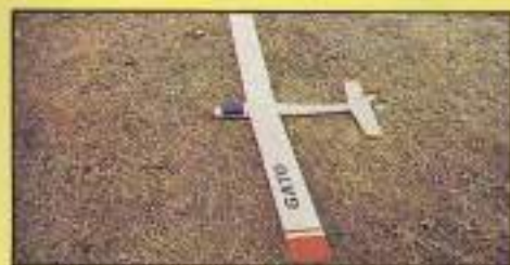
GATO: Envergadura: 1.844 mm. Longitud total: 858 mm. Peso: 750-900 gr. Motor: 2,5 c.c. Materiales: Todo madera. Equipo de radio. Dos canales. Precio: 450 ptas. (Suscriptores 375 ptas.). Referencia: P-07.
