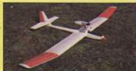
CONDOR: Envergadura: 3.175 mm. Longitud total: 1.455 mm. Peso: Voleo 2.810 gr. Motovoleo 3.460 gr. Motor: 2,5-3,5 c.c. Materiales: Todo madera. Equipo de radio. Dos canales. Precio: 950 ptas. (Suscriptores 850 ptas.). Referencia: P-25.
