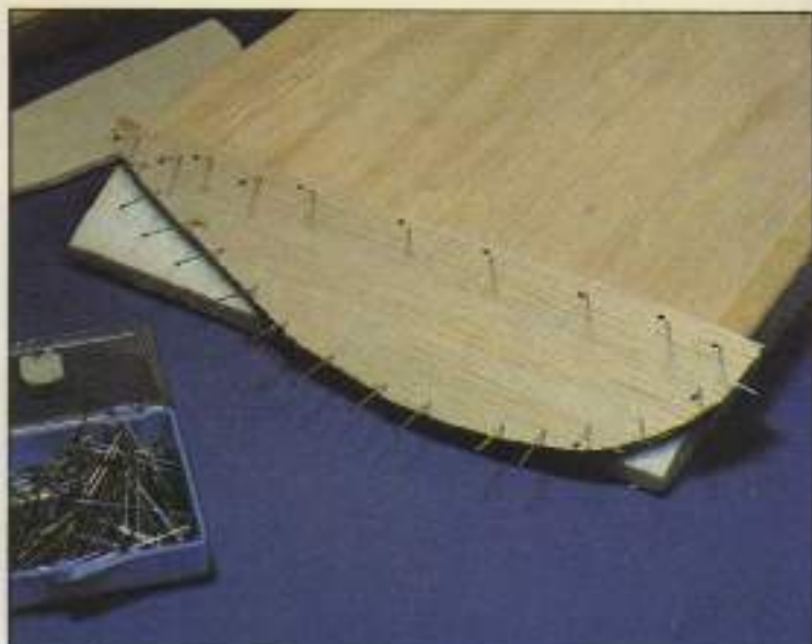
20. Fijar una pieza de balsa con la meta en el sentido que se indica, dejando sobrante para más tarde ser lijado.
