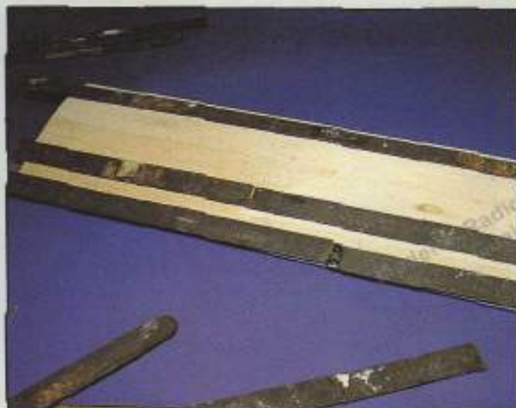
15. Dejar secar procurando que el ala no se mueva. Utilizar si es preciso algún peso encima del conjunto.
