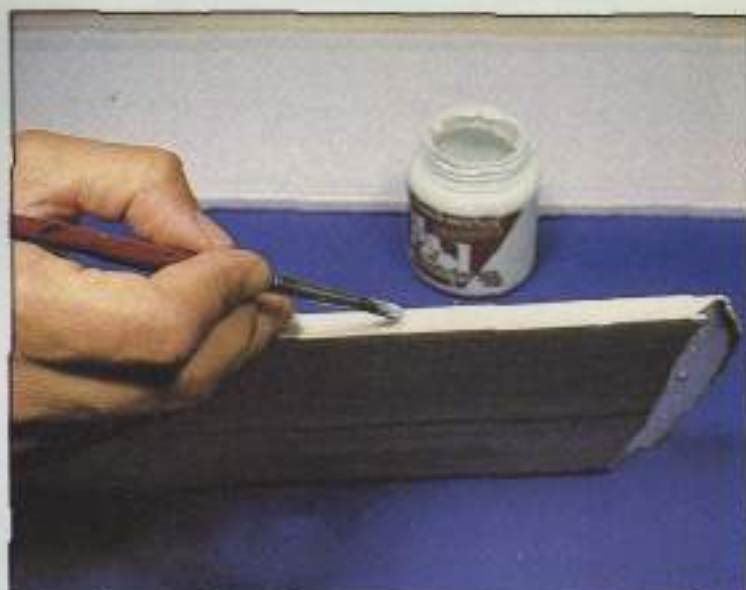
13. En la zona del ala correspondiente al borde de salida, aplicar cola blanca o pegamento epóxico.
