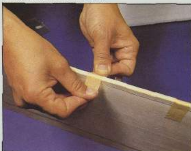
17. El listón de balsa del borde de ataque, se fija en su sitio.
