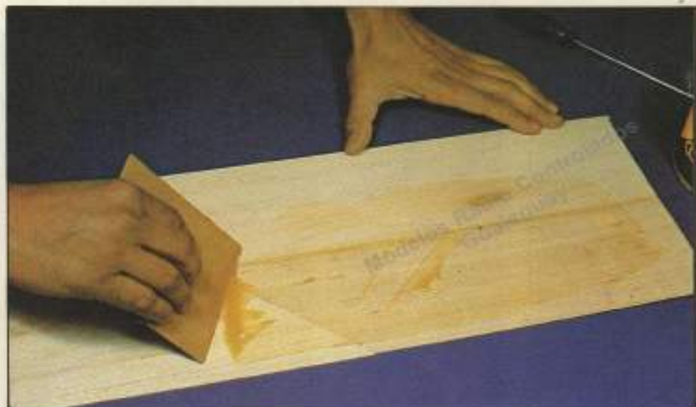
La cola de contacto se extiende fácilmente con una espátula improvisada.
