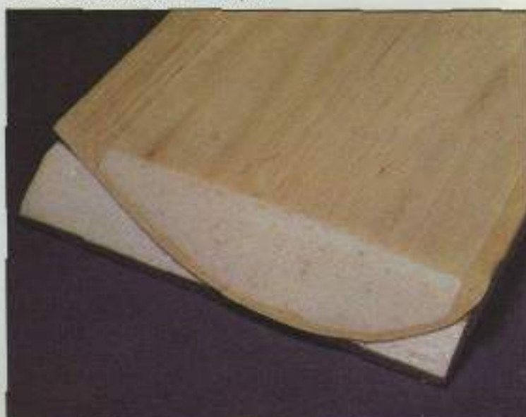
18. Lijar el borde marginal para proceder a su enchapado.
