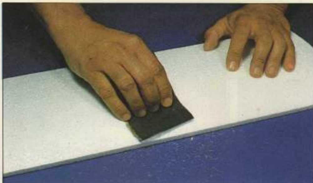
Antes de proceder al enchapado, eliminar con lija fina las posibles protuberancias.
