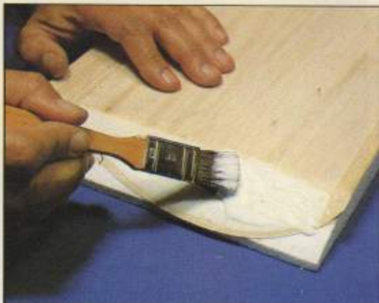
19. Después de lijar y planificar la superficie, aplicaremos pegamento, cola blanca, epoxy o cualquier otro para foam.
