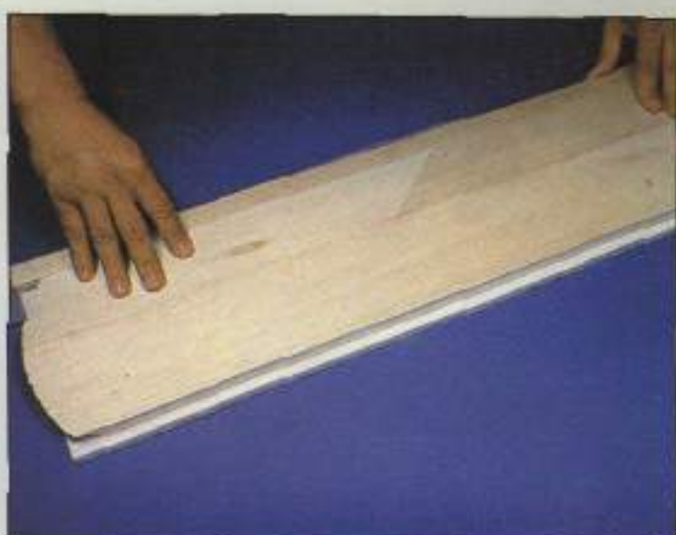
14. Colocar el ala sobre la cama, junto al borde de salida. El papel evitará que el pegamento se salga.
