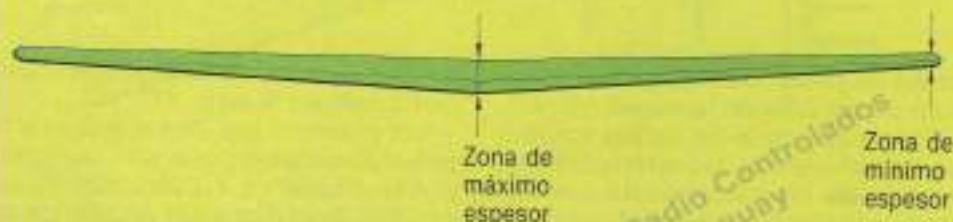
Espesores representados en un ala vista de frente.
