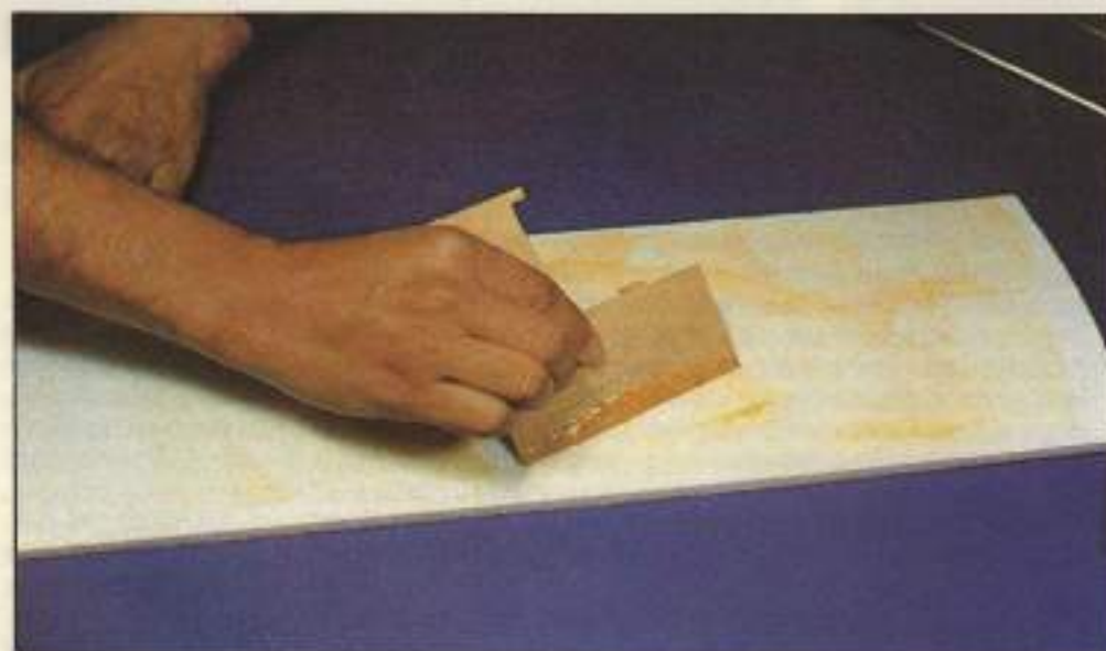
Primero en la madera y después en el foam. Dar una capa muy fina.
