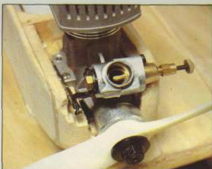
8. La varilla de mando se unirá al brazo del carburador soldando a ésta un acoplamiento para kwik link.
