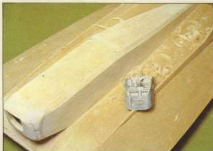
El cepillo nos puede ayudar a efectuar la forma del morro del fuselaje; la lija conseguirá el acabado.
