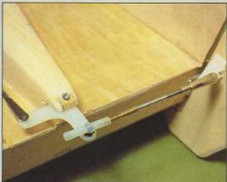
12. Cada timón se une a la «L» a través de un doble kwik link con rótula central y el correspondiente varillaje.
