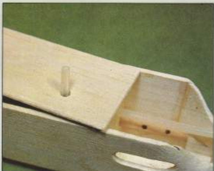
10. En la tapa inferior se hace también un taladro para el tubo de rebosado. Esta tapa no se pega todavía.
