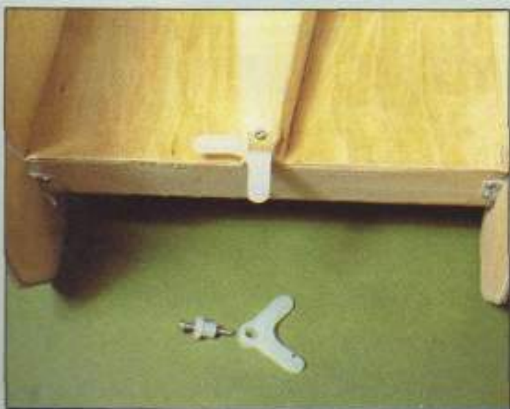
10. La «L» de mando se fijará con un tornillo en su ranura.
