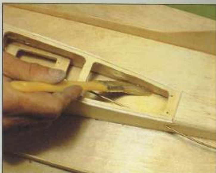
13. En la fase de barnizado impermeabilizaremos también el interior de los compartimentos.
