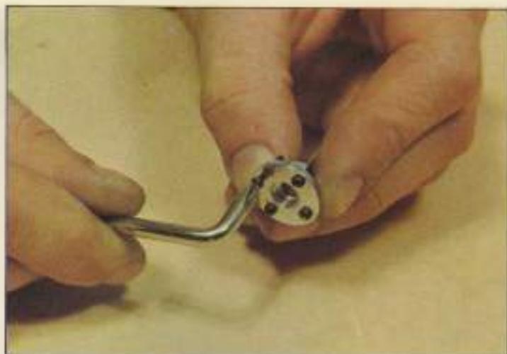
Los tornillos de fijación de las ruedas son instalados en los bujes.
