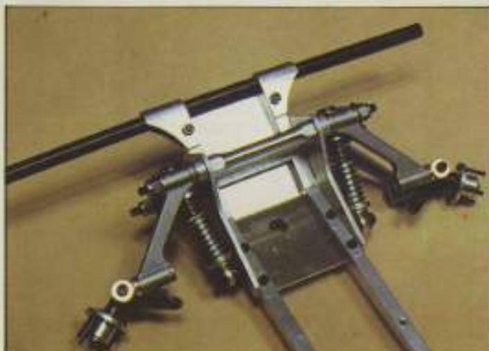
2. Durante las fases de montaje iremos comprobando periódicamente la libertad de las partes móviles.
