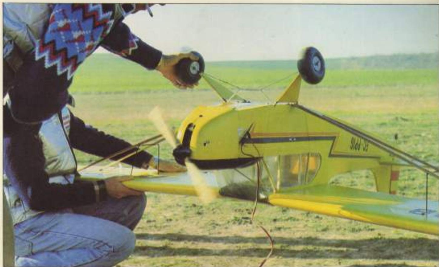
Cuando el motor está montado invertido, suele dar problemas de inundación de bujía. La solución es arrancar en esta posición.
