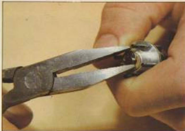
El eje de la mangueta va provisto de una ranura para insertar la gruppilla que retiene el buje.
