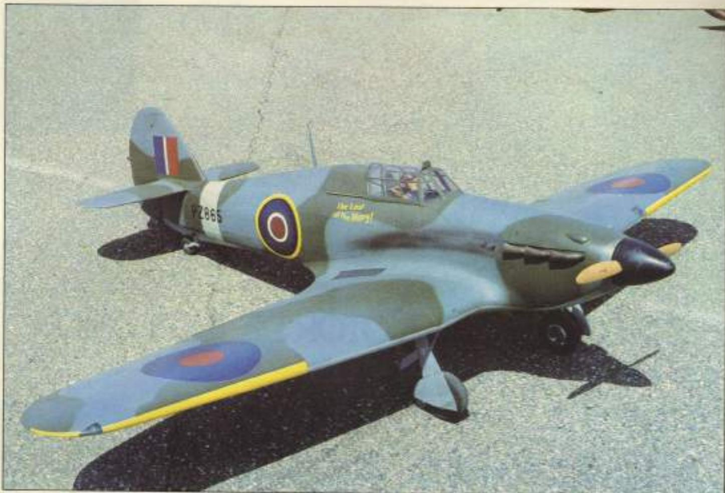
En los modelos con el motor totalmente cubierto, es necesario disponer una conexión permanente de la bujía al exterior.
