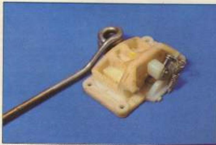
Una pata de tren principal con bloqueo en ambos extremos.
