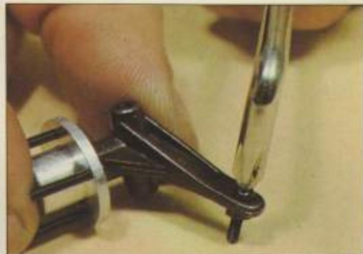
Antes de montar la mangueta se dejan instalados en ella los tornillos de las rótulas de dirección.
