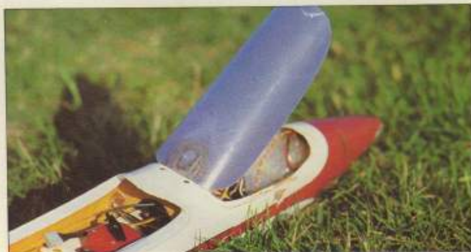
La propia cabina puede ser empleada como freno para el aterrizaje.
