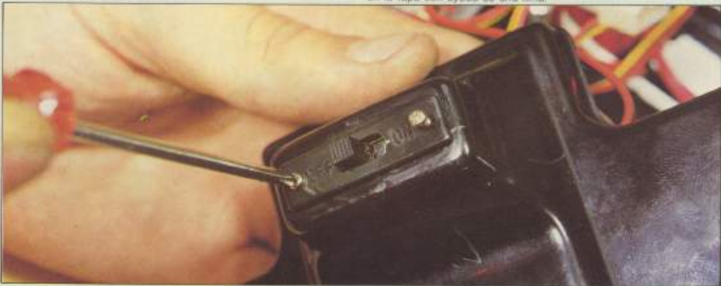
16. El interruptor se fija con el sistema habitual de los tornillos. Con esta operación queda finalizado el montaje del equipo RC.
