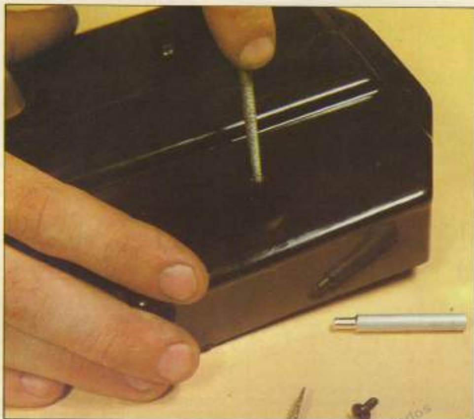
El montaje de la radio se inicia taladrando la caja para fijar los soportes de la tapa.
