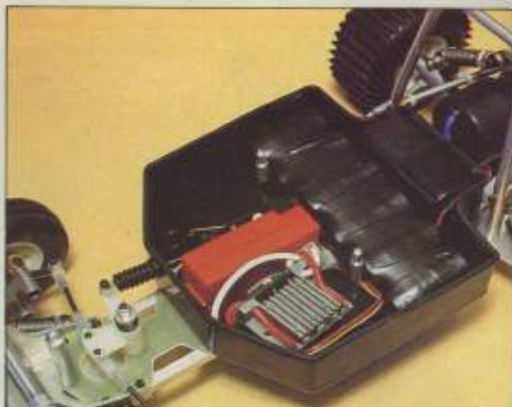
13. El «pack» de baterías que alimentan el motor tampoco deberá fijarse con pegamento.
