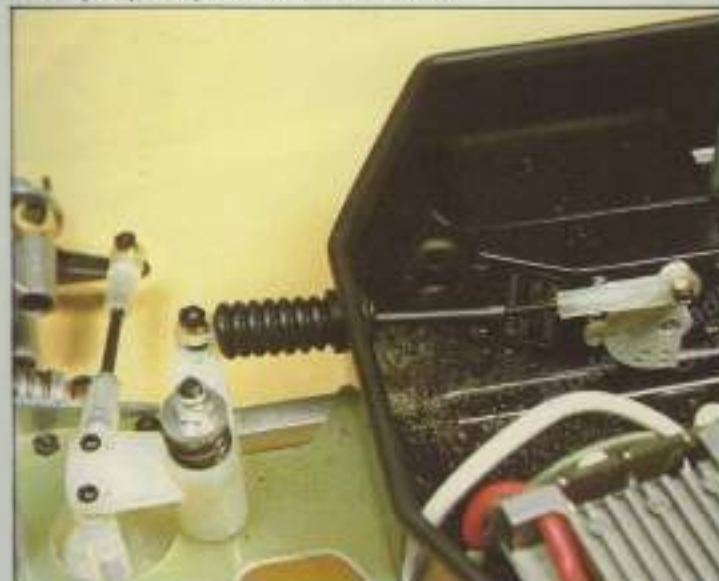
8. Una vez fijado el servo de dirección en su lugar, se instala la varilla de mando correspondiente.
