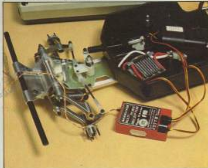
9. Antes de continuar, conviene presentar el receptor y las baterías, y comprobar su correcto funcionamiento.
