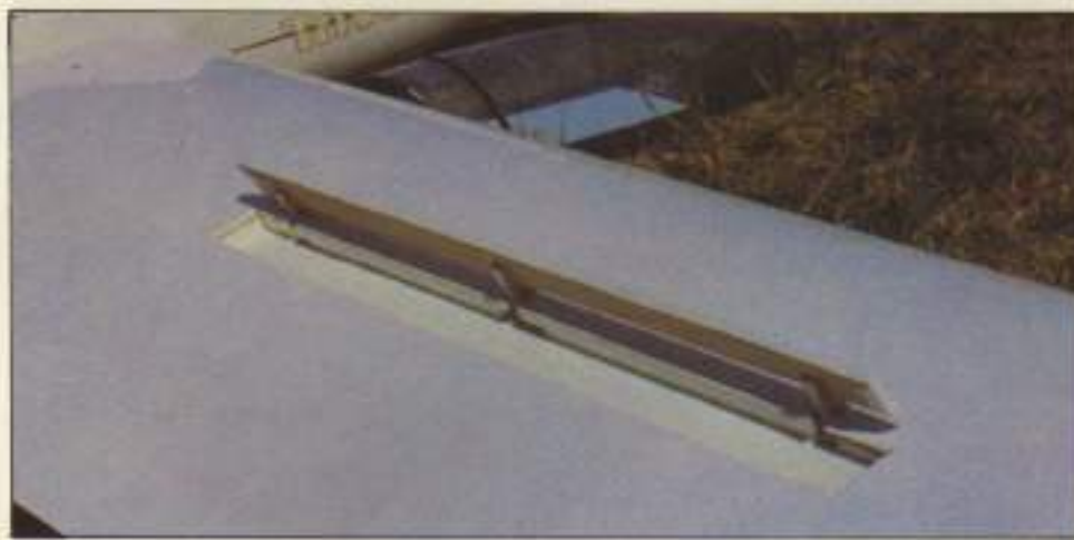
Freno de extradós abisagrado, en el ala de un velero.
