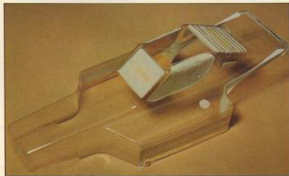
Antes de pintar se cubrirán con cinta adhesiva los cristales y zonas que vayan en otro color.
