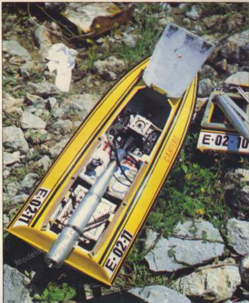
Lancha de competición FSR, en la que se observa la disposición del escape, así como el resto de los componentes, transmisión, equipo de radio, etc.
