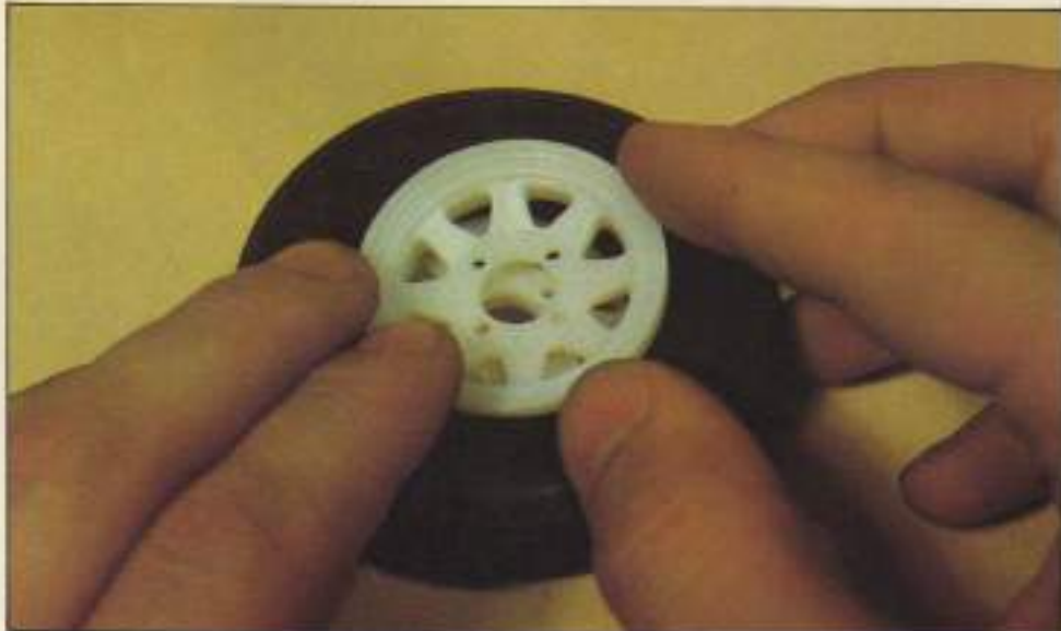
Presentar los laterales. Si no son simétricas se tendrá en cuenta el sentido de giro.
