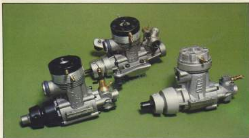
Motores empleados en lanchas de competición, con los accesorios característicos, la refrigeración del cilindro por agua y el volante de inercia.
