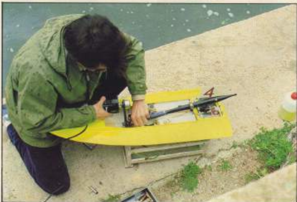
La puesta en marcha se realiza con un arrancador eléctrico que arrastra al volante, mediante una correa que une a ambos.
