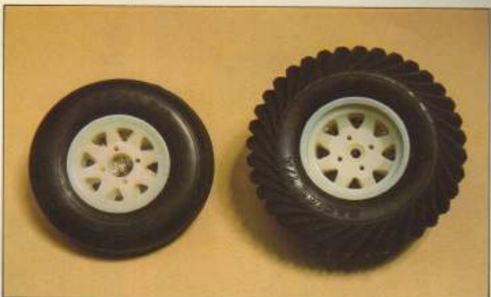
Después de montar el neumático comprobaremos que todas las piezas de la llanta están en línea. Esto es imprescindible para introducir los tornillos de fijación.
