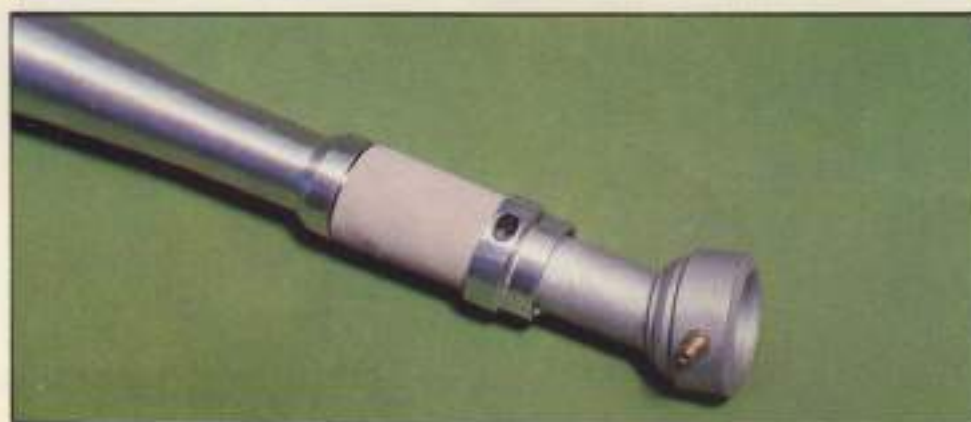
La unión entre el tubo resonador y el colector de escape, se efectúa con un trozo de tubo de silicona blanda, de unos 5 mm de pared.
