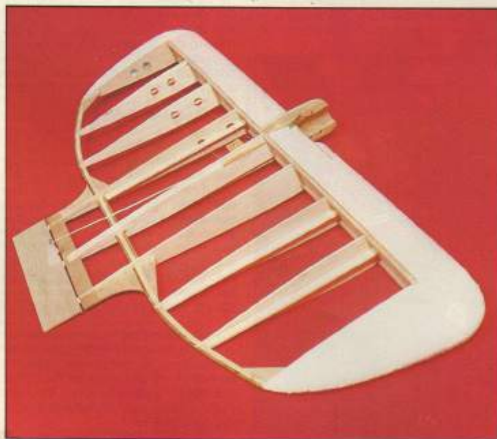
Estructura clásica de un ala de combate, basada en la sencillez y la economía.
