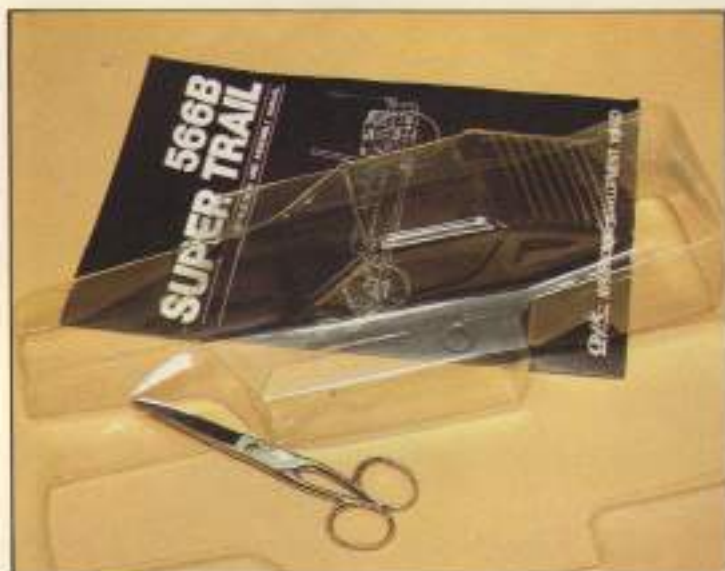
Para ajustar la carrocería se empezará quitando todo el resalte de la parte inferior.
