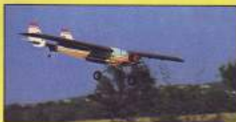
MONSTER: Envergadura: 2.076 mm. Longitud total: 1.316 mm. Peso: 4.800 gr. Motor: 10 cc. Materiales a emplear: Todo madera. Equipo de radio: 4-8 canales. Precio: 1.200 ptas. (suscriptores 1.050 ptas.). Referencia: P-20.
