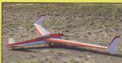
COLUMBO: Envergadura: 2.420 mm. Longitud total: 1.390 mm. Peso: 2.900 gr. Motor: 3,5 cc. Materiales a emplear: Todo madera. Equipo de radio: Tres canales. Precio: 950 ptas. (suscriptores 800 ptas.). Referencia: P-30.
