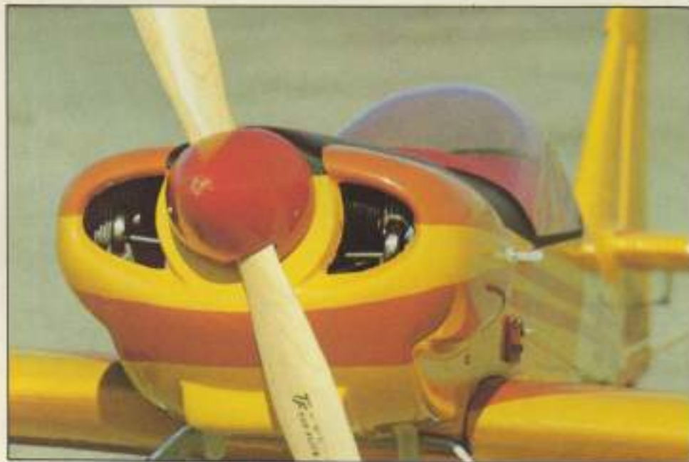
Gracias a la fibra de vidrio se ha simplificado la realización de piezas de cierta dificultad.
