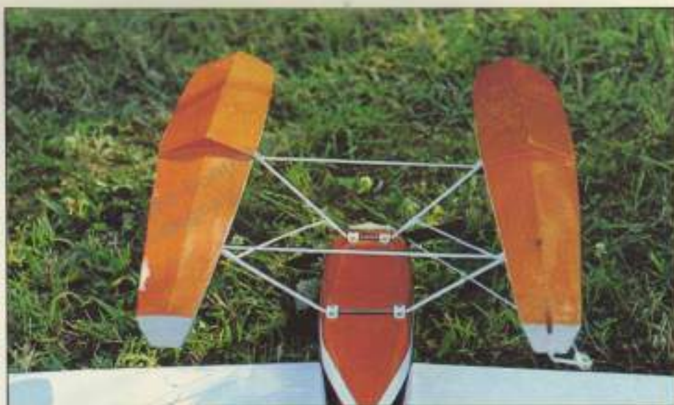
El fondo en «V» es el más empleado en aeromodelos y en aviones reales.
