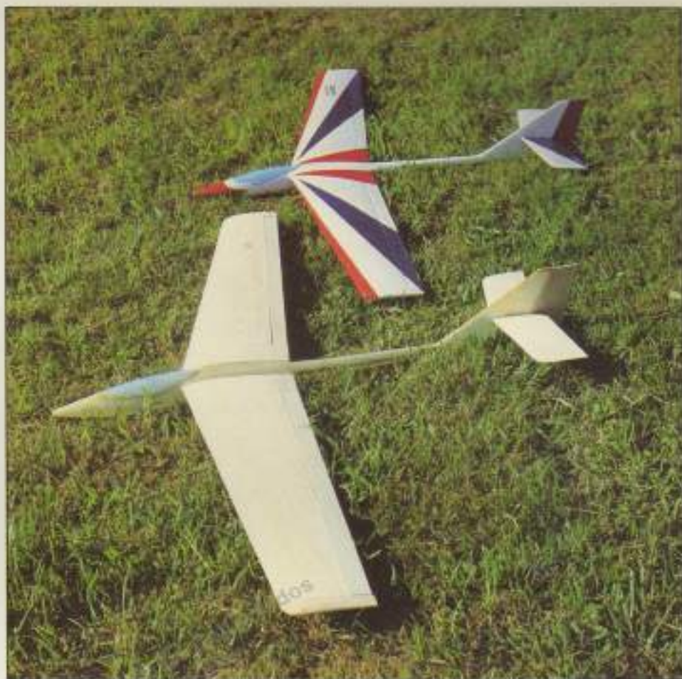
Velero comercial medio ensamblado con fuselaje en fibra de vidrio y alas de foam.
