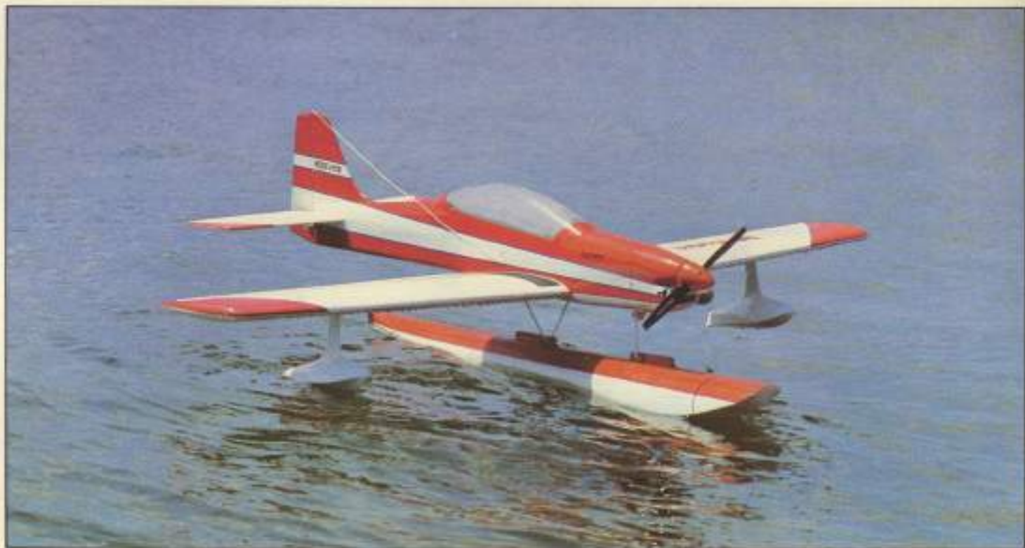
Un solo flotador es la opción más perfecta desde el punto de vista aerodinámico, por su menor resistencia.
