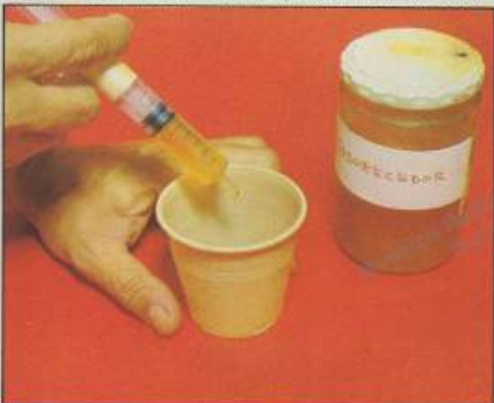
14. El endurecedor decidirá según la cantidad, el tiempo de secado. Hay un margen que está indicado en las instrucciones.
