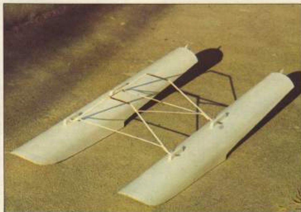
Conjunto de dos flotadores con sujeción mediante varillas de cuerda de piano.
