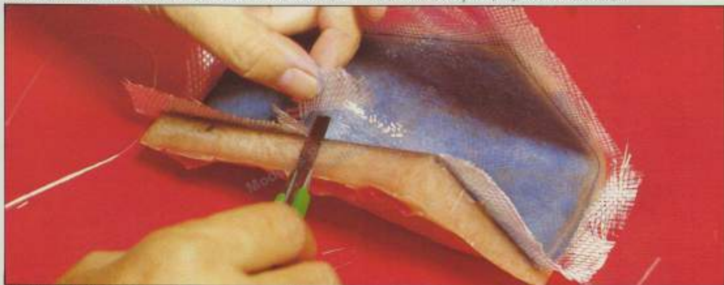
20. Terminada la operación anterior, se deja secar el tiempo necesario. Entonces se procede a cortar el sobrante con una cuchilla.
