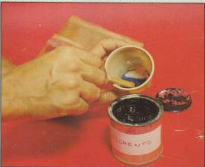
16. Existen pigmentaciones de color para mezclar con la resina.
