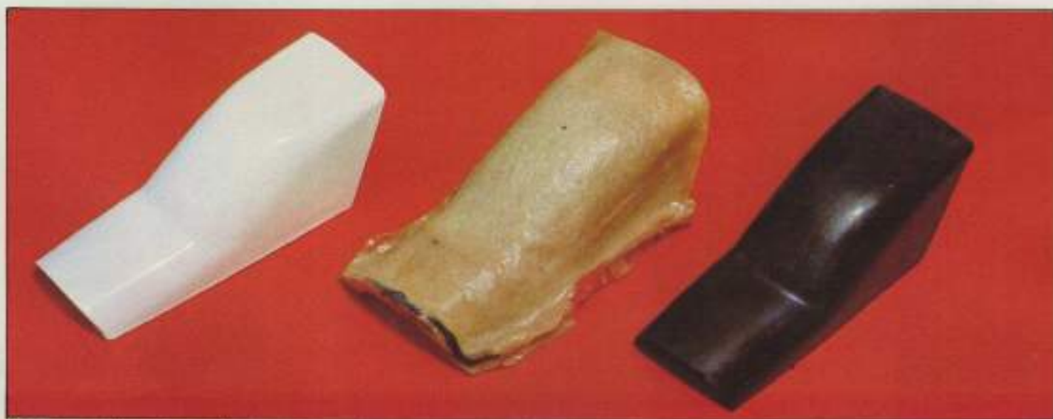
21. Asegurándonos de que la pieza está completamente seca, podemos ya sacarla del molde. El proceso está finalizado.
