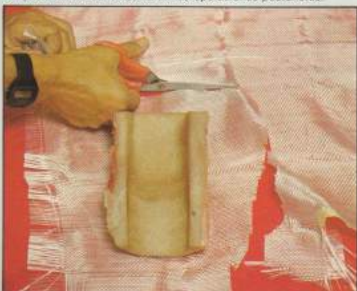
17. Cortar el trozo de tejido para realizar la pieza definitiva.
