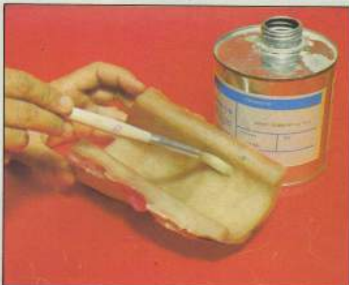
12. Como en el caso anterior, se puede utilizar un producto específico para el desmoldeo. Realizar esta operación con minuciosidad.
