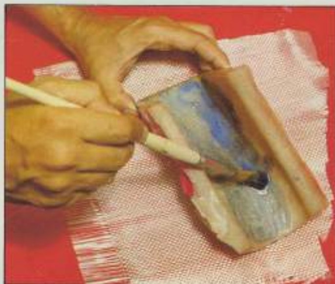
18. Con la brocha y resina, adaptar el trozo de fibra en el interior del molde. Según el número de telas, la pieza será más o menos fuerte.
