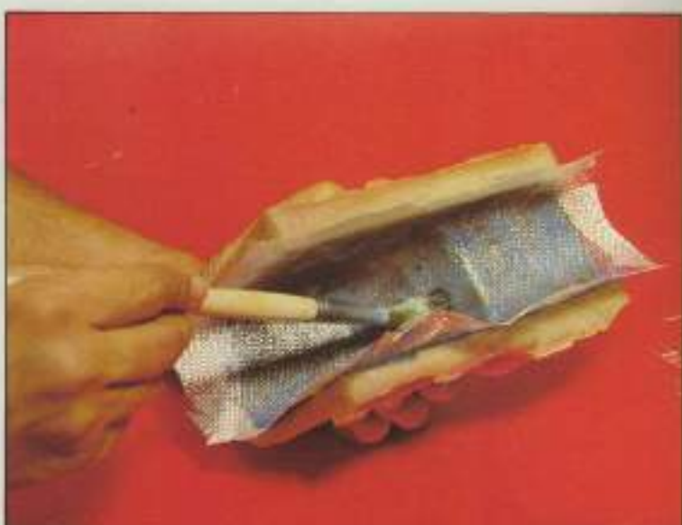
19. En el interior del molde, aplicaremos una capa de resina, sin olvidar el desmoldeante que ya deberá estar seco.
