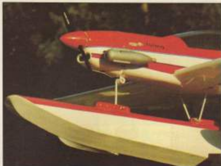
La sujeción de los flotadores debe ser rígida, incluso más que en un tren convencional para tierra.
