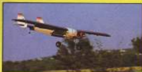
MONSTER: Envergadura: 2.076 mm. Longitud total: 1.310 mm. Peso: 4.800 gr. Motor: 10 cc. Materiales a emplear: Todo madera. Equipo de radio: 4-6 canales. Precio: 1.300 ptas. (suscriptores 1.060 ptas.). Referencia: P-20
