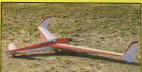
COLIMBO: Envergadura: 2.420 mm. Longitud total: 1.390 mm. Peso: 2.900 gr. Motor: 3,5 cc. Materiales a emplear: Todo madera. Equipo de radio: Tres canales. Precio: 950 ptas. (suscriptores 850 ptas.). Referencia: P-36
