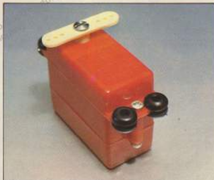
En los puntos de anclaje se utilizan pequeños anillos de goma.
