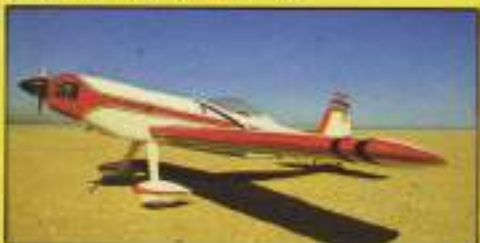
SPINK AKROMASTER: Envergadura: 2.000 mm. Longitud total: 1.900 mm. Peso: 5.500 grs. Motor: 20 cc. a 40 cc. Materiales a emplear: Todo madera. Equipo de radio: Cuatro canales. Precio: 1.200 ptas. (suscriptores 1.050 ptas.). Referencia: P-28
