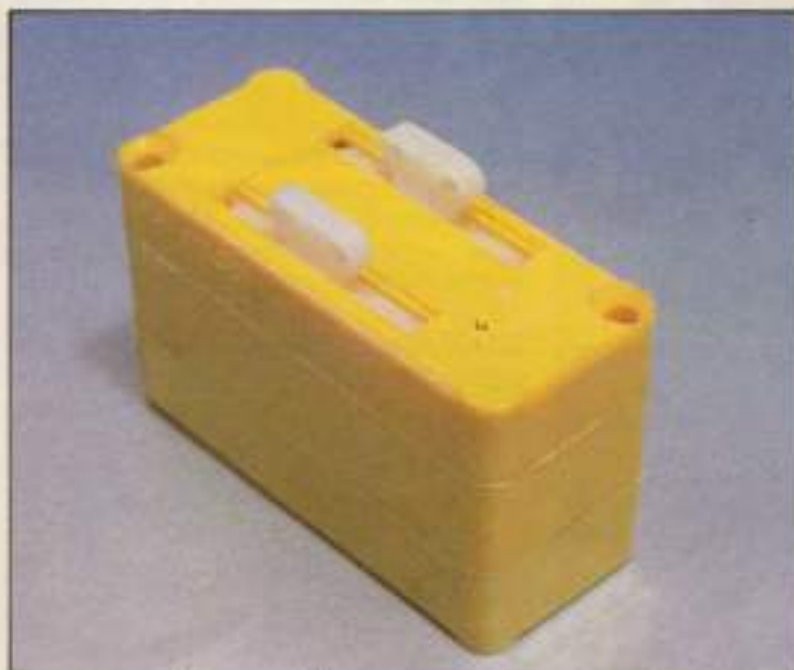
En este servo la transmisión es completamente lineal.
