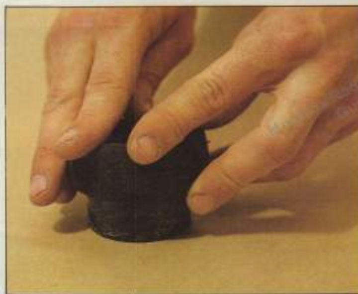
Se moja la llanta con disolvente o gasolina, y se introduce en la goma.
