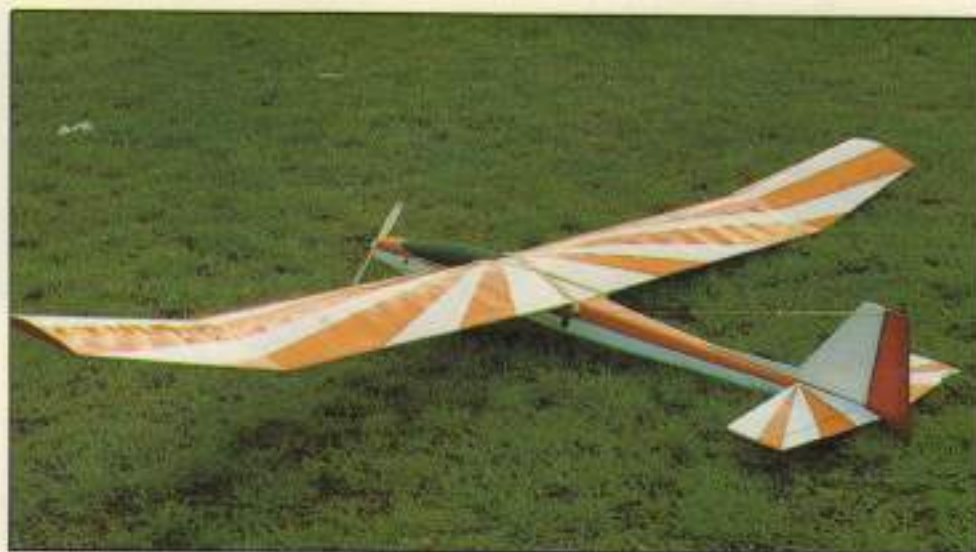
Motovelero de baja carga alar, para un motor eléctrico de potencia media.
