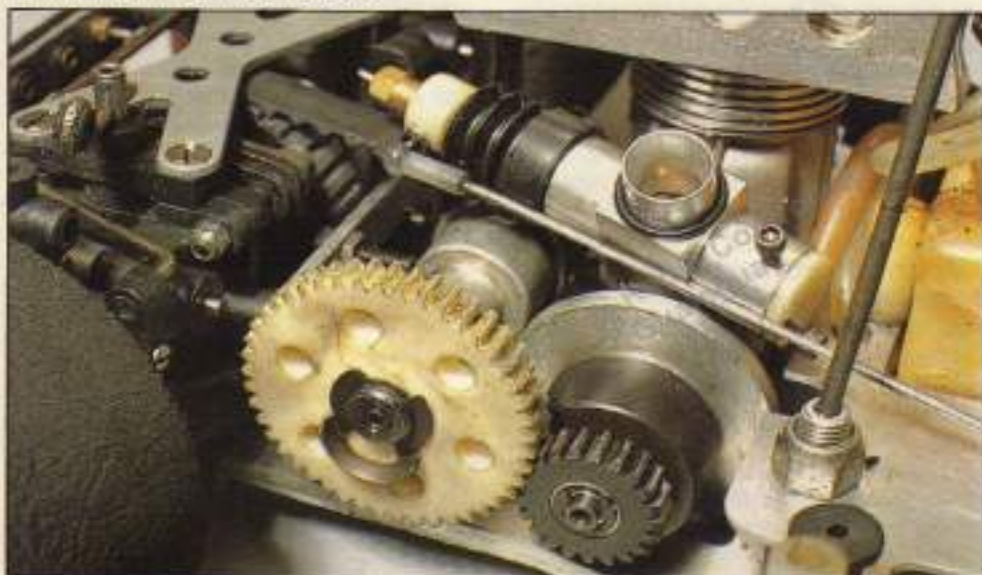
Detalle de una transmisión directa. La corona va unida directamente al diferencial. El distinto tamaño entre corona y piñón es considerable, ya que es la única reducción de la transmisión.
