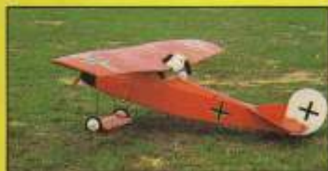
FOKKER DVIII: Envergadura: 1.456 mm. Longitud total: 963 mm. Peso: 2.230 grs. Motor: 3,5. Materiales: Todo-madera. Equipo de radio: Cuatro canales. Precio: 400 ptas. (suscriptores 350 ptas.). Referencia: P-01
