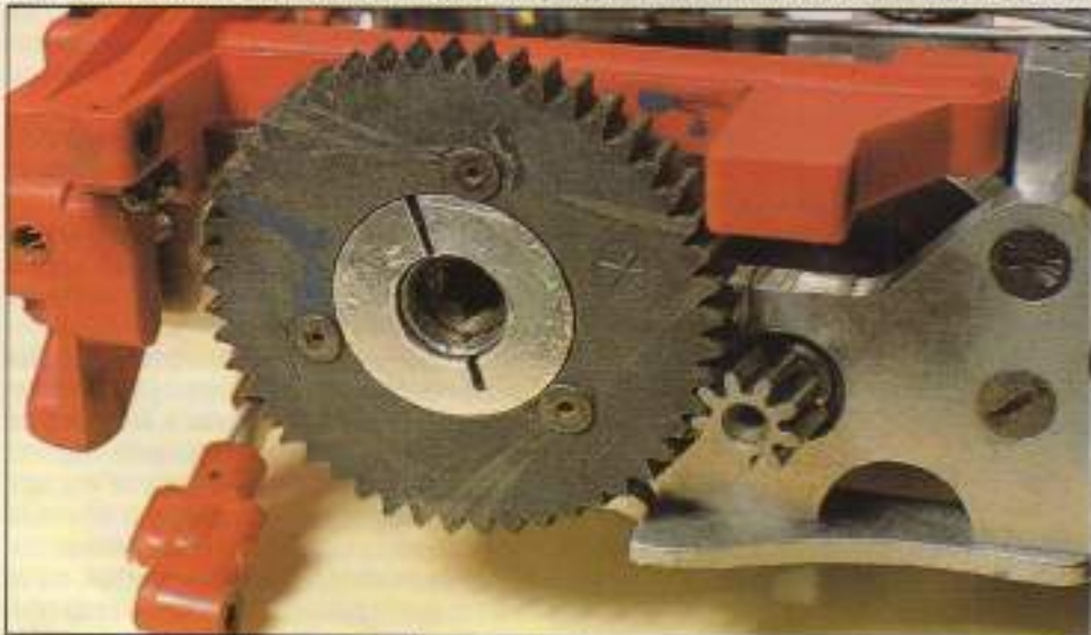
En una transmisión indirecta, la diferencia de piñones en el engranaje primario es pequeña, ya que este sistema tiene una segunda reducción en el engranaje secundario.
