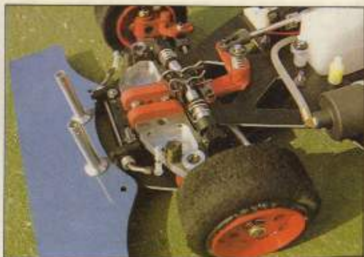
Algunos fabricantes utilizan un solo trapecio en el puente delantero, lo cual modifica la caída del neumático cuando la dirección actúa.
