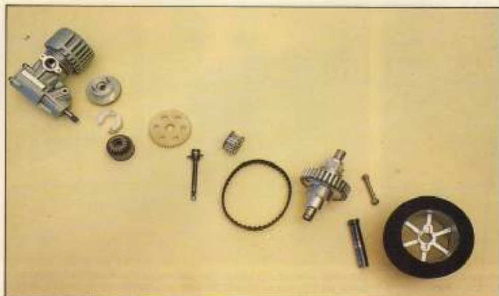
Conjunto de piezas mecánicas que transmiten la potencia del motor hasta las ruedas, en un coche de transmisión indirecta.
