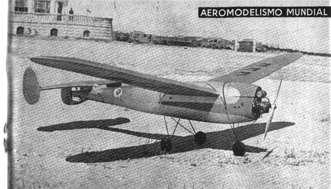
MODELO CUSTON CAVALIER (MODIFICADO) CON OK TWIN CONTROLADO POR RADIO. NOTESE EL "FLAP" COLOCADO EN EL CENTRO DEL ESTABILIZADOR.
