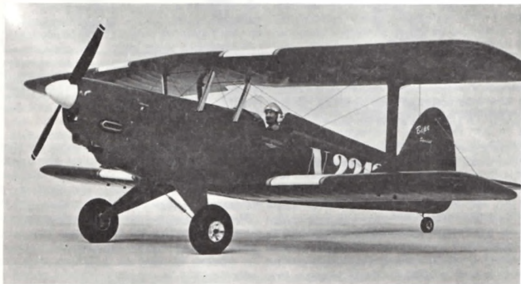
Γιὰ τοὺς ἐμπειροὺς ἀερομοντελιστές, ὑπάρχουν ὁμορφα μοντέλα, ὅπως αὐτὸ τῆς AVIOMODELLI. Εἶναι τὸ διπλάνο «BIPE» πού χρησιμοποιεῖ 8-καναλ. σύστημα τηλεκατεύθυνσης. Ἀκροπτερύγια καὶ ἄτρακτος εἶναι πλαστικά, ἐνῶ οἱ πτέρυγες ἀπὸ μπάλα μὲ ἐπικάλυψη ἀπὸ ναυλον.
