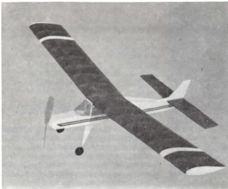
Ένα όμορφο ελαστικοκίνητο αερομοντέλο για τους νέους στον αερομοντελισμό. Είναι της TENKO και ονομάζεται «Cubmaster». Η έλικά του είναι πλαστική, έχει μήκος άτρακτου 46 cm και έκπτεσμά 86 cm.
