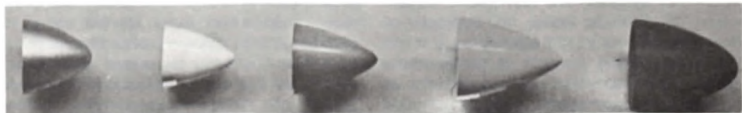
Αυτά είναι τά «σπίνερς». Πρόκειται γιά αεροδυναμικά καλύμματα πού τοποθετούνται εμπρός στην έλικα, εξομαλύνοντας τη ροή του άέρα.
