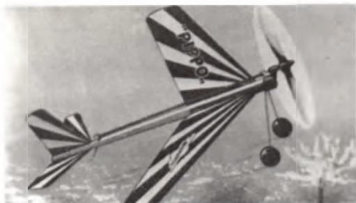
Τό «PIPO» είναι ένα από τα απλούστερα ελαστικοκίνητα αερομοντέλα. Ἡ συστροφή τοῦ λάστιχου γίνεται ἐξωτερικά. Κατασκευαστής «AVIOMONTELLI».
