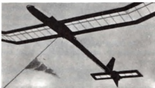
Η σύνδεση του σχαινού, στό άνεμόπτερο. Η σημαϊα δημιουργεί μία άντίσταση στήν κίνηση του σχαινού, παρασύροντάς το πρός τά πίσω, καί κατά συνέπεια, άποσυνδέοντάς το από τόν κρίκο στήν κοιλιά του άνεμόπτερου. Τό μοντέλο τής φωτογραφίας είναι τό "JUNIOR V 2".
