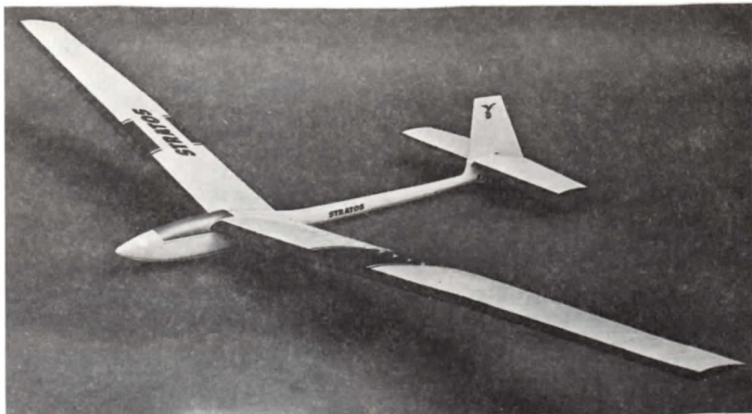
Τό «STRATOS» είναι ένα χαρακτηριστικό τηλεκατευθυνόμενο άνεμόπτερο, με μεγάλη διεδρό στις πτέρυγές του. Είναι από πλαστικό, και πωλείται σέ κιτ.
