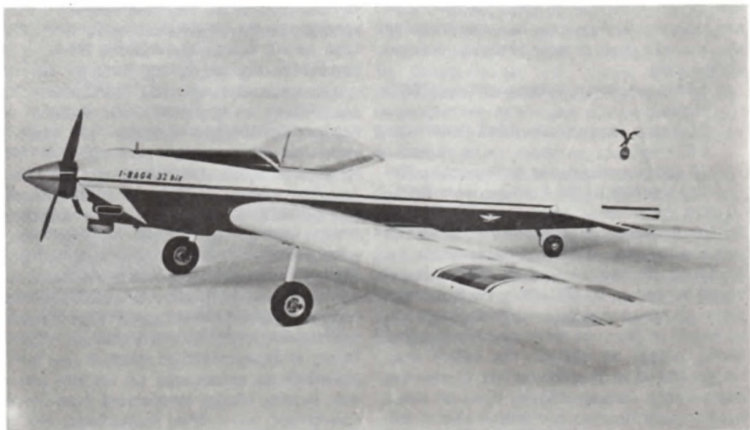
Ένα δέσμιο αερομοντέλο άκροβατικών. Ολόκληρο από πλαστικό, σε kit που συναρμολογείται εύκολα. Ζυγίζει 1250 γραμμάρια, έχει μήκος 105 cm και έκπτεσμά 140 cm. Παίρνει κινητήρα 5-7 cm 3 . Στο άκροπτερύγιο διακρίνονται τα σύρματα που θά ένωθούν μέ τή χειρολαβή. Κατασκευαστής ή AVIOMODELLI, μοντέλο: BAGA 32 BIS.
