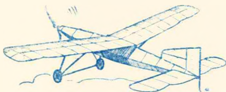
Jeden z prvních trupových modelů, které vznikly v SSSR — hornoplošník z roku 1926. Rozpětí bylo 800 mm a délka 790 mm
