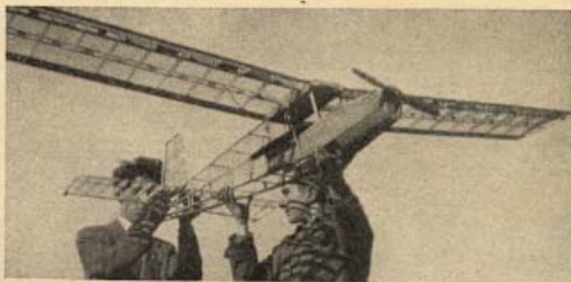
▲ Rádiově řízená jednoplovecová polemaketa Čáp učitele O. Hrubého z Benetova u Prahy. Některá data: Rozpětí 2400 mm, délka 1450 mm, motor IKAR 6,3 cm 3 se žhavicí svíčkou, váha v koutě s motorem 1230 g, předpokládaná celková váha 2400 g, předpokládané spec. zatížení 25–30 g/dm 2 . Ovládací směrovky: vlevo – neutrální – vpravo. Rádiová aparatura ALFA.
