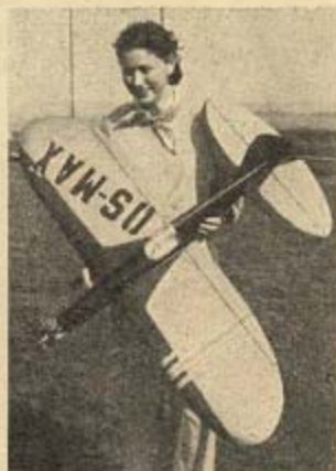
▲ Akrobatický model J. Rybáčka ze Svitav, postavený podle koncepce B. Palmara. Rozpětí 1500 mm, plocha 34 + 7,4 = 41,4 dm 2 , váha v letu 1150 g, motor OS-MAX 5,8 cm 3 , vrtule Tornado 10 × 6". Rychlost modelu 145 km/h na drátech 15,92 m dlouhých, Ø 0,3 mm.
