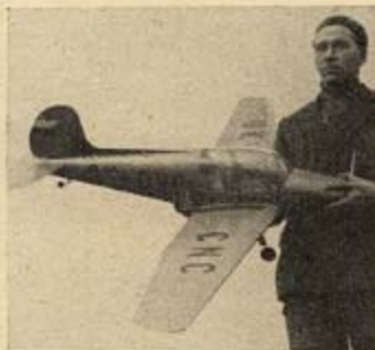
▲ Upoutaná maketa Z-22 Fr. Hudečka z KA Jihlava, postavená v měřítku 1 : 6,7. S motorem Vltavan 5 cm 3 (ovládán třetím lanem) váží model 1,6 kg.
