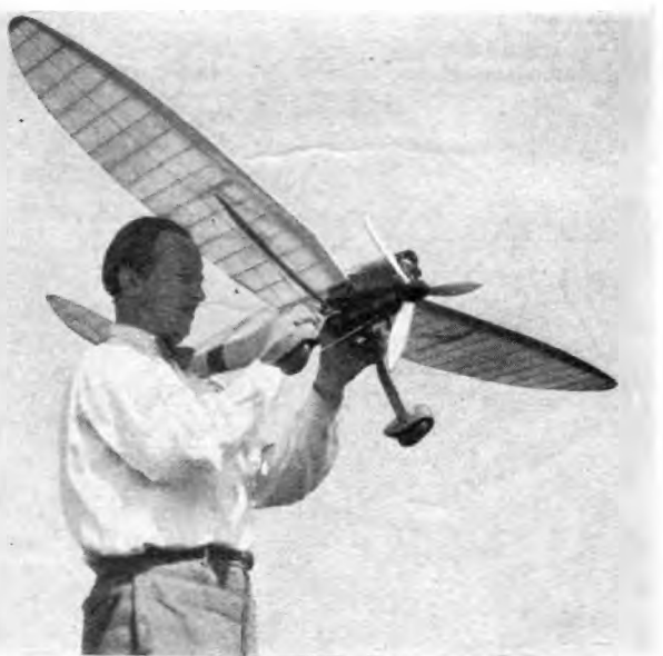
Abb. 1. Das Benzinmotor-Flugmodell H. S. 100. Bilder (5): Gathen
