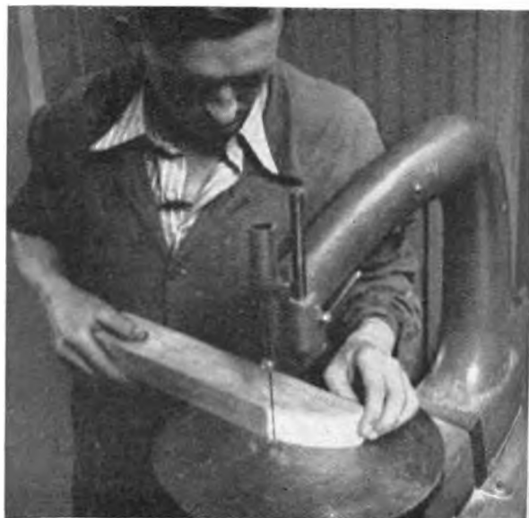
Abb. 3. Ausschneiden mit einer motorischen Dekupierfräse.
