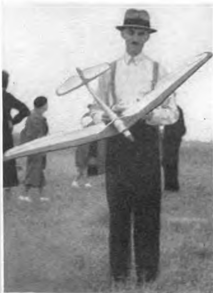
Abb. 1. Segelflugmodell, dessen Tragflügel dem des deutschen Leistungssegelflugzeuges „Minimoa“ von Wolf Hirth nachgebildet sind.
