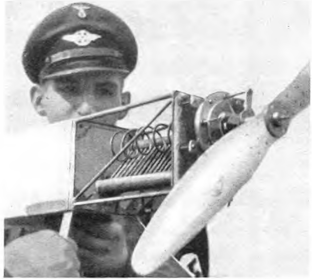
Abb. 12. Dampfturbinenantrieb von Scholl.
