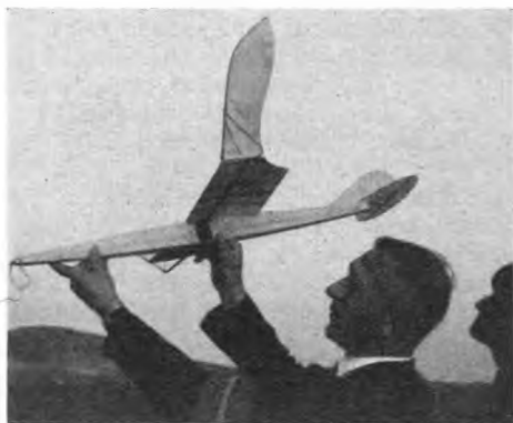
Abb. 4. Seitenansicht des Schwingenflugmodells.
