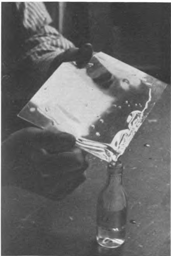
Abb. 2. Abgießen des überflüssigen Lackes
