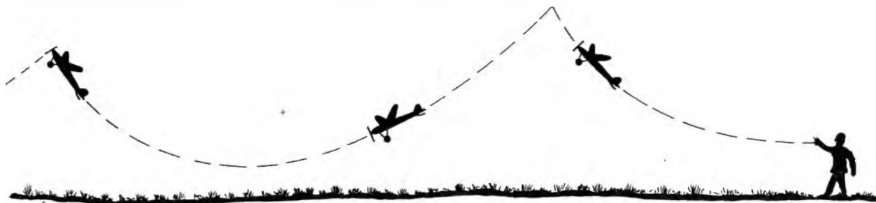
Abb. 2. Nicht längsstabiler Motorflug infolge unrichtig eingestellten Luftschraubenzuges.
