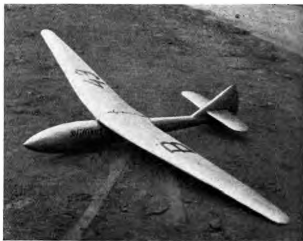
Abb. 16. In Schalenbauweise hergestelltes Segelflugmodell von Julius Große, Spremberg.
