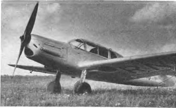
Abb. 2. Das ausgeklappte Fahrwerk des „Tatsun“.
