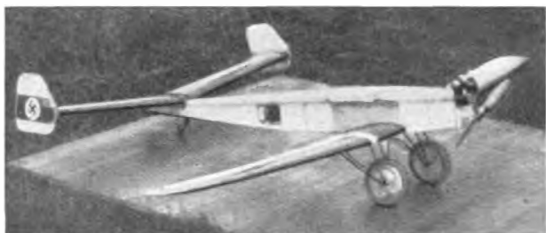
Abb. 7. Flugzeugmodell „Hémiptère“ mit Benzinmotorantrieb.
