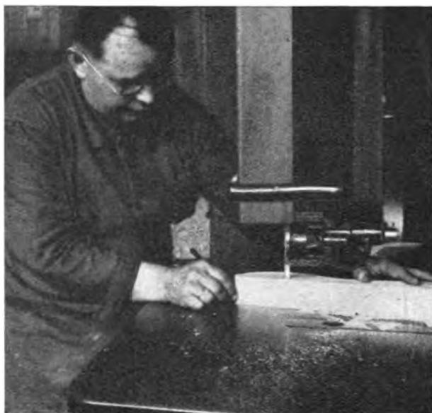
Abb. 4. Ausschneiden mit einer motorischen Bandsäge.
