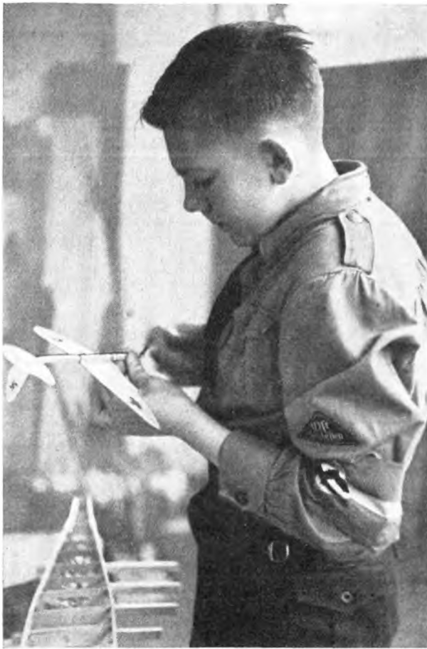
Abb. 2. Handaufzug des Gummimotors beim Zimmerflugmodell „Kolibri“.
