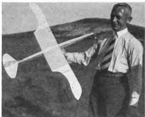
Abb. 3. Draufsicht des Schwingenflugmodells.
