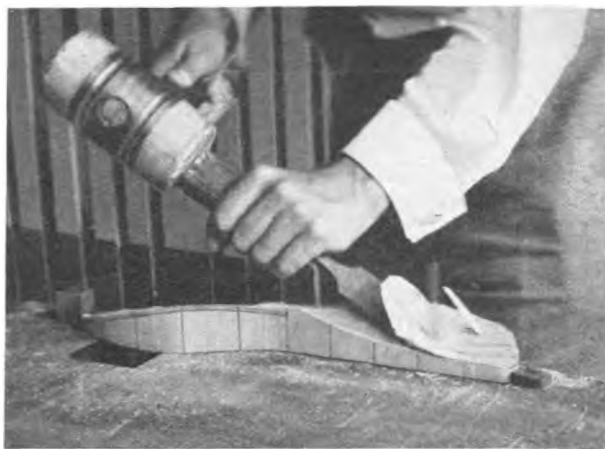
Abb. 12. Abtragen der überstehenden Holzteile.
