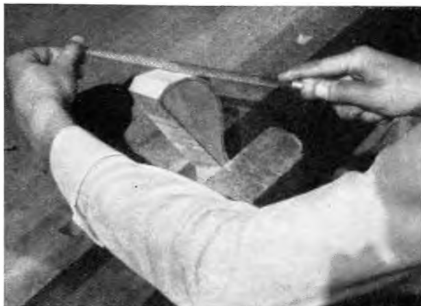
Abb. 7. Befeilen des roh ausgeschnittenen Luftschraubenklößes.
