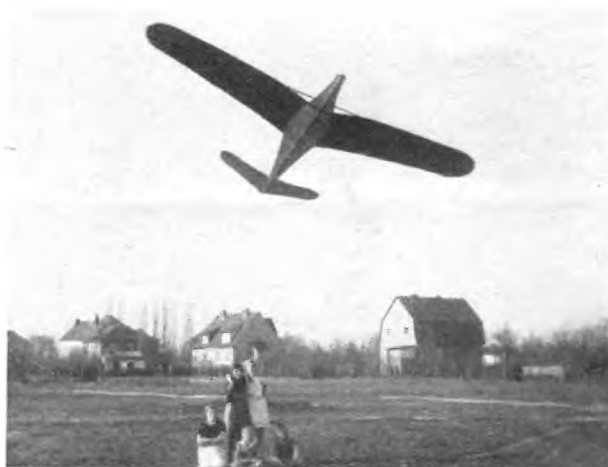
Abb. 7. Drachen in Flugzeugform mit 4 m Spannweite.
