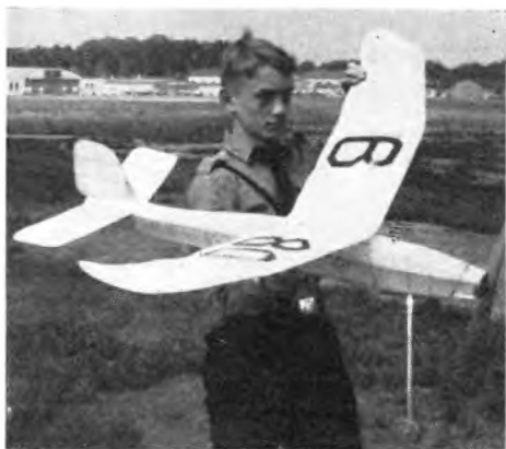
Abb. 18. Gummimotorflugmodell von Emmerich.
