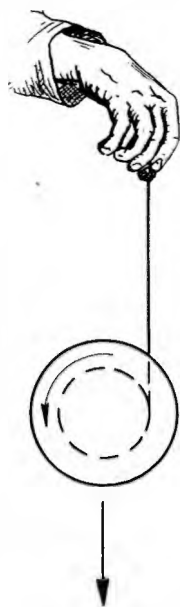
Abb. 7. Der Rotor fällt und wird durch das Band in Umdrehung versetzt.
