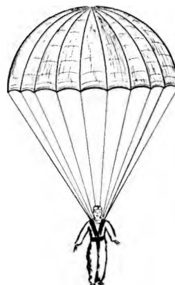
Abb. 5. Der große Luftwiderstand der hohlen Halbkugel beim Fallschirm.
