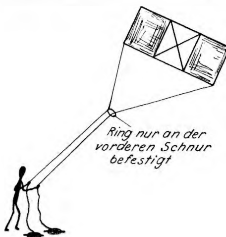
Abb. 3. Aufbau der besonderen Drachenfesselung.
