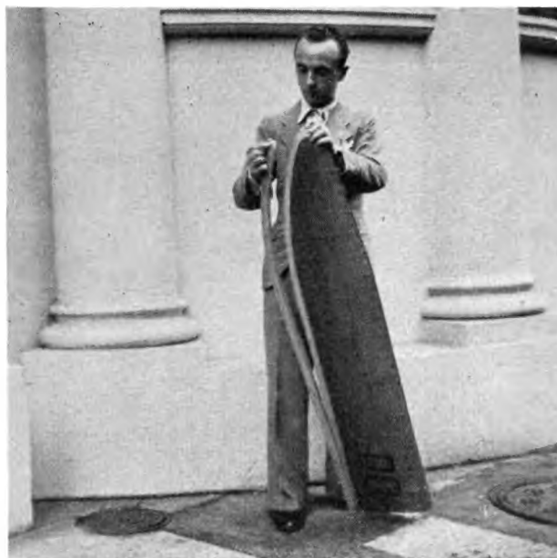
Abb. 9. Beim Transport wird die Flügelendleiste in einer Schiene vor Verzugsfahr geschützt.
