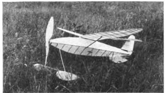
Abb. 1. Flugmodell mit aerodynamisch günstiger Schwimmerform.
