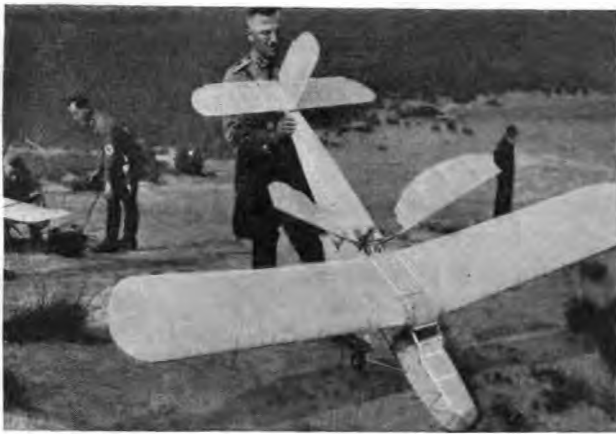
Abb. 5. Schwingenflugmodell der Flugmodellbauschule Rothenburg o. d. T.
