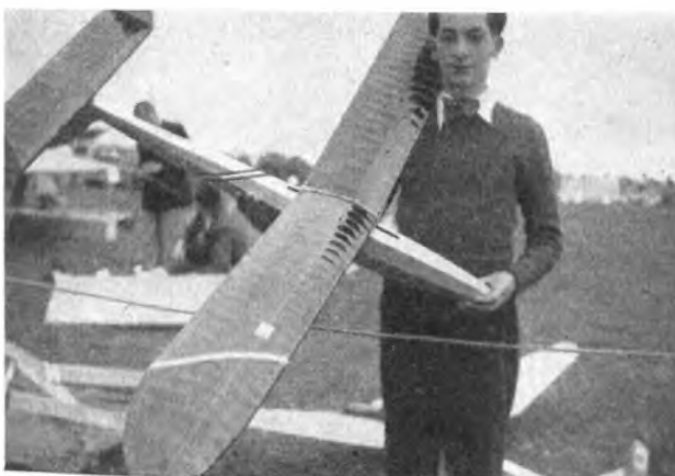
Abb. 13. Das mit Rodophan bespannte Segelflugmodell von Chardard jr., Frankreich.
