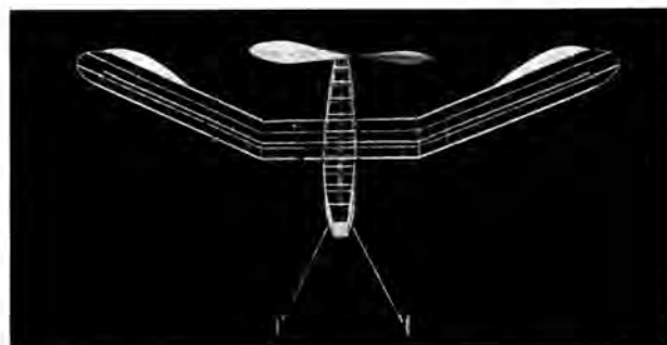
Abb. 7. Motor-Nurflügel in der Ansicht schräg von oben. Selbst die Stahldrahtfedern hinter den Fahrwerksbeinen sind erkennlich
