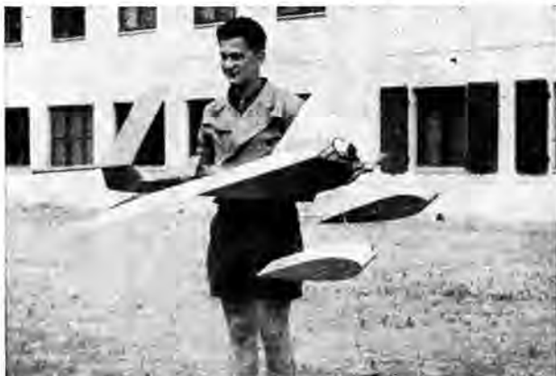
Abb. 1. Das Wasserflugmodell mit Benzinmotor
