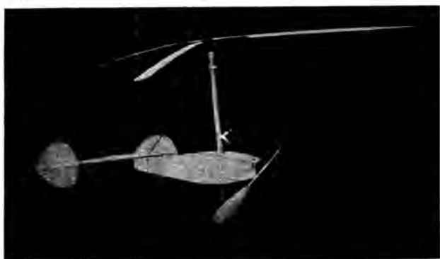
Abb. 4. Flugfähiges Hub- und Tragschrauberflugmodell
