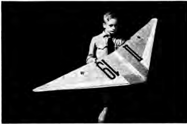
Abb. 4. Nurflügel-Segelflugmodell mit Spaltflügel des Hitlerjungen Thorer, Schondorf/Ammersee
