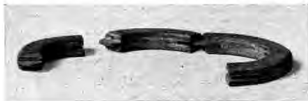
Abb. 4. Der zerlegte Formring
