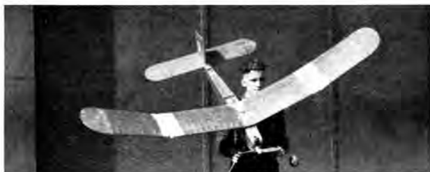
Abb. 9. Benzinmotor-Flugmodell des H.J.-Scharführers Huber, Starnberg, das den 3. Platz belegte. Spannweite 2400 mm, Motor „Kratmo 10“
