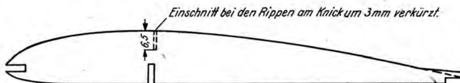
Abb. 4. Der um 3 mm verkürzte Einschnitt bei der Rippe am Flügelknick des „Jungvolk“
