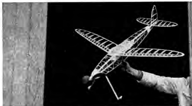
Abb. 6. Rohbau eines Gummimotorflugmodells aus Balsaholz. Gegen den dunklen Hintergrund der offenen Halle ist jedes Einzelteil scharf gezeichnet
