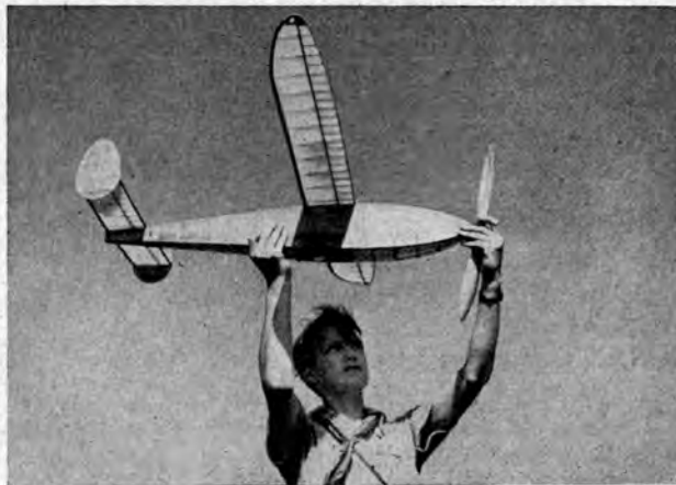
Abb. 2. Flugmodell mit Klappflugschraube und einziehbarem Fahrwerk
