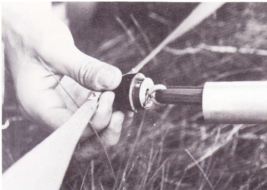
Kim Dong Siks propelmekanisme — et såkaldt »klikke-ti-klank«-system. Navnet kommer af lydene, som systemet frembringer idet propellen stopper.
