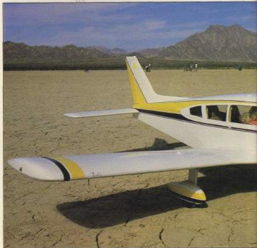
Fiel reproducción de un avión Piper «Cherokee». El modelo pesa 9 kg. y vuela con un motor de 34 cc.
