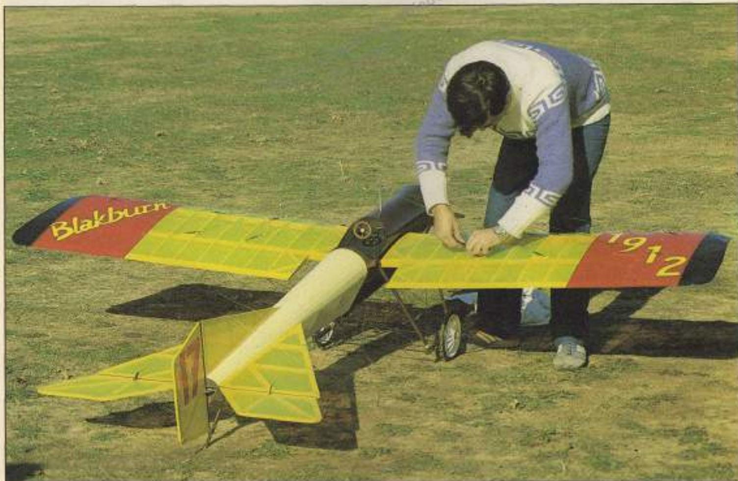
Espectacular aeromodelo que reproduce un avión de época. Está construido totalmente en madera y recubierto con plástico termo-adhesivo. Vuela con un motor de 10 cc. y pesa alrededor de 7 kg.
