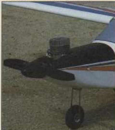
Ejemplo típico de motor instalado en un aeromodelo. En algunos casos va oculto.
