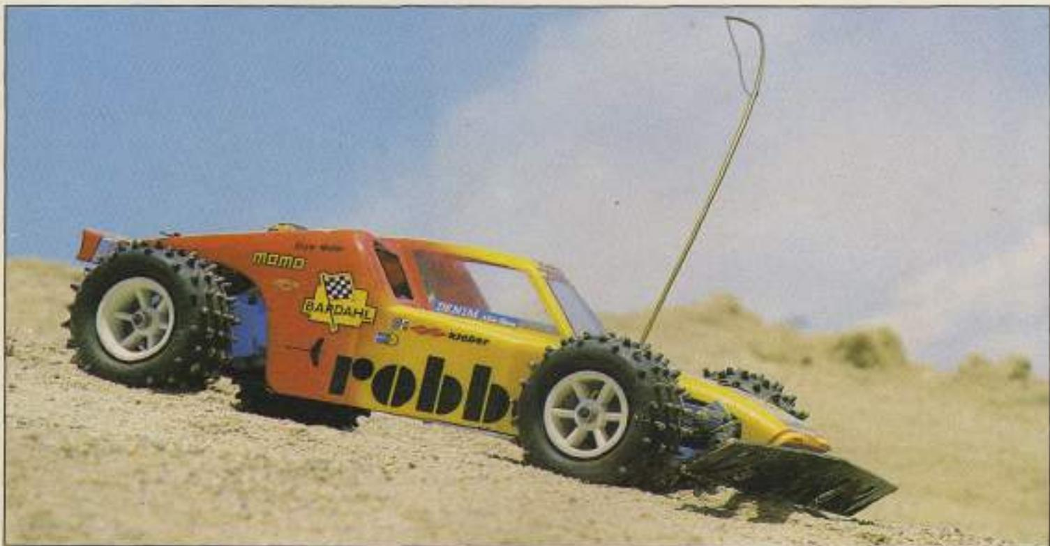
Automodelo radiocontrolado especial para todo-terreno. Utiliza un equipo RC. de dos funciones, una para la dirección y otra para el acelerador y freno conjuntamente. La potencia es suministrada por un motor de explosión de 3,5 cc. Podría también estar equipado con un motor eléctrico.
