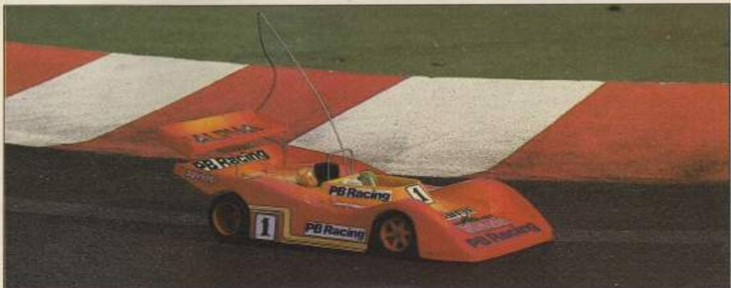
Este modelo especial para competición en pista alcanza velocidades que superan los 100 km/hora. Entre sus componentes se incluye un motor de explosión, embrague centrifugo, suspensión por amortiguadores hidráulicos y freno de disco. Una excelente realización mecánica.
