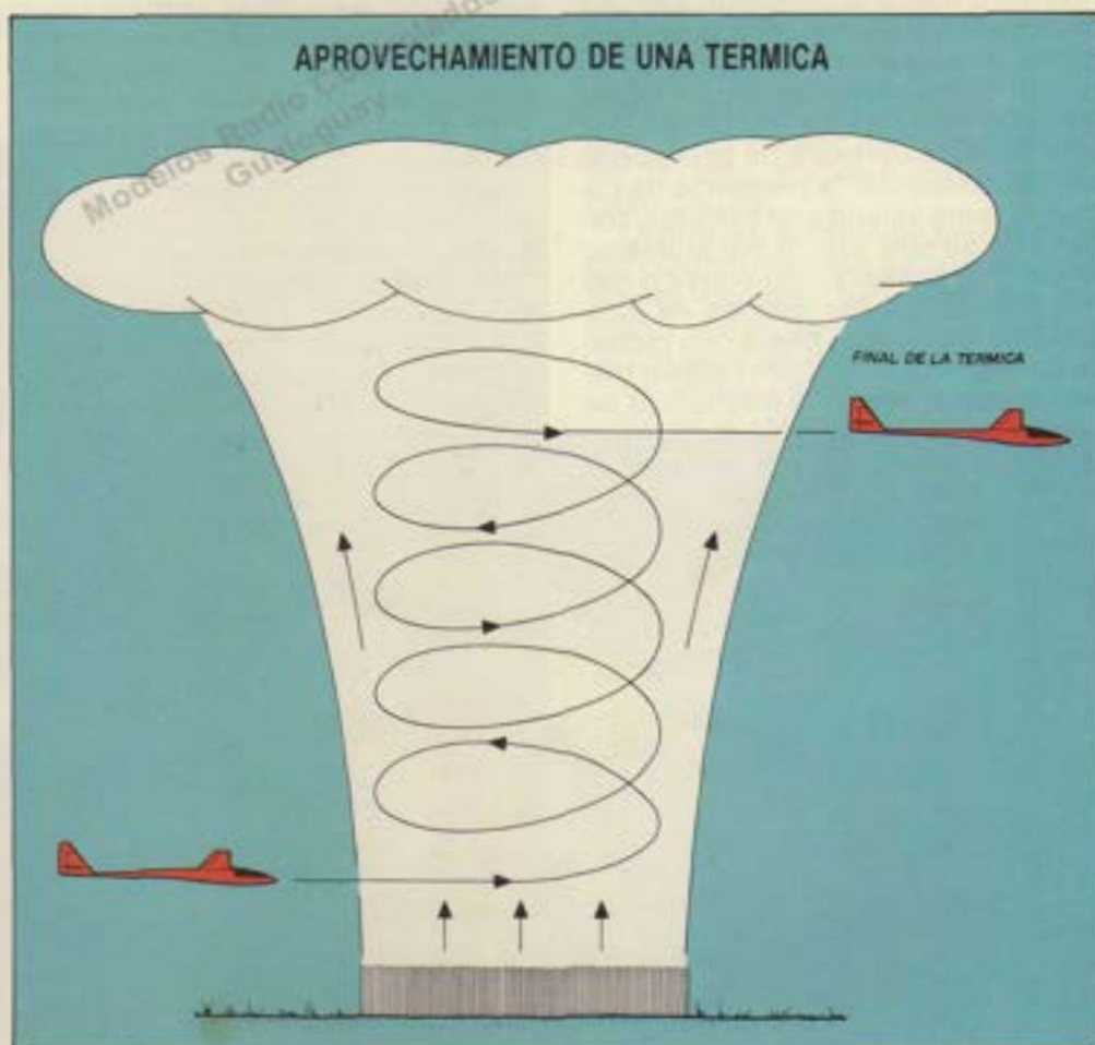
Las térmicas son una especie de columna de aire caliente que asciende. Si el velero realiza círculos dentro de ella subirá hasta igualar la altura de la misma. Después intentará buscar otra térmica y repetir el proceso.
