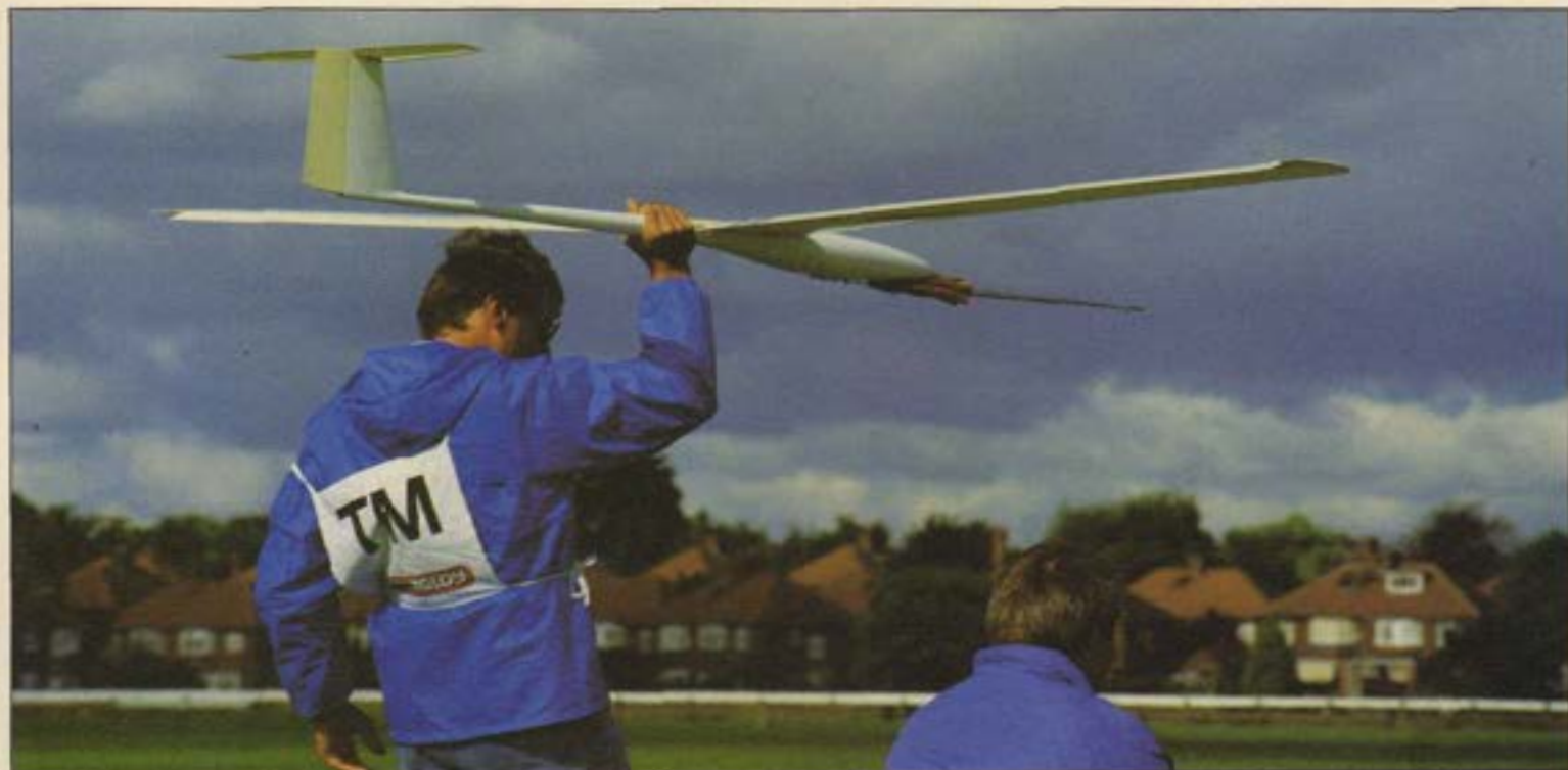
Un colaborador del piloto sujeta el velero hasta que el cable de remolque empiece a tirar. En el extremo del cable, cerca de la anilla de enganche, se ve un pequeño paracaídas que servirá para controlar la bajada del cable, una vez suelto el modelo.
