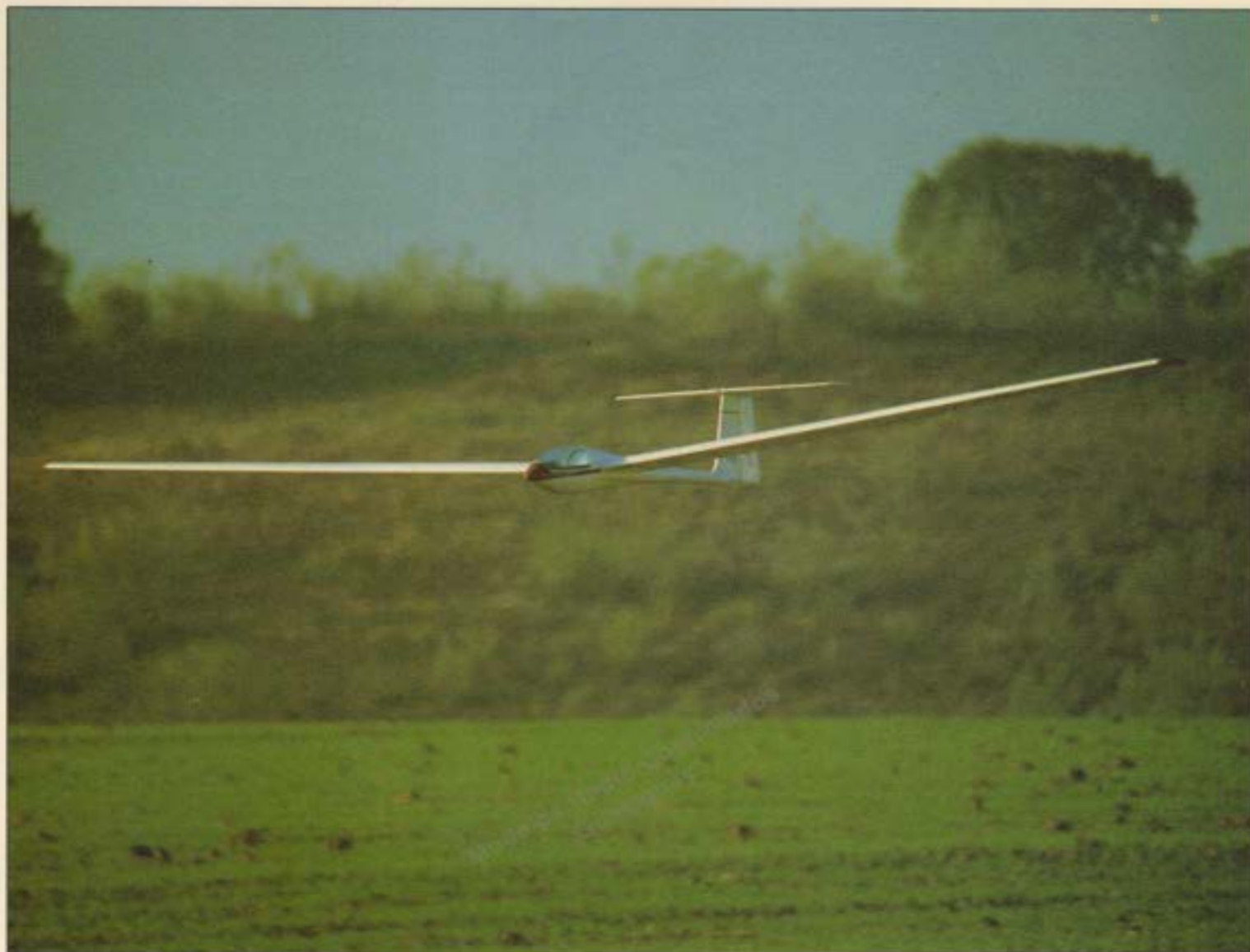
Un velero térmico momentos antes del aterrizaje. Como se puede ver no dispone de tren y a lo sumo puede llevar una pequeña rueda o patín, ya que por la baja velocidad, la toma de tierra se realiza tan suavemente que no precisa elementos de absorción de impactos.
