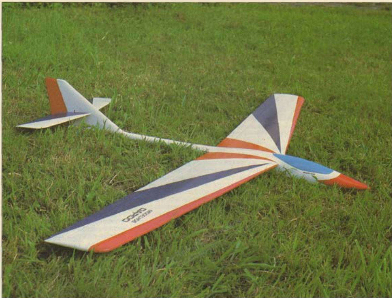
Velero radiocontrolado especialmente diseñado para vuelo en ladera. En estos modelos las alas son algo más cortas y reforzadas, para soportar las maniobras acrobáticas y el fuerte viento con que se vuela a veces en las montañas.
