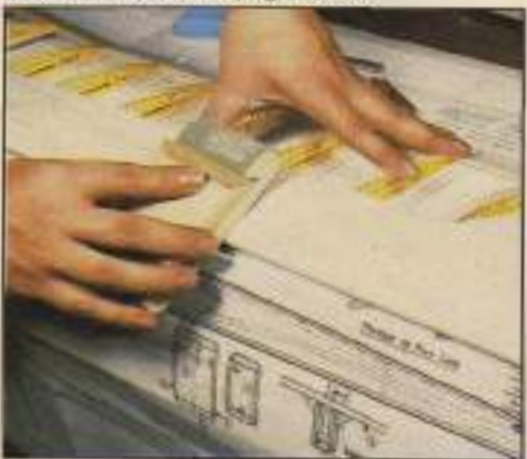
Una vez enchapada la parte superior se da un lijado general para ajustar las uniones.
