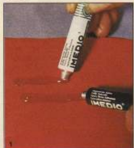
1.ª operación: se extienden los dos componentes a partes iguales, procurando después no invertir los tapones. 2.ª operación: se mezclan insistentemente con ayuda de una pequeña paleta, y está ya listo para aplicar.
