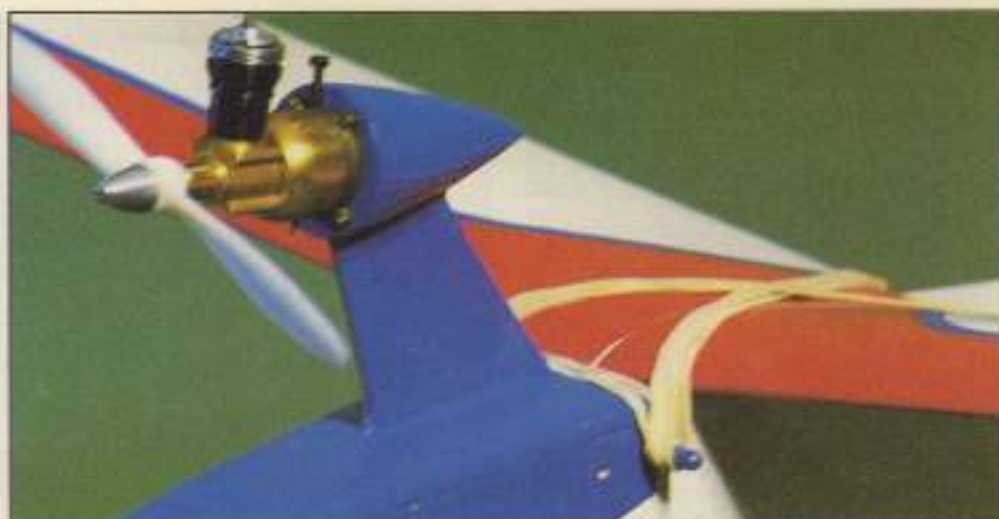
Motor de 0,8 cm 3 con depósito incorporado, instalado en un veiero de 800 gms. de peso.
