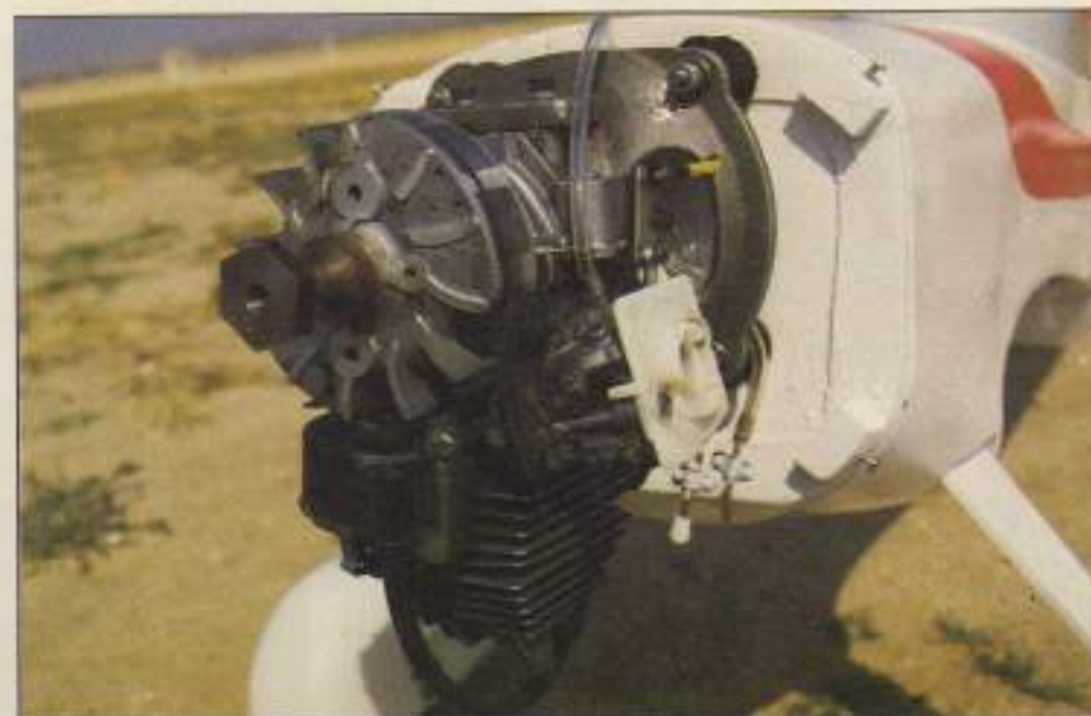
Adaptación de un motor industrial de motosierra para aeromodelismo. Tiene 34 cm 3 y puede hacer volar un avión de 10 kg.
