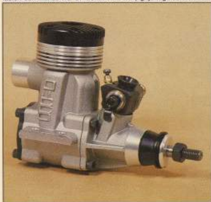
Motor de bujía incandescente (glow), de 2 tiempos y 10 cm 3 . Desarrolla una potencia de 2 HP a 15.000 revoluciones por minuto.
