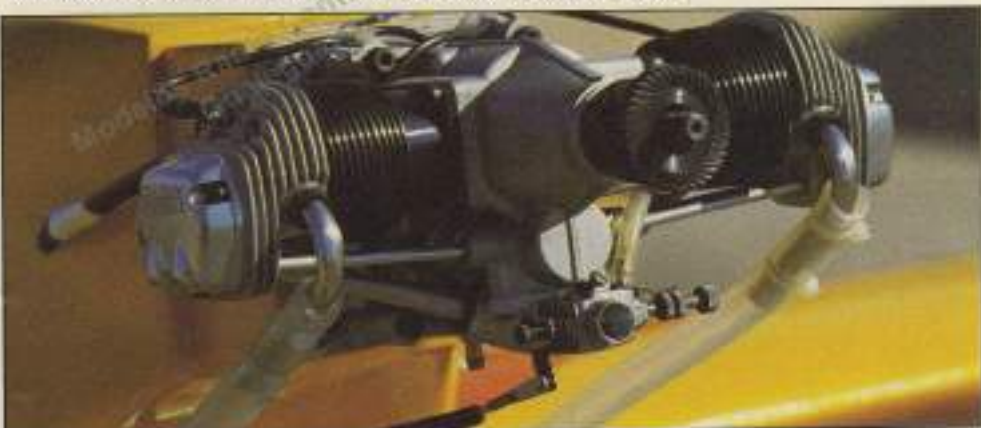
Sofisticado motor de dos cilindros a cuatro tiempos. Gran realismo en su aspecto y funcionamiento, el rendimiento es inferior a igual cilindrada en dos tiempos.
