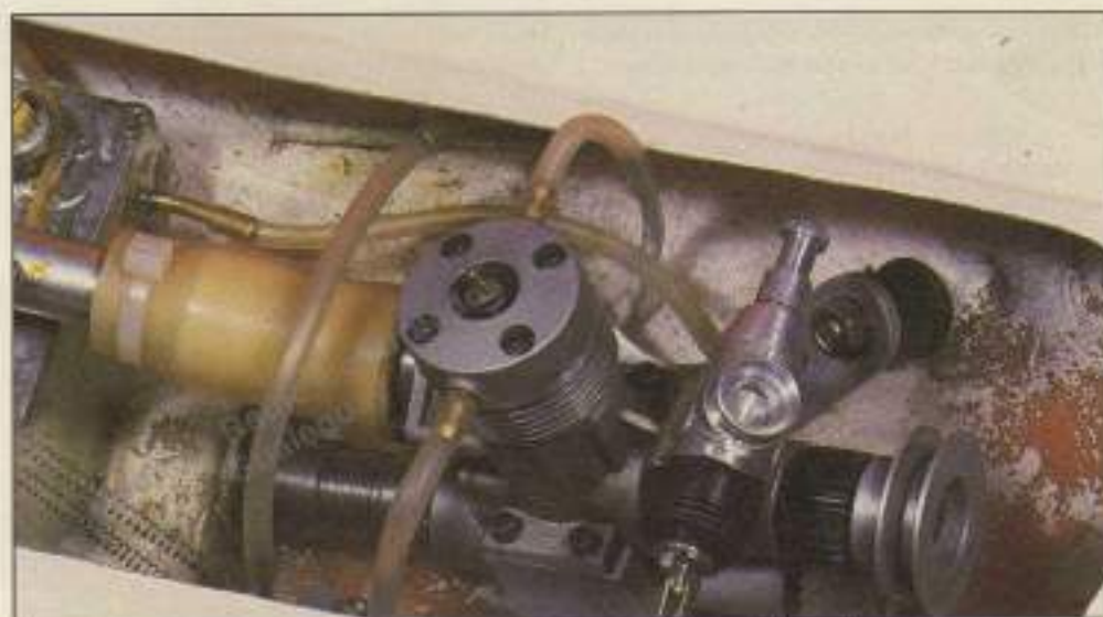
Motor marino instalado en una lancha. La culata dispone de refrigeración por agua.
