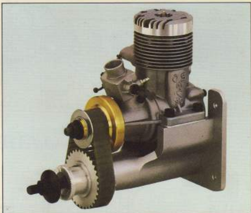
Sistema de reducción por medio de una correa dentada, utilizado para aumentar el rendimiento del motor, esto permite el empleo de hélices de mayor diámetro.
