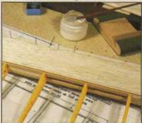
Mediante alfileres se mantiene en su posición hasta el secado del pegamento.
