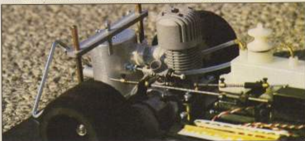
Instalación clásica de un motor en un coche radiocontrolado. Utiliza una cabeza especial para refrigeración, con aletas disipadoras más dimensionadas.
