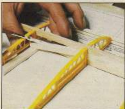
Los tres refuerzos de balsa se pegan con cola blanca entre los dos largueros.
