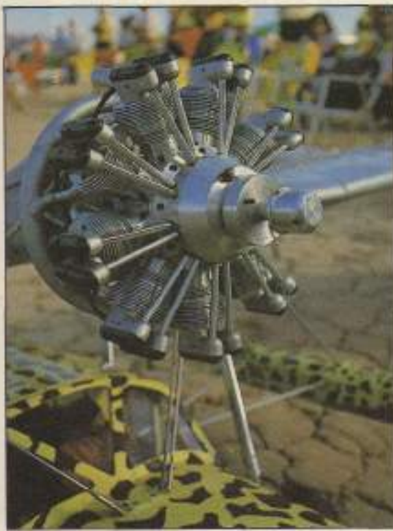
Nueve cilindros en estrella, cuatro tiempos.
